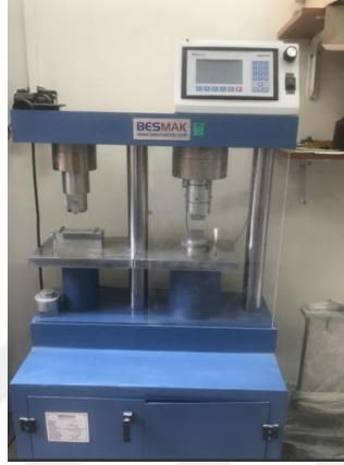
Şekil 8. Besmak Marka 20 Tonluk Çimento Presi
