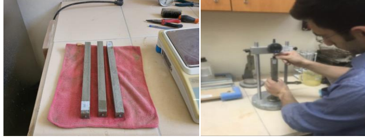
Şekil 13. Rötire deney numuneleri ve rötire deneyi yapılışı
