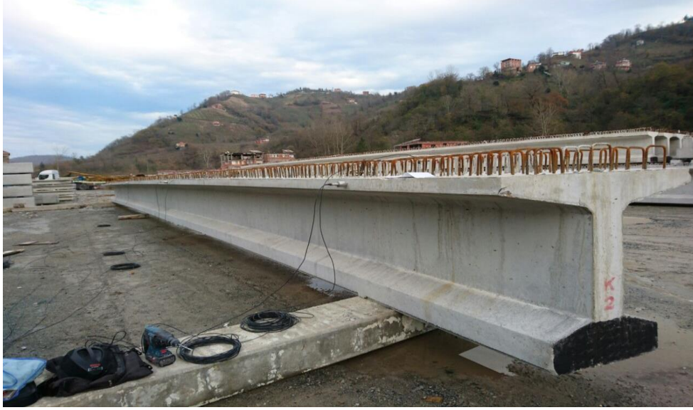
Şekil 2.47. Kirişte gerçekleştirilen çevresel titreşim testi
