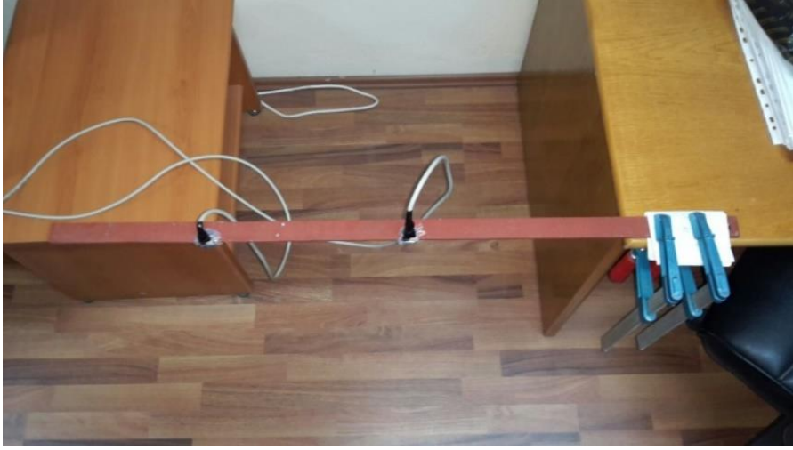
Şekil 2.30. Ölçümü yapılan çelik konsol model ve mesnet bağlantısı
