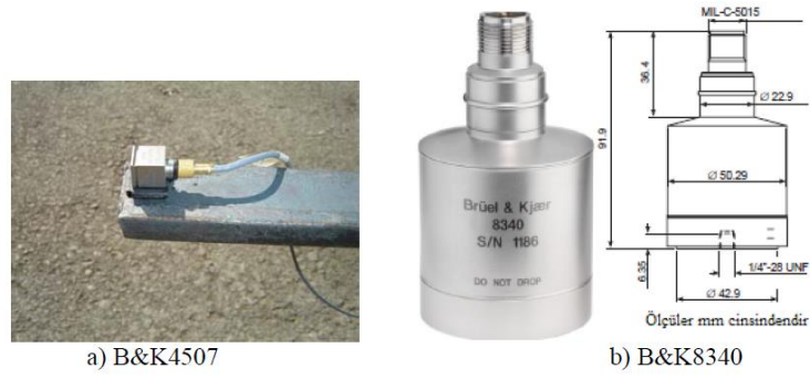
Şekil 1.2. B&K4507 ve B&K8340 tipi tek eksenli ivmeölçerler (Türker, 2011)
