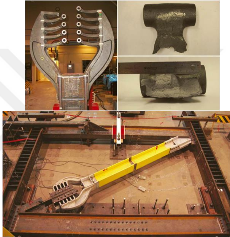
Şekil 1.20. Dökme çelik ile özel olarak üretilmiş metalik sönümleyicili çapraz sistemi (Gray vd., 2014).
