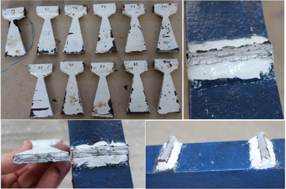
Şekil 3.8. Sönümleyici levhaların göçme durumu
