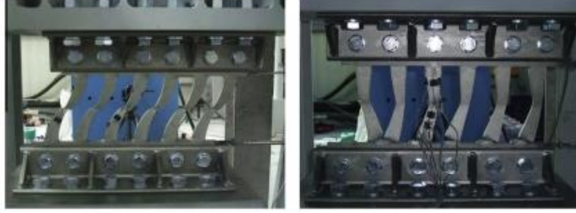
Şekil 1.21. Kum saati tipi şerit sönümleyiciler (Lee vd., 2016).
