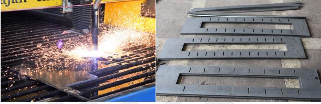
Şekil 2.39. Lazer kesim işlemi ve hazır hale gelmiş bazı parçalar
