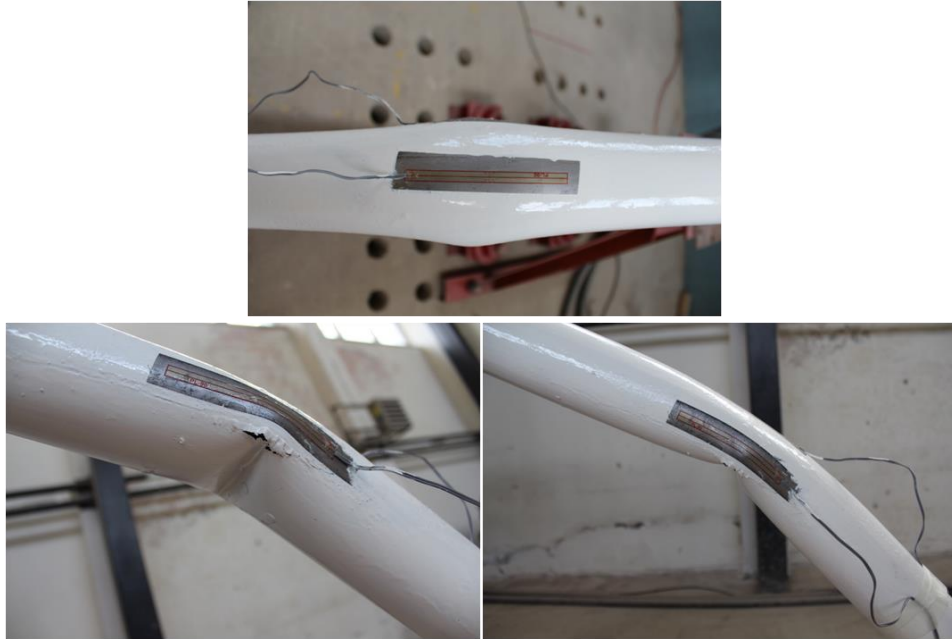
Şekil 3.28. Burkulma bölgesinde meydana gelen hasarlar
