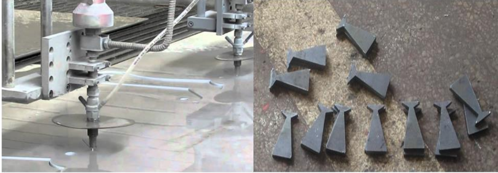
Şekil 2.40. Sönümleyici levhaların su jeti ile kesim işlemi
