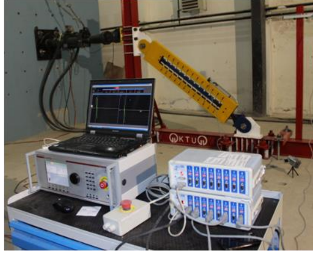
Şekil 2.52. 16 kanallı Coda Ai8b veri toplama cihazı
