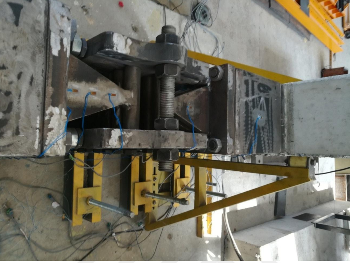
Şekil 2.123. Çelik kulaklar ve çelik kiriş koluna yerleştirilen birim şekildeğiştirme ölçerler
