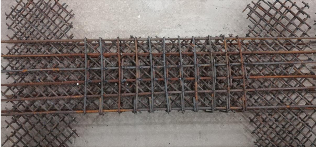
Şekil 2.57. Hasır donatılı (45° açılı) bağ kirişine ait donatı düzenlemesi
