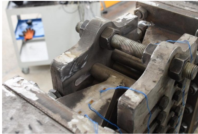
Şekil 2.116. Çelik kulaklara birim şekildeğiştirme ölçerlerin yerleştirilmesi
