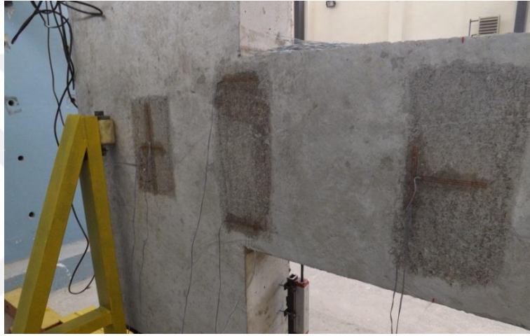
Şekil 2.31. Birim şekil değiştirme ölçerlerin beton yüzeyine yerleştirilmesi
