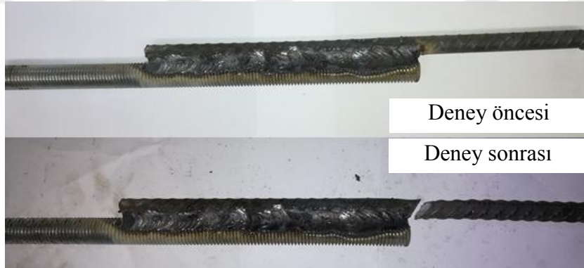
Şekil 2.16. Cıvata birleşimli boyuna donatıların eksenel çekme testi öncesi ve sonrası görünümü
