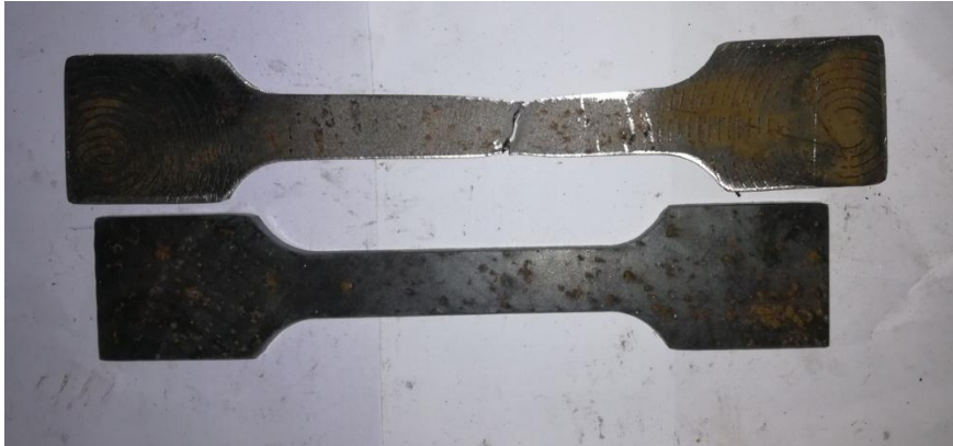
Şekil 2.95. Çekme deneyine tabi tutulan deney kuponunun deney öncesi ve deney sonrası görünümü
