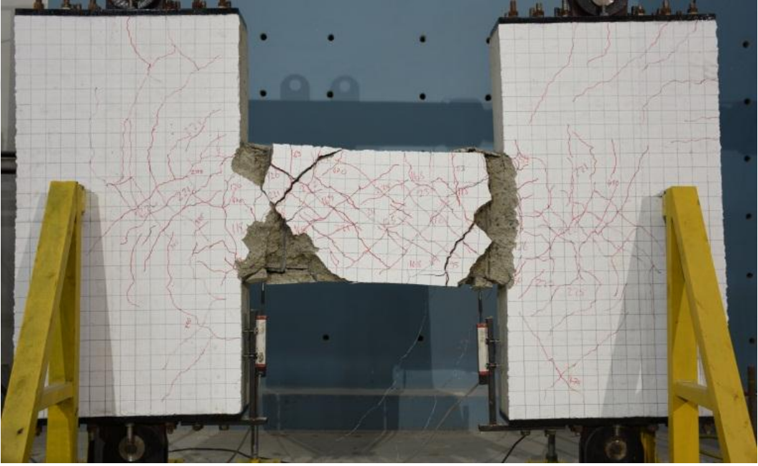
řekil 3.22. Nihai hasar sonrası deney sisteminin grnts
