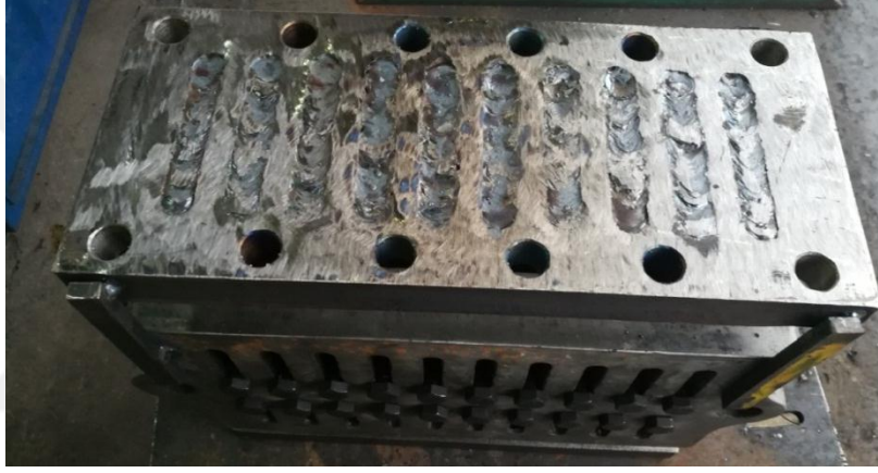
Şekil 2.106. Çelik kulak ve plaka yüzeyi arasındaki boşluğun kaynak ile doldurulması
