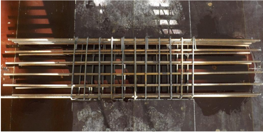
Şekil 2.23. Geleneksel donatılı bağ kirişine ait donatı düzenlemesi
