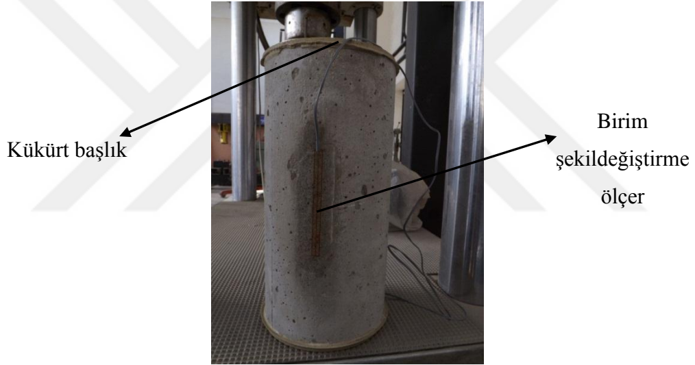
Şekil 2.28. Standart silindir numuneye kükürt başlık yapılması ve şekildeğiştirme ölçer yerleştirilmesi
