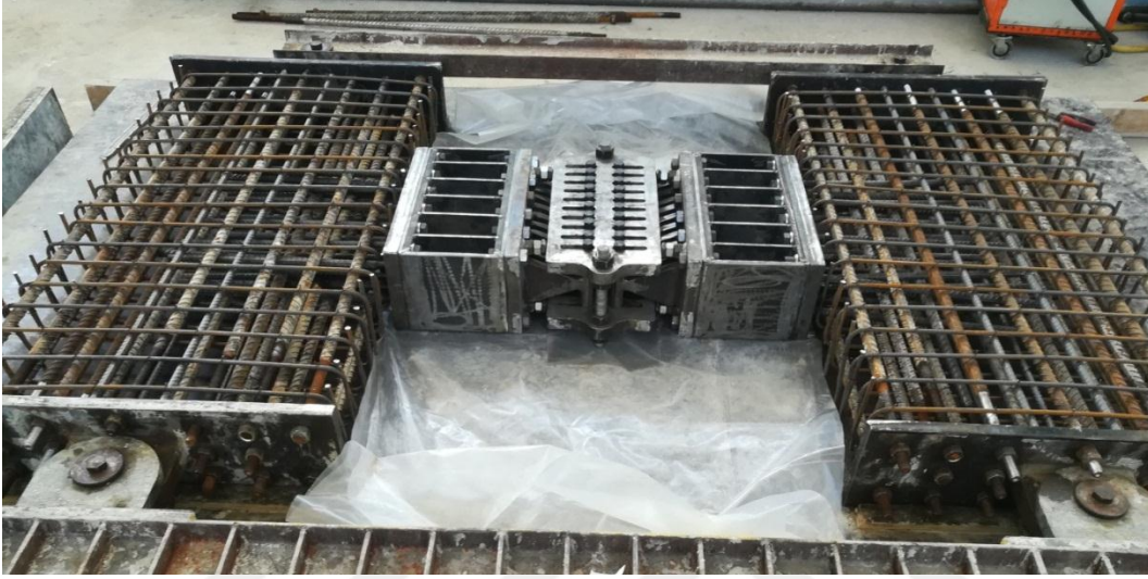
Şekil 2.121. Prefabrik tahterevalli tipi bağ kirişi deney elemanının donatı düzenlemesi
