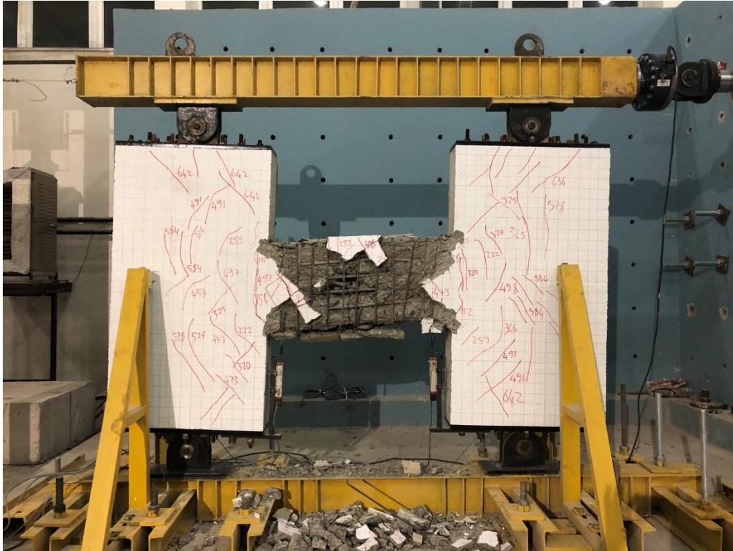
Şekil 3.7. Büyük yerdeğiştirme altındaki deney sisteminin görüntüsü
