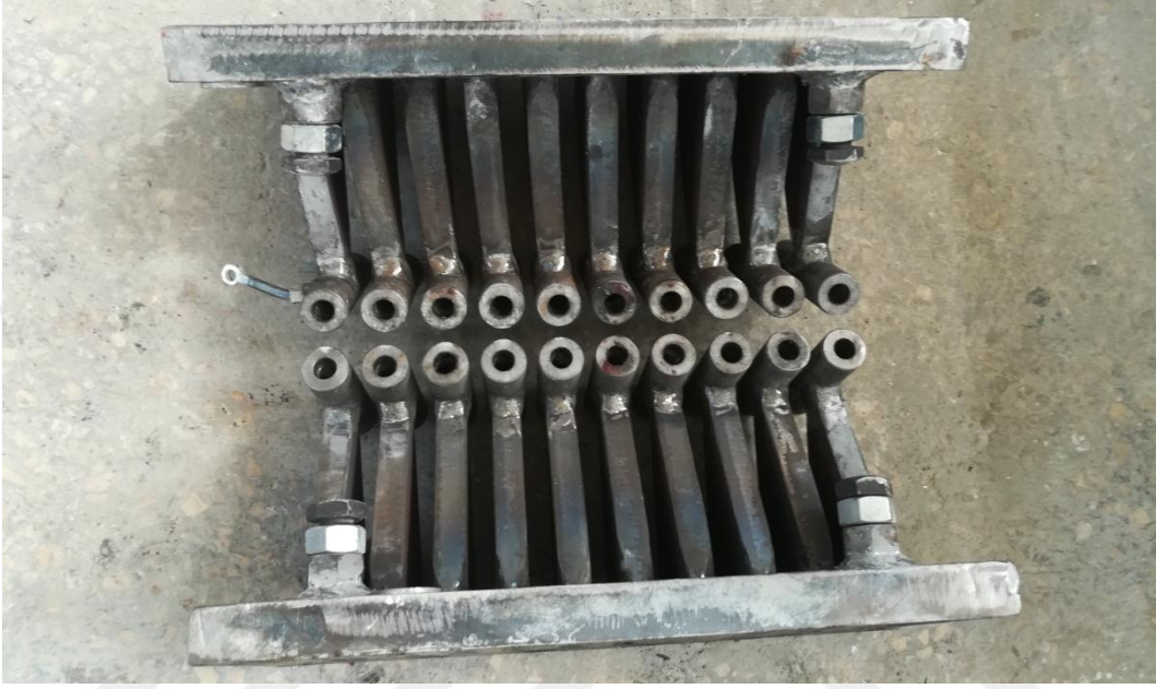
Şekil 3.41. Çelik kulak takımlarının deney sonrası görünümü
