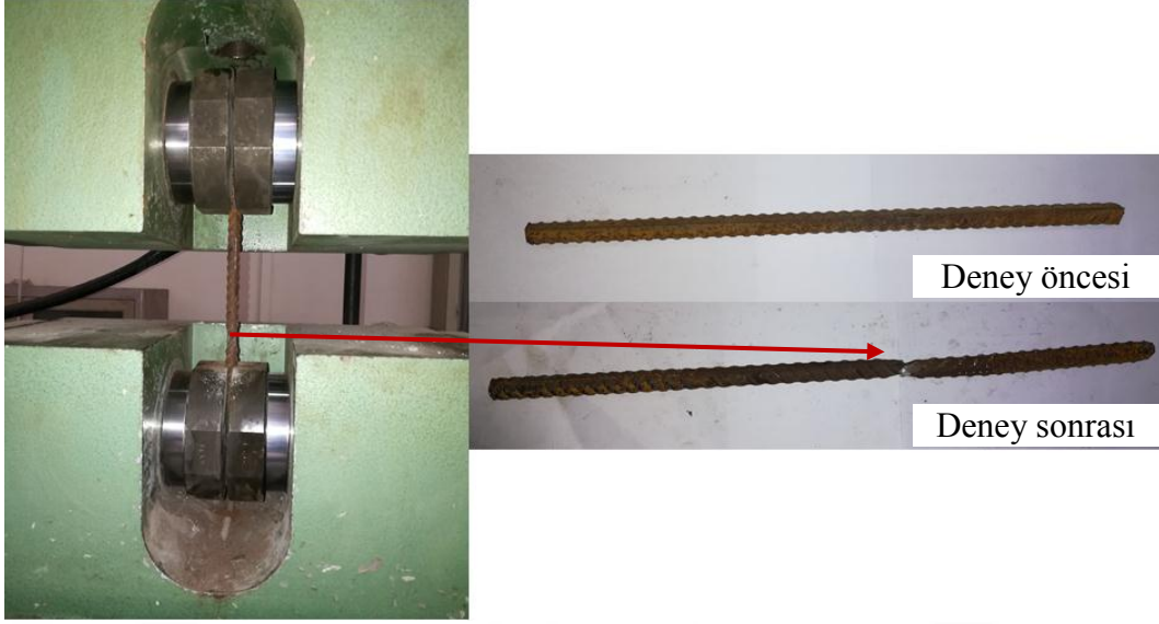
Şekil 2.20. 12 mm çapındaki donatı çeliğinin aksenal çekme testi öncesi ve sonrası görünümü
