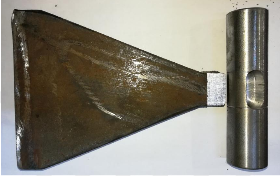
Şekil 2.103. Çelik kulak ve rijit başlığın kaynak öncesi görünümü
