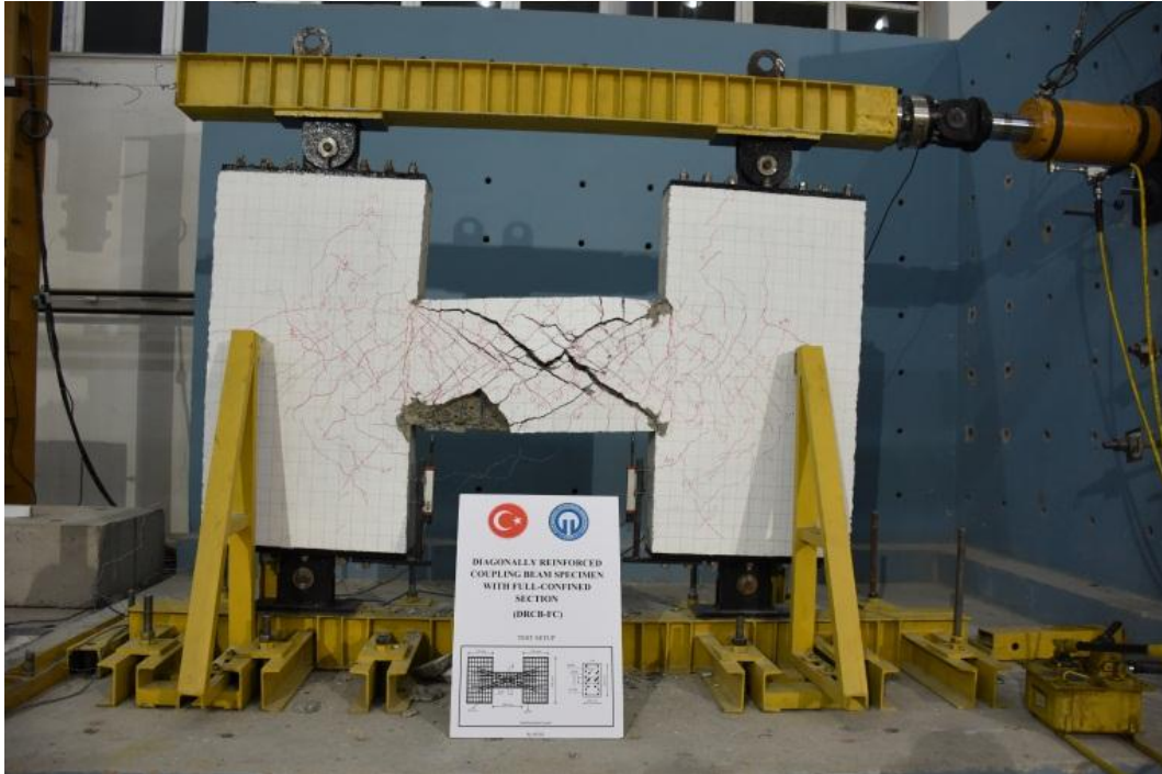
Şekil 3.12. Nihai hasar sonrası deney sisteminin görüntüsü
