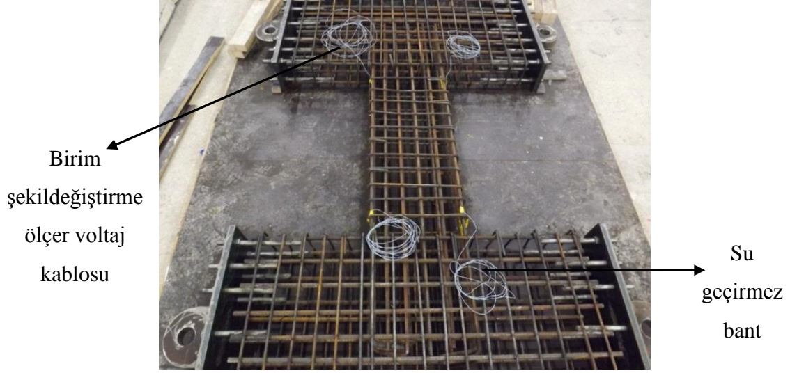
Şekil 2.25. Asal donatılara yerleştirilen birim şekildeğiştirme ölçerlerin su geçirmez bant ile sarılması
