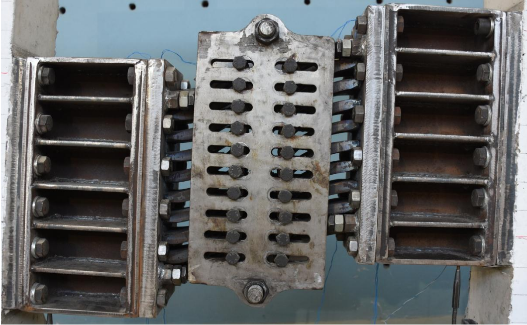
Şekil 3.46. Büyük yerdeğiştirme altında çelik kulakların eğilmiş hali ve PF-TETOD
