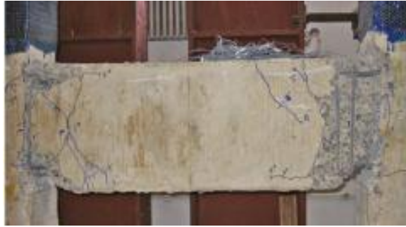
Şekil 1.24. Eğilme/kayma göçmesine maruz bağ kirişi (Brena ve İhtiyar, 2011)
