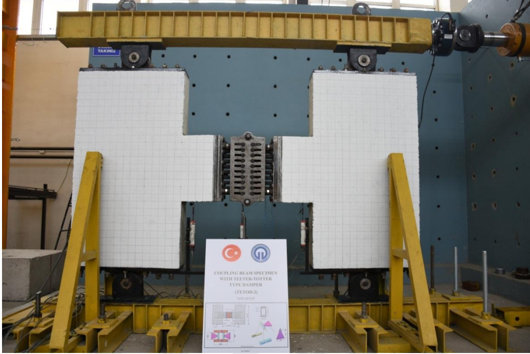
Őekil 2.117. Tahterevalli tipi bađ kiriři deney elemanının ve deney platformunun deney ncesi grnts
