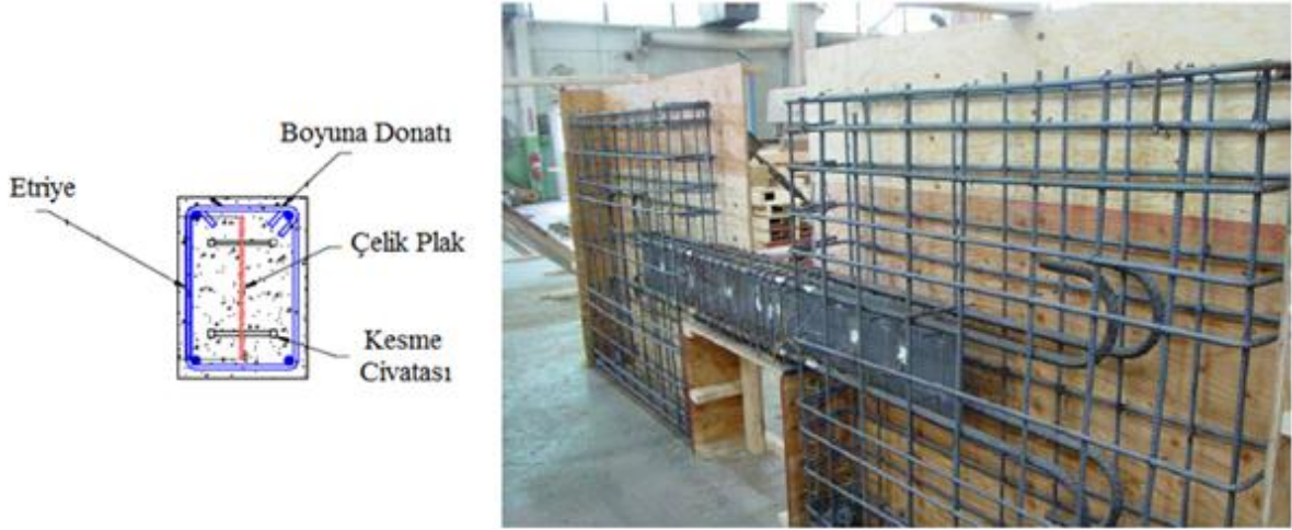
Şekil 1.41. Plakla güçlendirilmiş betonarme bağ kirişi (Fortney, 2005)
