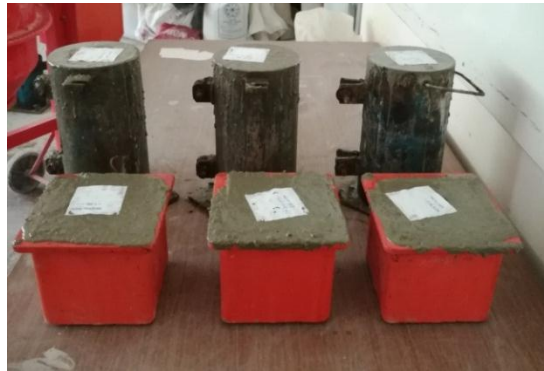
Şekil 2.26. Geleneksel donatılı bağ kirişi deney elemanı beton numuneleri
