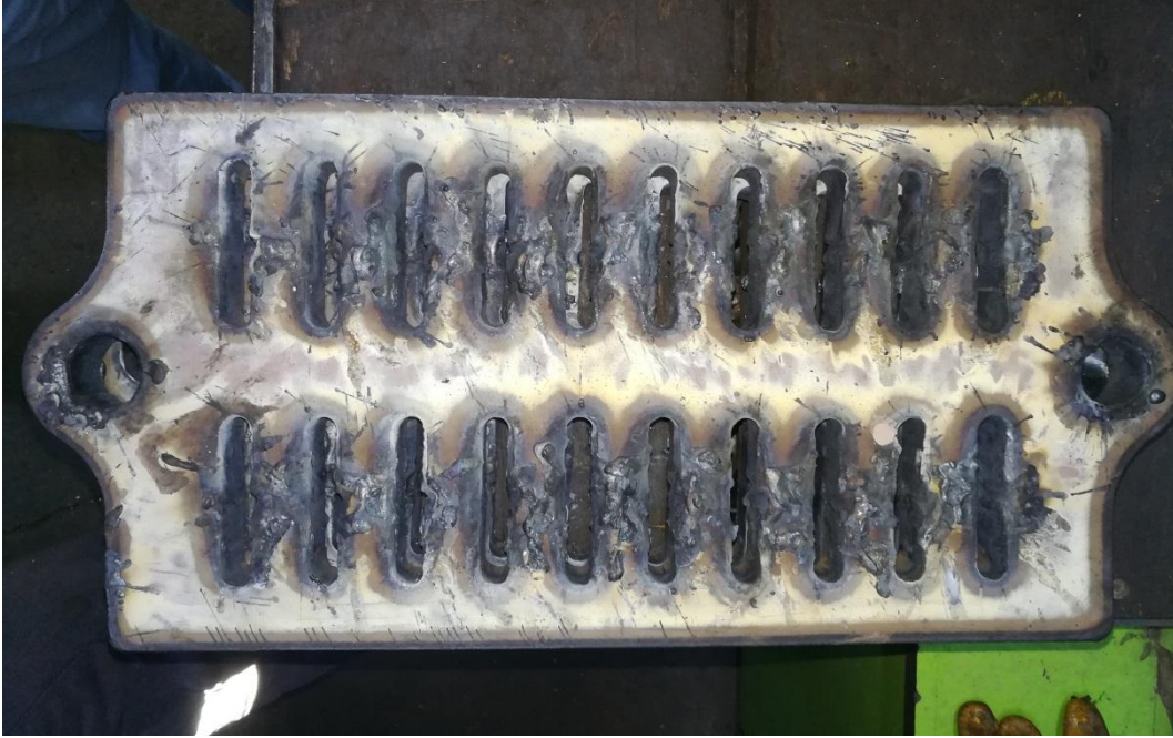
Şekil 2.91. Lazer kesim ile 12 mm genişliğinde oluklar açılan ray plakasının görüntüsü
