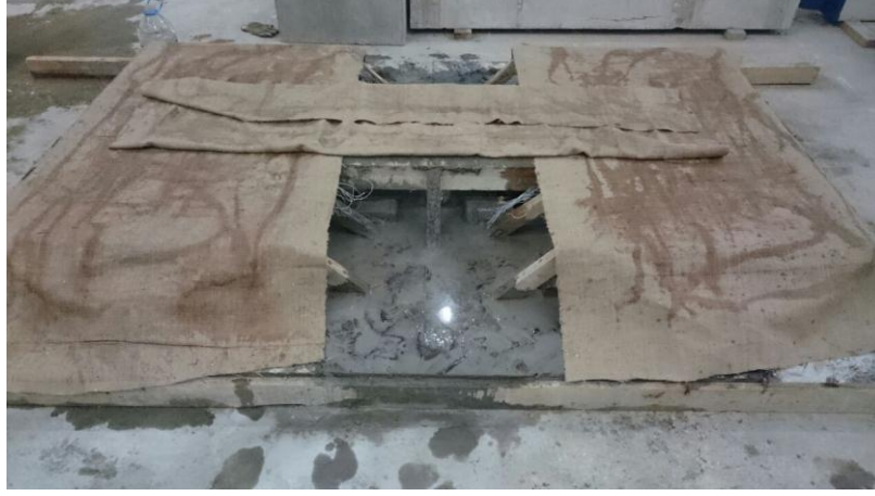
Şekil 2.27. Geleneksel donatılı bağ kirişi deney elemanının telis bezi ile muhafaza edilmesi
