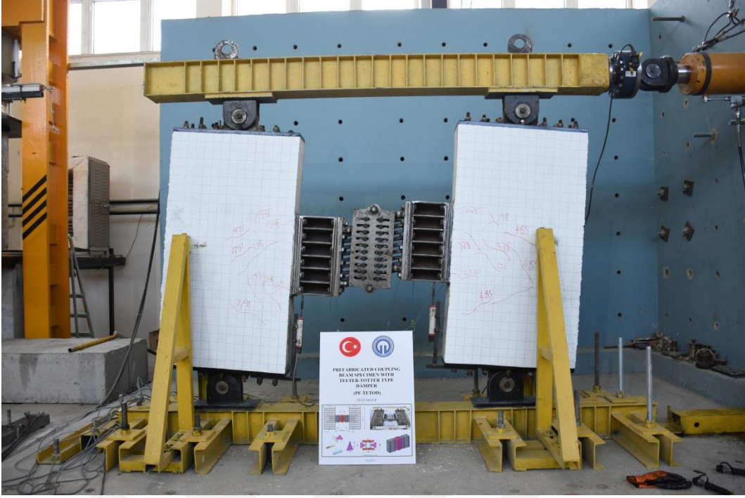
Şekil 3.45. Büyük yerdeğiştirme altındaki deney sisteminin görüntüsü
