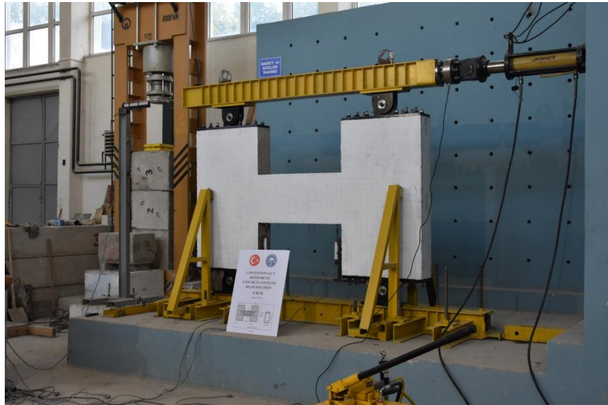
Şekil 2.32. Geleneksel donatılı bağ kirişi deney elemanının ve deney platformunun deney öncesi görüntüsü
