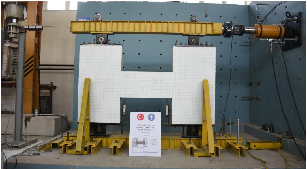
Şekil 2.59. Hasır donatılı ( 45^\circ açılı) bağ kirişi deney elemanının ve deney platformunun deney öncesi görüntüsü
