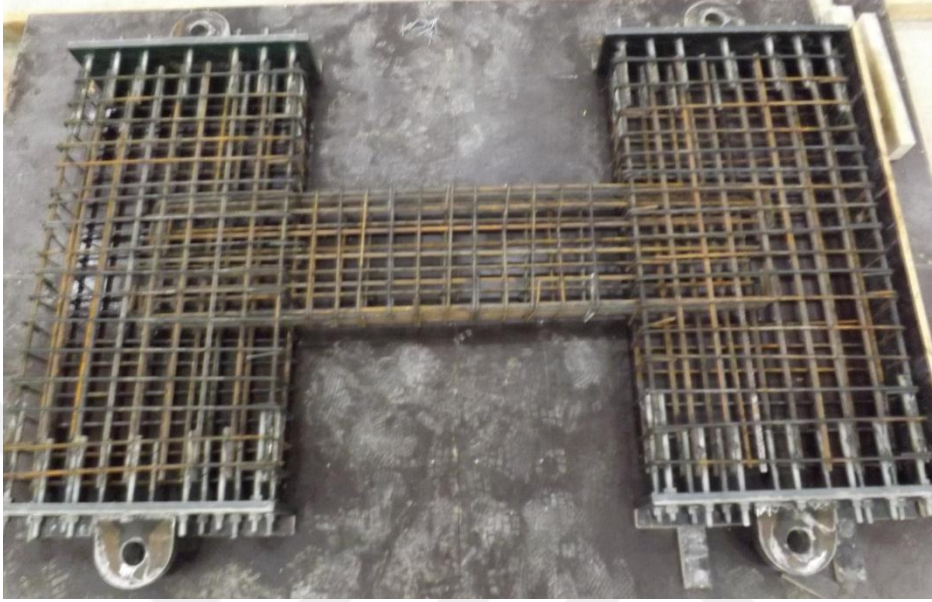
Şekil 2.24. Geleneksel donatılı bağ kirişli deney elemanı donatı düzenlemesi
