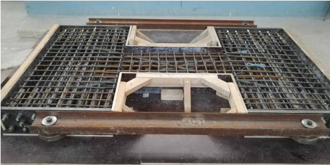
Şekil 2.45. Demet diyagonal donatılı bağ kirişi deney elemanının beton dökümü öncesi son hali
