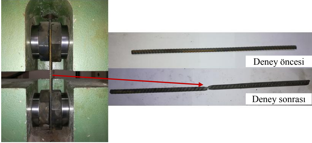
Şekil 2.18. 8 mm çapındaki donatı çeliğinin aksenal çekme testi öncesi ve sonrası görünümü
