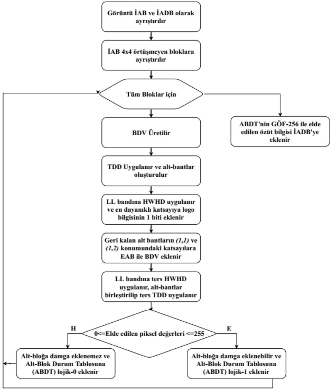
Şekil 2.24. Önerilen damga ekleme algoritması akış şeması
