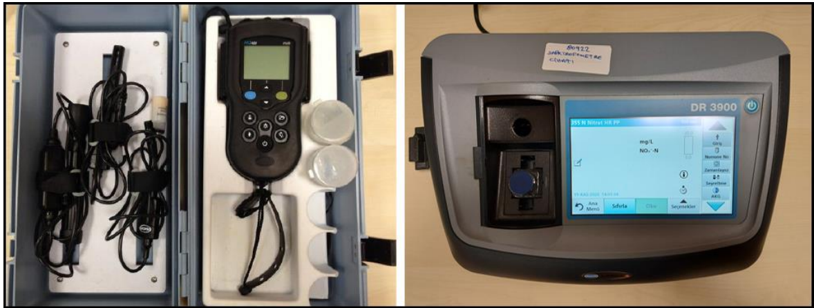
Şekil 10. Yerde ölçümler için kullanılan Hach Lange HQ40D (solda) ve laboratuvardaki analizler için kullanılan Hach Lange DR 3900 spektrofotometre (sağda)
