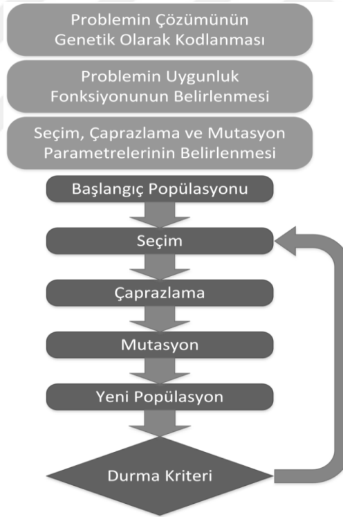
Şekil 1.27. Genetik algoritmanın temel çalışma yapısı
