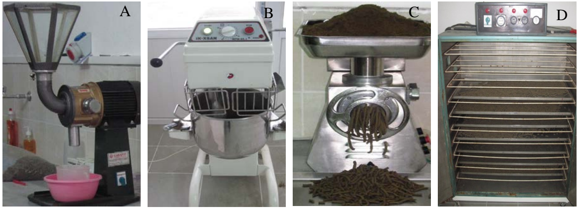
Şekil 4. A) Öğütücü, B) Karıştırıcı, C) Peletleyici, D) Pişirme fırını
