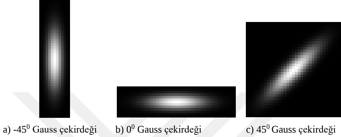
Şekil 18. Farklı ölçeklerde ve farklı yönlerde elde edilen Gauss çekirdekleri ( \sigma_x=1 , \sigma_y=4 )
