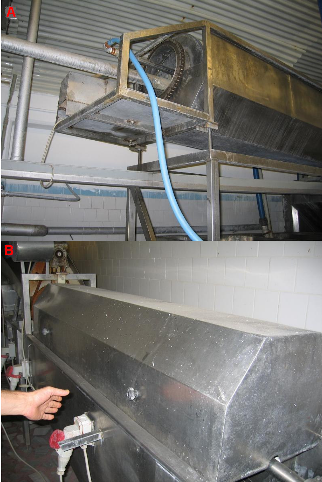
Ek Şekil 5. C. gallina işleme bandı; Kabuk ayırma (A) ve Soğutma (B) (Dalgıç vd. 2005b).
