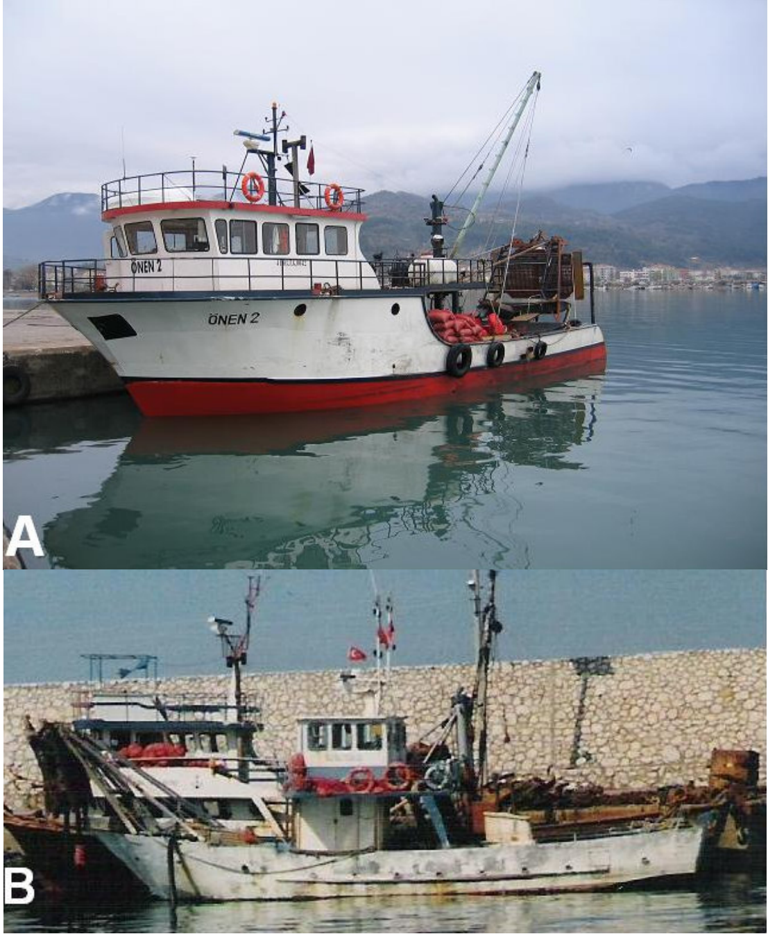
Ek Şekil 3. Hidrolik direcin tekne üzerindeki pozisyonu. A: Tekne önünde B: Tekne arkasında
