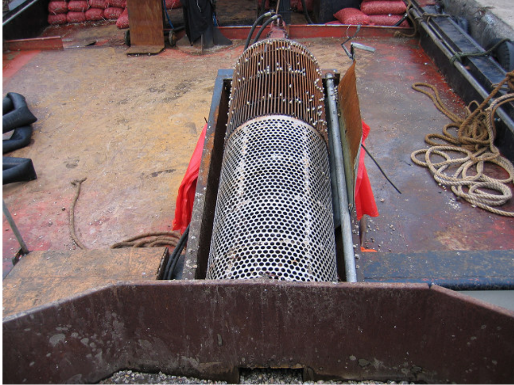
Ek Şekil 2. Avlanan ürünün tekne üzerinde elenmesini sağlayan helezonik elek
