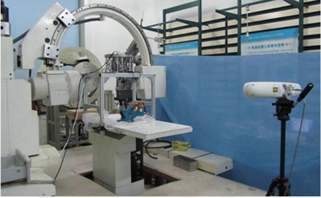
Şekil 1.1. Robot ile kemik taşlama deney platformu [6].
