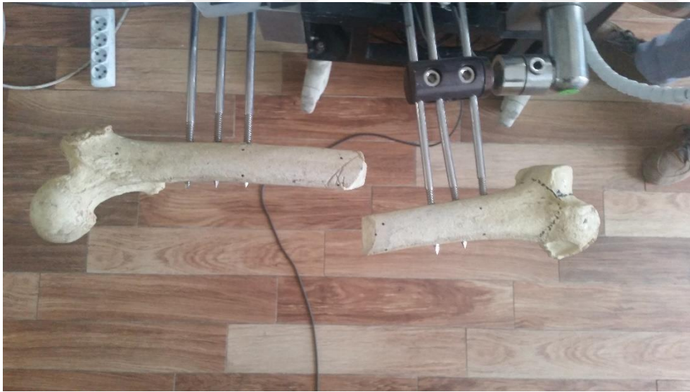
Şekil 2.3. Robotun model kemiğe olan bağlantısının üstten ve önden görünümü: (a) Üstten görünüm, (b) Önden görünüm
