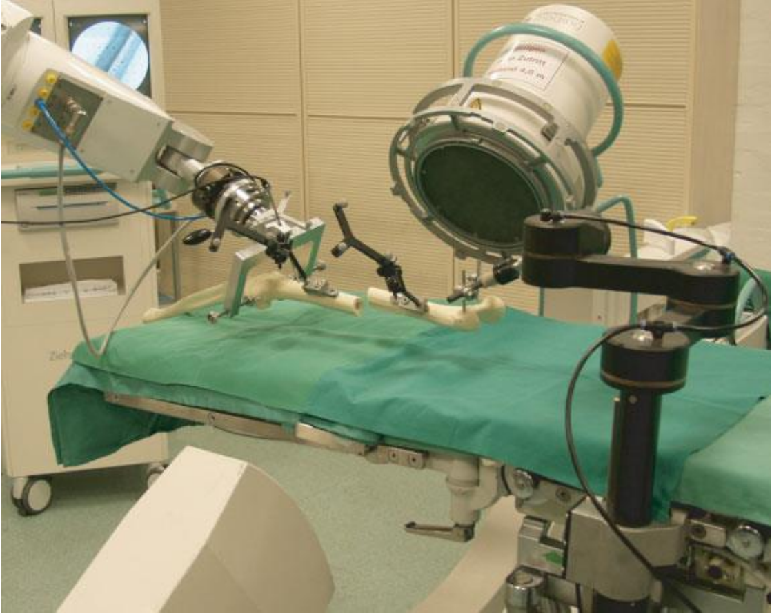
Şekil 1.15. Uzaktan kumandalı redüksiyon yapabilen robota ait bir görüntü [60]
