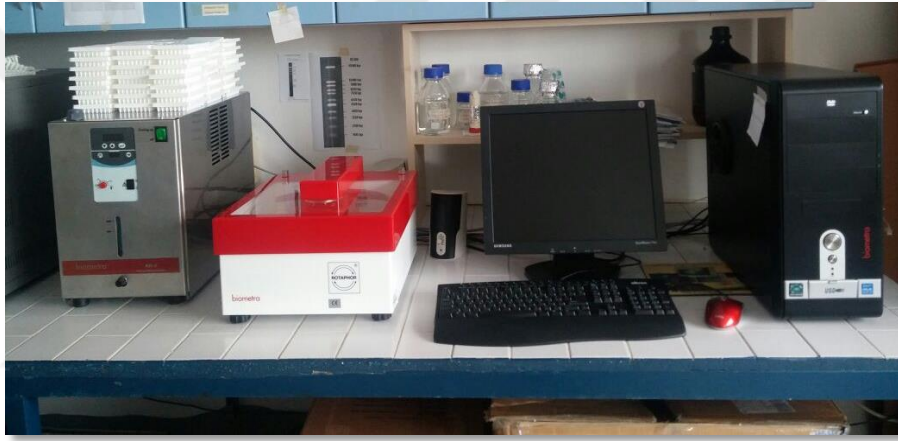
Şekil 2. Pulse Field Gel Electrophoresis sistemi görüntüsü
