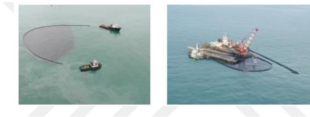
Şekil 2. Bariyerin U şeklinde çekilmesi ve sıyrıcı kullanımı [40]
