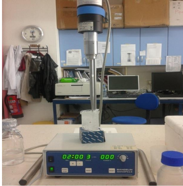
Şekil 5. Bakteri hücrelerinin prob sonikatör cihazı ile parçalanması
