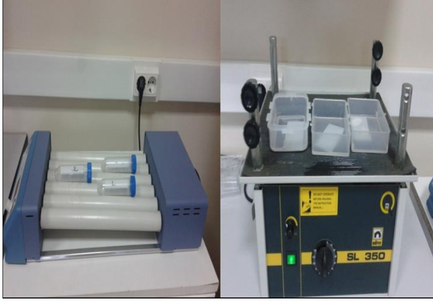
Şekil 10. Membrana aktarılan proteinlerin antikor/blotlama (1:10000) solusyonu içerisinde roller mikser üzerinde çalkalanması ve TBST ile yıkama işlemi
