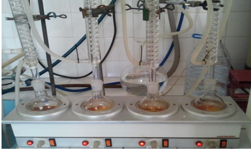
Şekil 2. Distilasyon düzeneği (Trabzon Merkez Su Ürünleri Araştırma Enstitüsü (SUMAE) Laboratuvarı, 2011)
