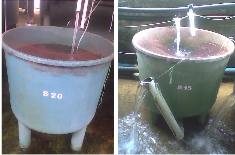
Şekil 6. Stok (Holding) tanklarının görünümü.
