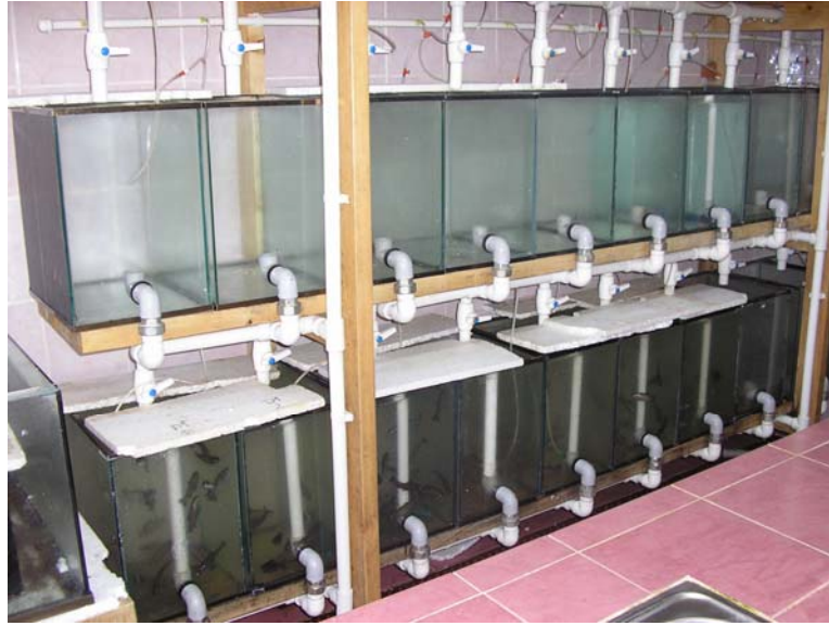
Şekil 3. Toksikolojik testlerde kullanılan 40 litrelik akvaryum sistemleri
