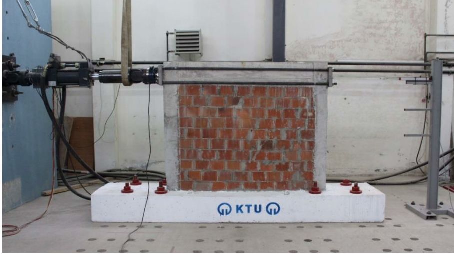
Şekil 3.1. GYDDE deney elemanının deney esnasından bir görünümü
