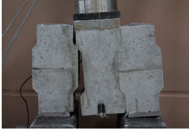
Şekil 2.41. Doğrudan kayma deney elemanında meydana gelen hasar durumu
