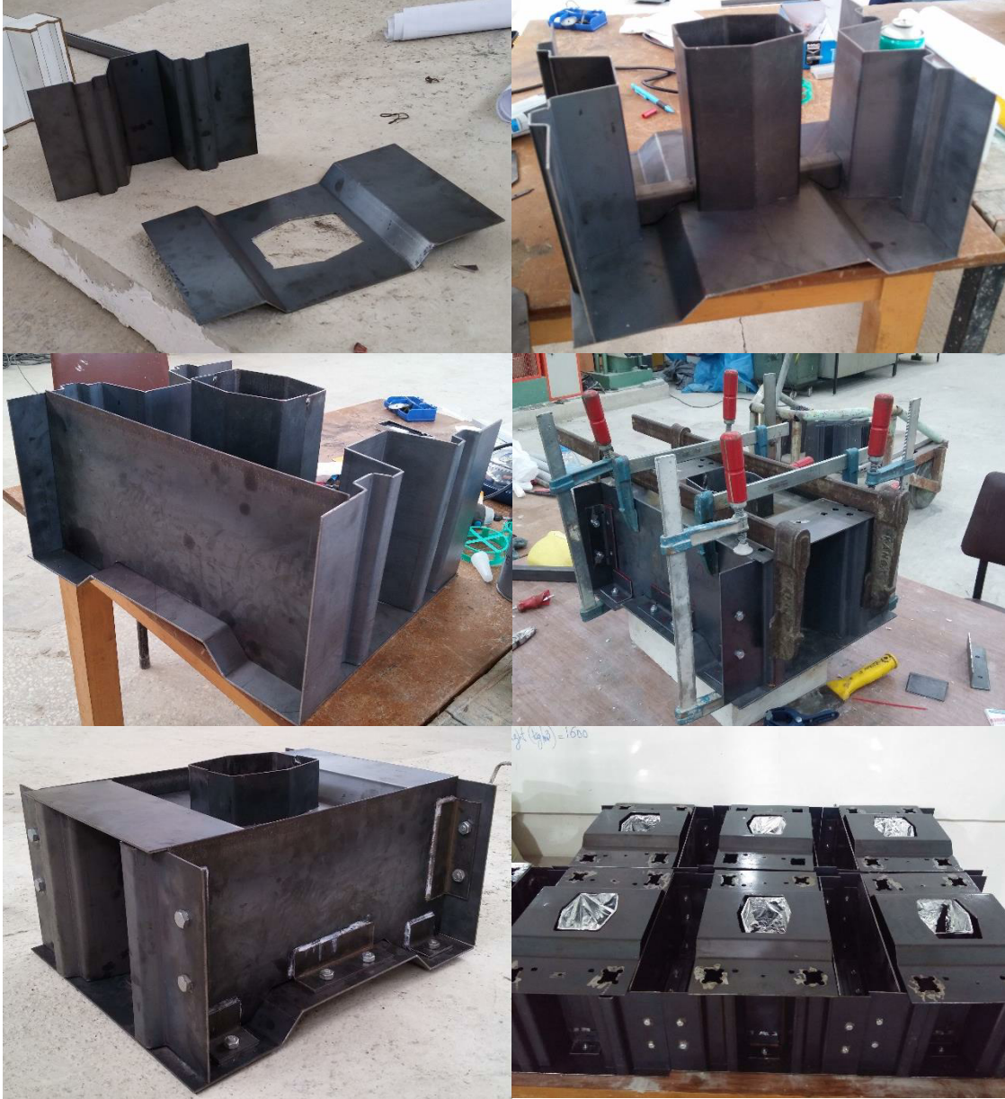
Şekil 2.12. Kilitli yığma birim eleman kalıplarının hazırlanma aşamaları
