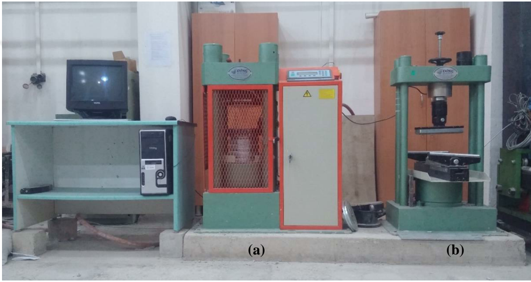
Şekil 2.28. Yüksek kapasiteli (a) aksenal basınç, (b) eğilmede-yarmada çekme deney aleti
