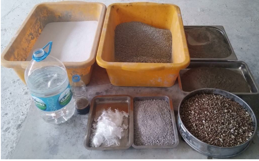
Şekil 2.5. Önceden tartılıp hazır hale getirilen karışım malzemeleri
