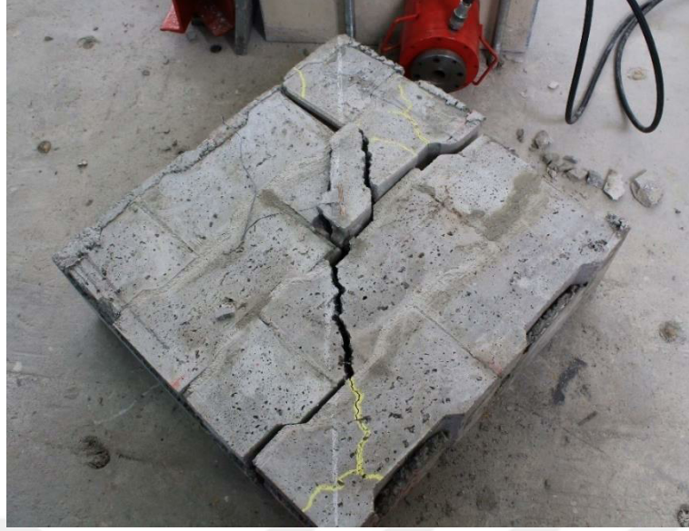
Şekil 2.44. Diyagonal basınç deney elemanının nihai kırılma şekli
