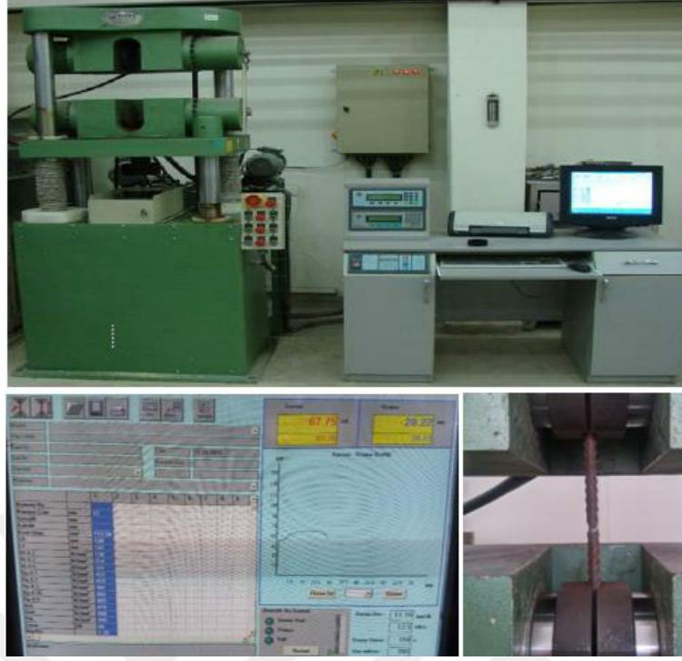
Şekil 2.3. 600 kN kapasiteli üniversal deney aleti
