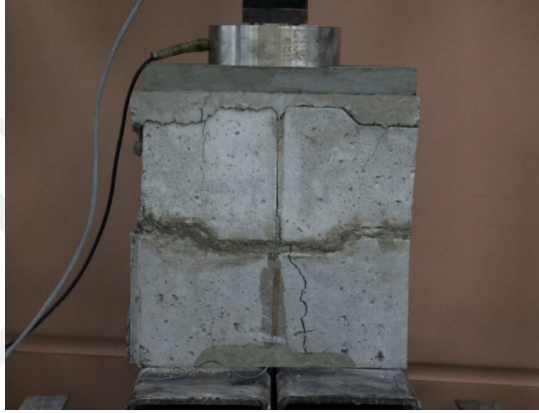
Şekil 2.37. Prizmatik deney elemanındaki aksenal basınç hasarları
