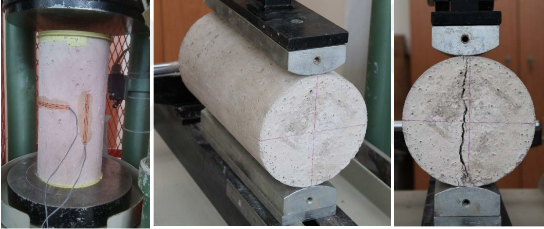
Şekil 2.29. Beton numunelerde basınç ve yarmada çekme deneyleri
