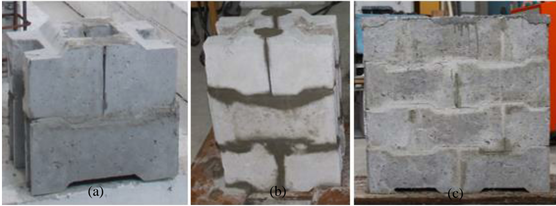
Şekil 2.22. (a) Merkezi basınç, (b) doğrudan kayma ve (c) diyagonal basınç deney elemanları
