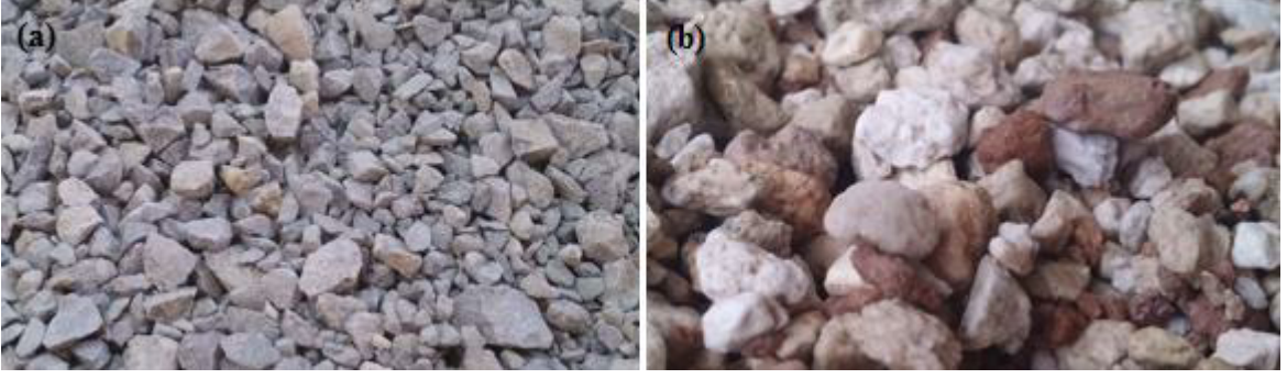
Şekil 2.1. Hafif beton üretimlerinde kullanılan agregalar, (a) geleneksel agregata, (b) pomza
