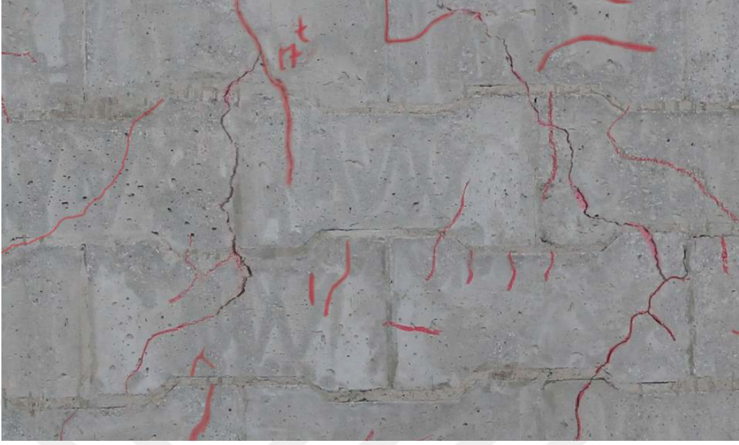
Şekil 3.20. KYDDE-3'te deney sonunda meydana gelen hasarların yakından görünümü
