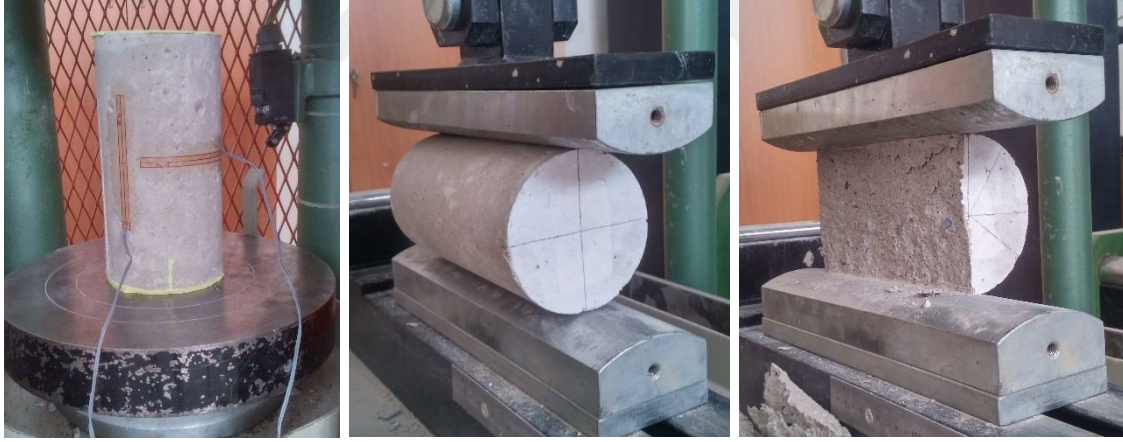
Şekil 2.31. Harç numunelerde basınç ve yarmada çekme deneyleri
