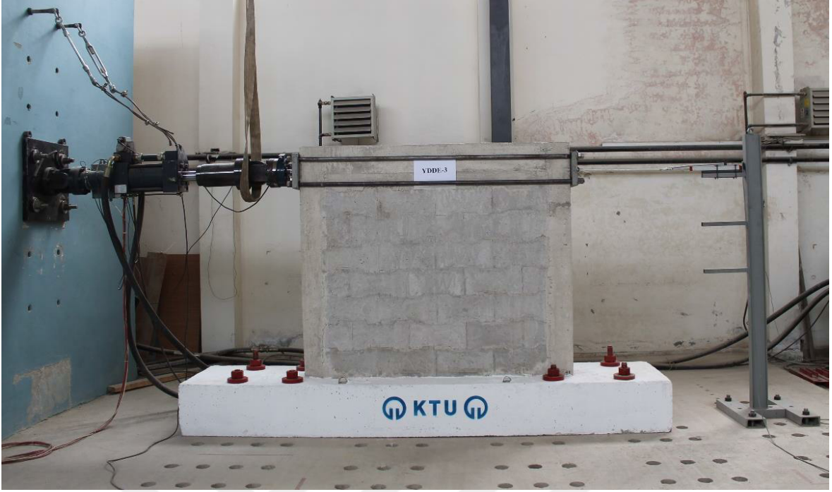
Şekil 2.48. Deneye hazır hale getirilen kilitli deney elemanından bir görünüm
