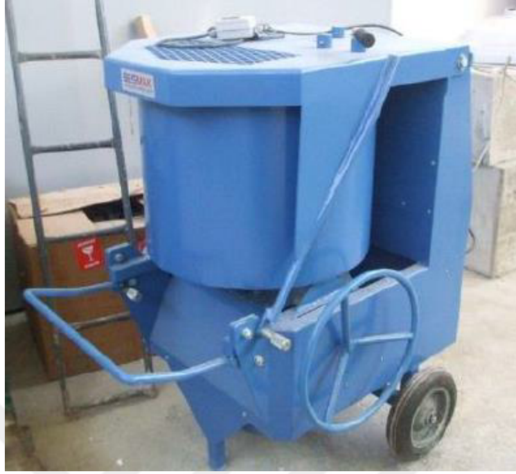
Şekil 2.4. Betonların üretiminde kullanılan düşey eksenli betonyer
