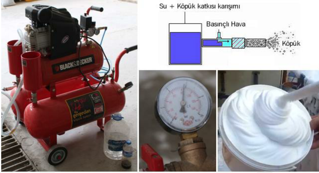
Şekil 2.7. Üretimlerde kullanılan köpük jeneratörü ve çalışma prensibi
