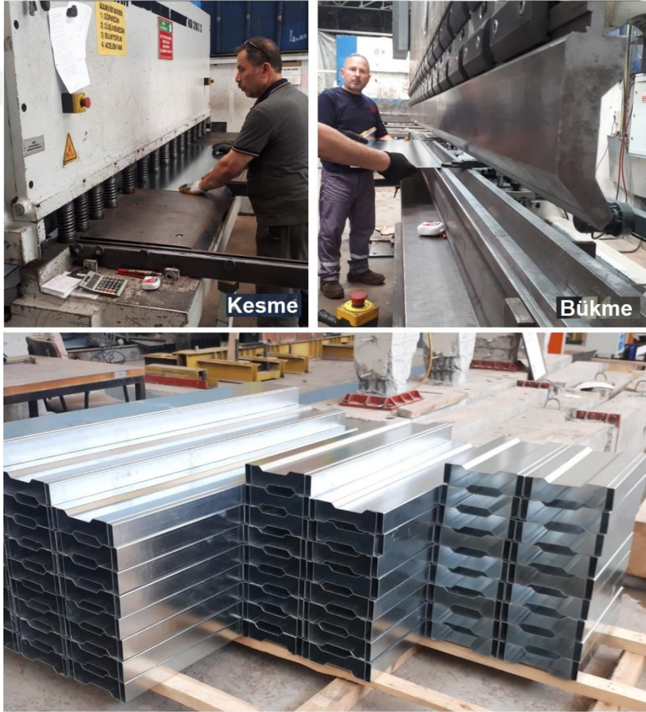
Şekil 28. Sigma profillerin üretimi ve topluca görünümü
