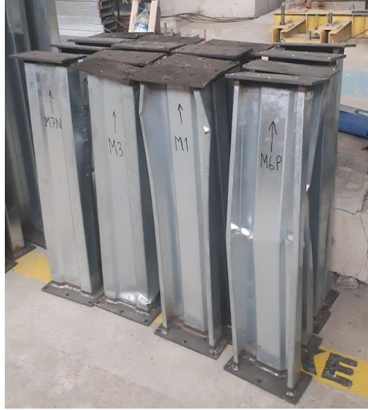
Şekil 63. L=1000 mm'lik numunelerin deney sonrası görünümü
