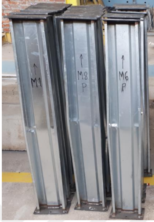
Şekil 73. L=1500 mm'lik numunelerin deney sonrası görünümü
