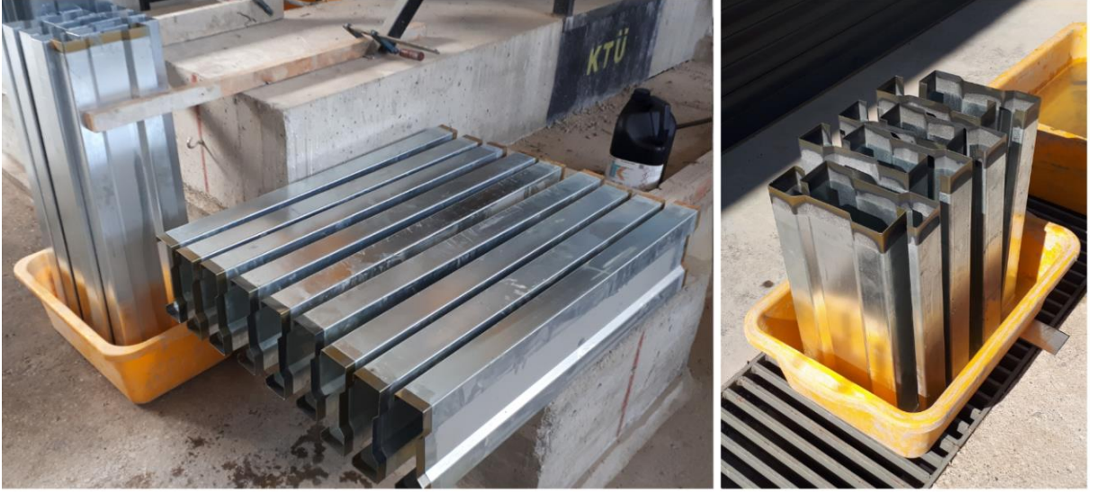
Şekil 30. Profillerin kaynaklama bölgesinde asit banyosu işlemi
