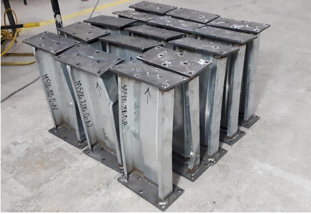
Şekil 53. L=500 mm'lik numunelerin monotonik deneyler sonrası görünümü
