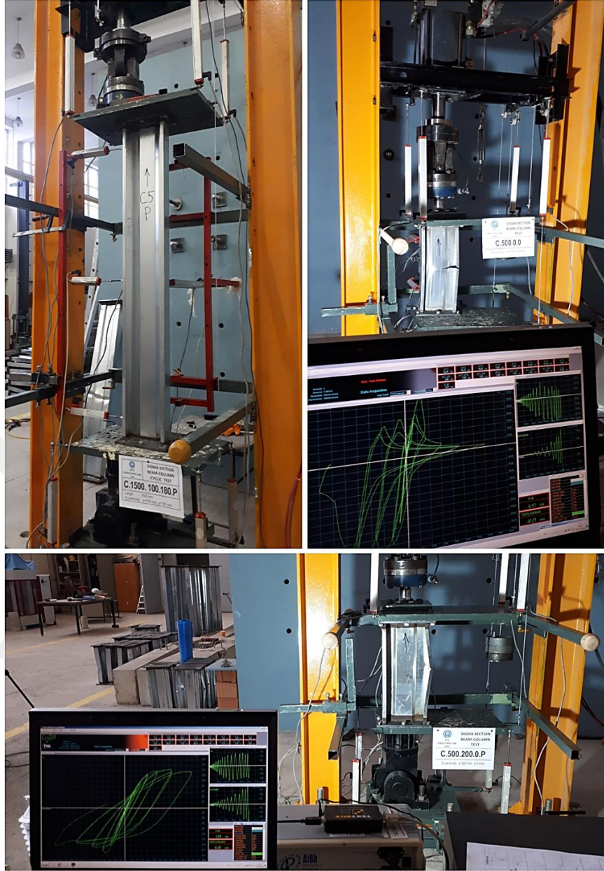
Şekil 83. Tersinir-tekrarlı yükleme deneylerinden görünüm
