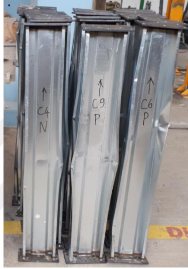
Şekil 105. 1500 mm'lik numunelerin tersinir-tekrarlı deney sonrası görünüşleri
