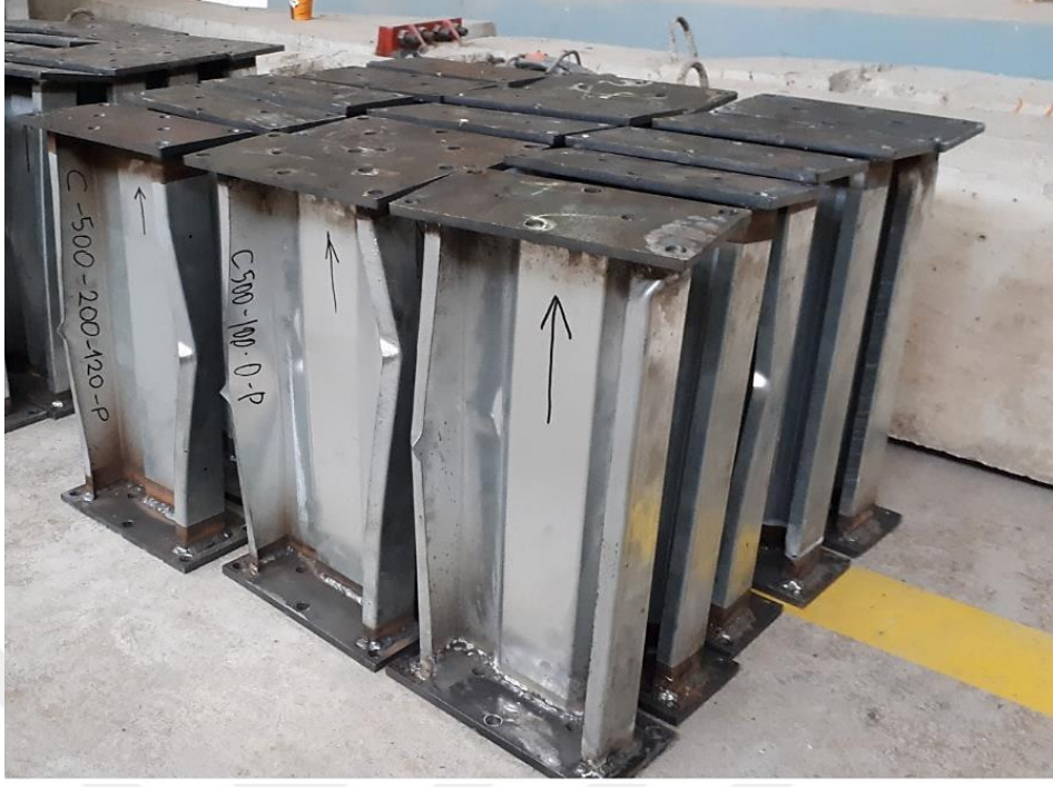
Şekil 85. L=500 mm'lik numunelerin tersinir-tekrarlı deneyler sonrası görünüşleri
