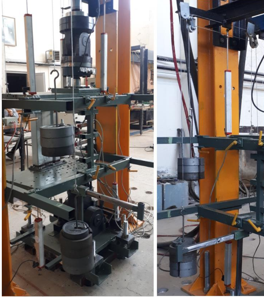
Şekil 36. Yükleme levhalarının karşı ağırlıkla dengelenmesi
