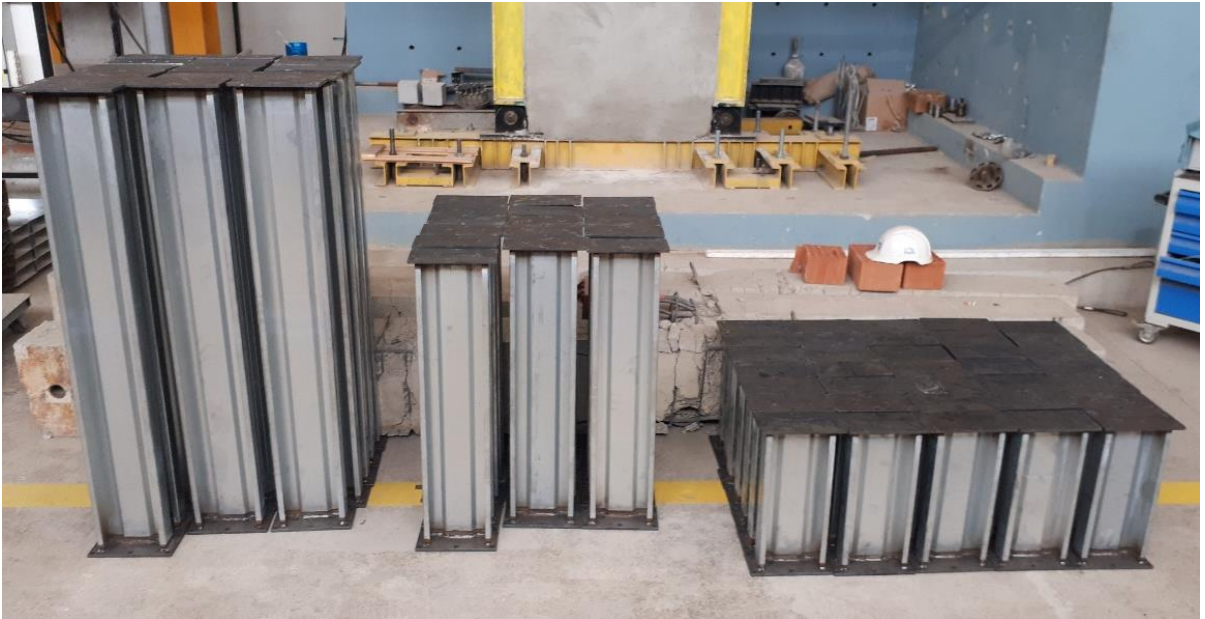
Şekil 32. Sigma kesitli deney numuneleri (L=500 mm, 1000 mm ve 1500 mm)
