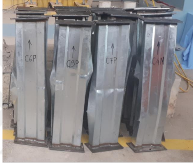
Şekil 95. 1000 mm'lik tersinir tekrarlı yükleme numunelerinin deney sonrası görünüşü
