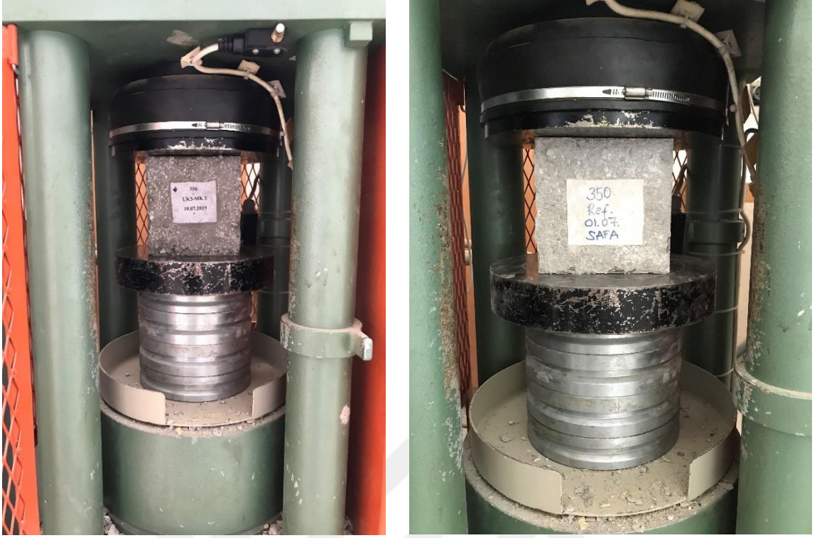
Şekil 3.15. Basınç dayanımı deneyinin gerçekleştirilmesi
