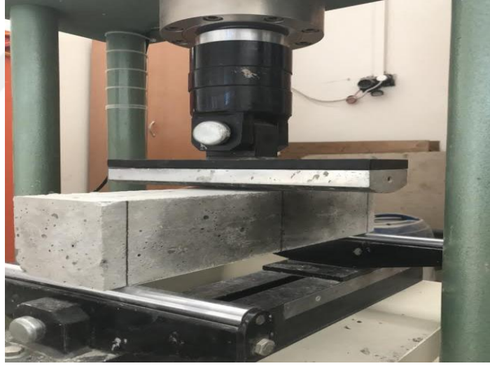
Şekil 3.17. Eğilme deney düzeneğinde numunenin konumlandırılması
