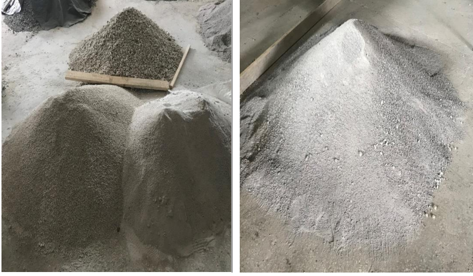
Şekil 3.3. Deneysel çalışmada kullanılan pomza ve perlit agregaları
