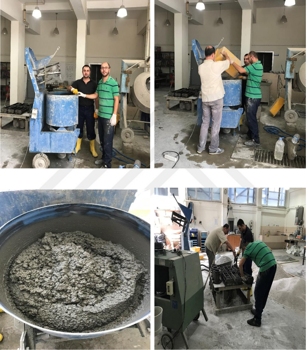
Şekil 3.9. Üretimlerde kullanılan mikser, üretilen taze beton ve betonun kalıplara alınması
