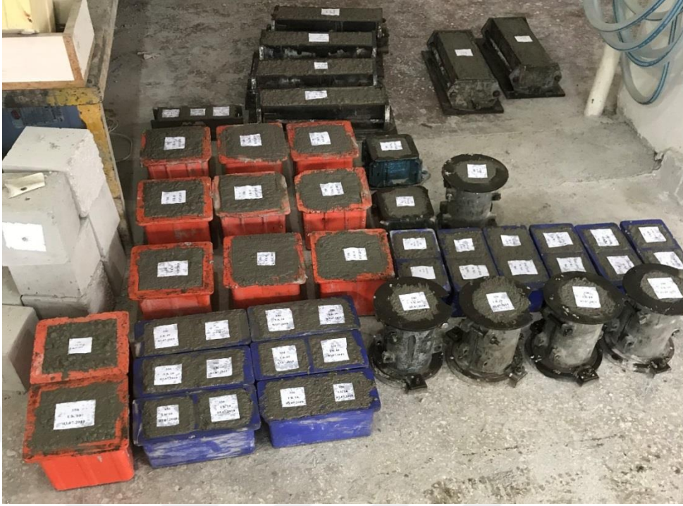
Şekil 3.10. Üretim sonrası kalıplarında numuneler
