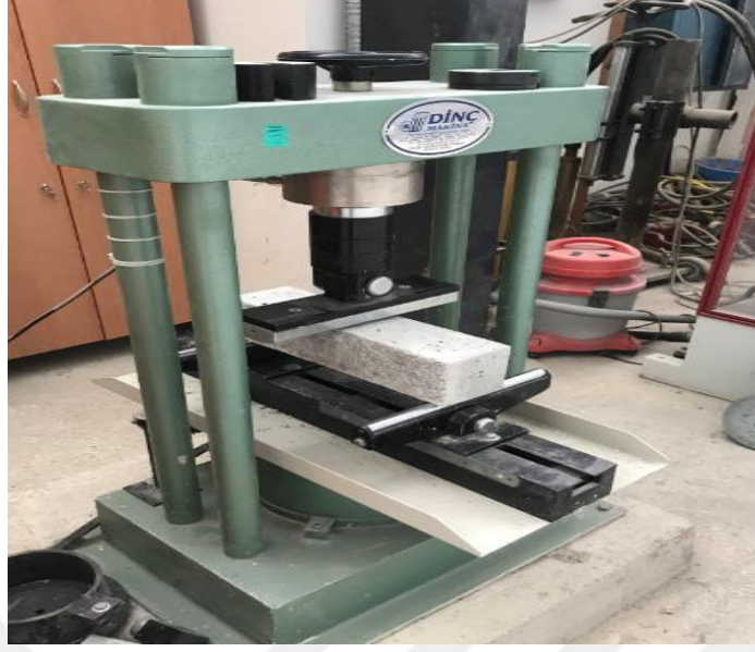
Şekil 3.16. Eğilme deneyi düzeneği
