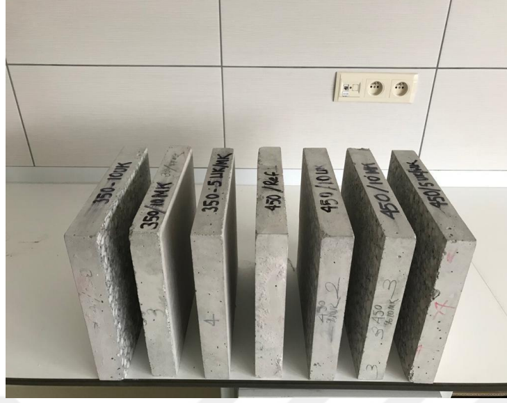
Şekil 3.27. Isı iletkenlik katsayısı ölçümünde kullanılan numuneler
