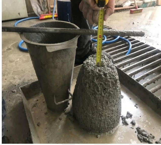
Şekil 3.13. Çökme konisi ve çökme deneyi
