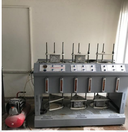
Şekil 3.23. Basınç altında su işleme derinliği tayini deney düzeneği
