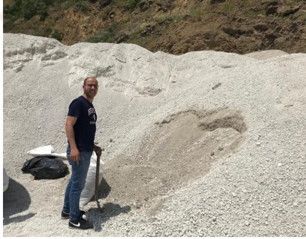
Şekil 3.2. Deneylerde kullanılan pomza agregası
