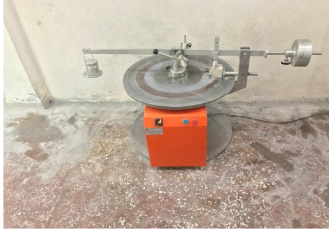
Şekil 3.21. Aşınma (Böhme) cihazı
