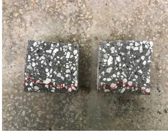
Şekil 3.24. Su işleme derinliği tayini deneyi sonrası beton örnek kesitleri
