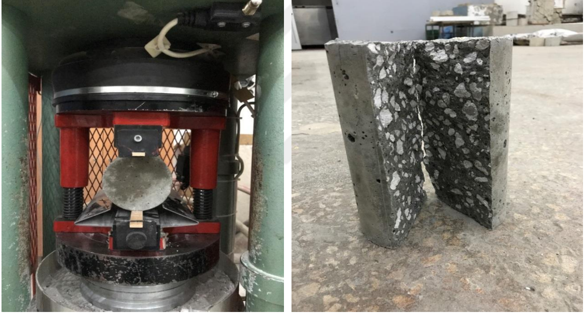
Şekil 3.18. Yarmada çekme deneyi düzeneği ve deney sonunda numunenin durumu
