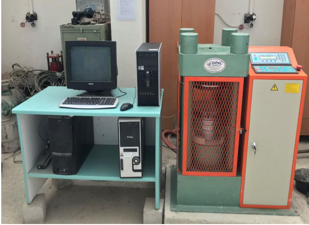
Şekil 3.14. Basınç dayanımı deneyinde kullanılan pres ve deney düzeneği
