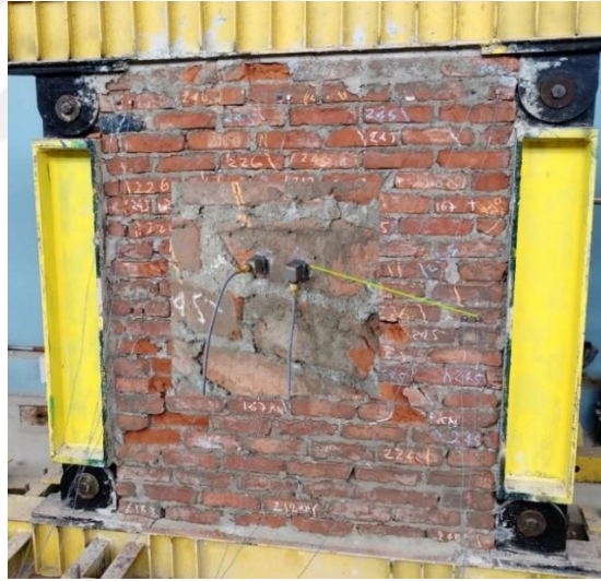
Şekil 2.31. Sensörlerin hasarlı harman duvarına yerleştirilmesi (sensörlere yakınlaştırma ile)
