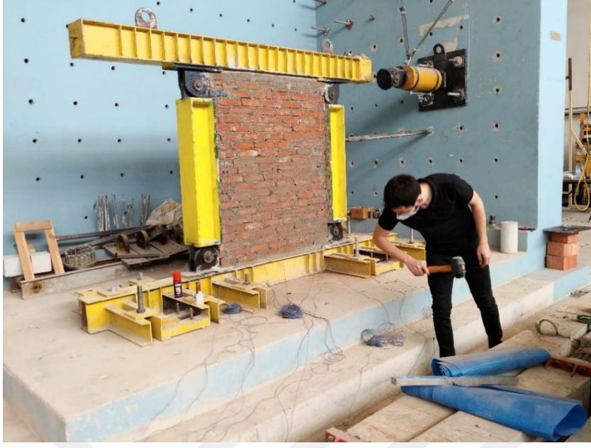
Şekil 2.34. Harman duvar için çekiçle uyarma
