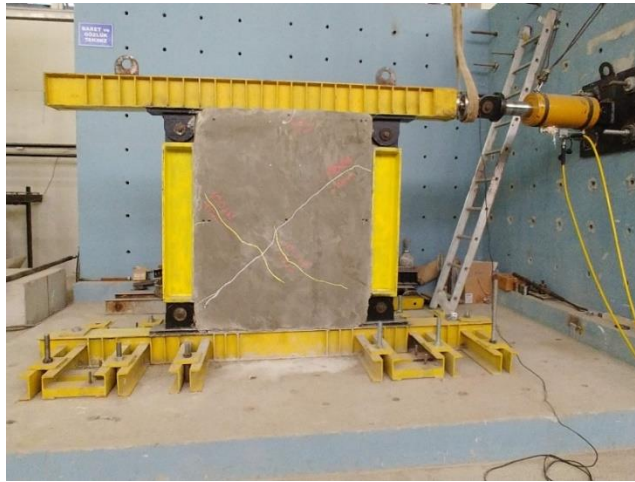
Şekil 2.35. Pistonun döngüsel yüklerinin etkisiyle duvar hasar görmeye başlar
