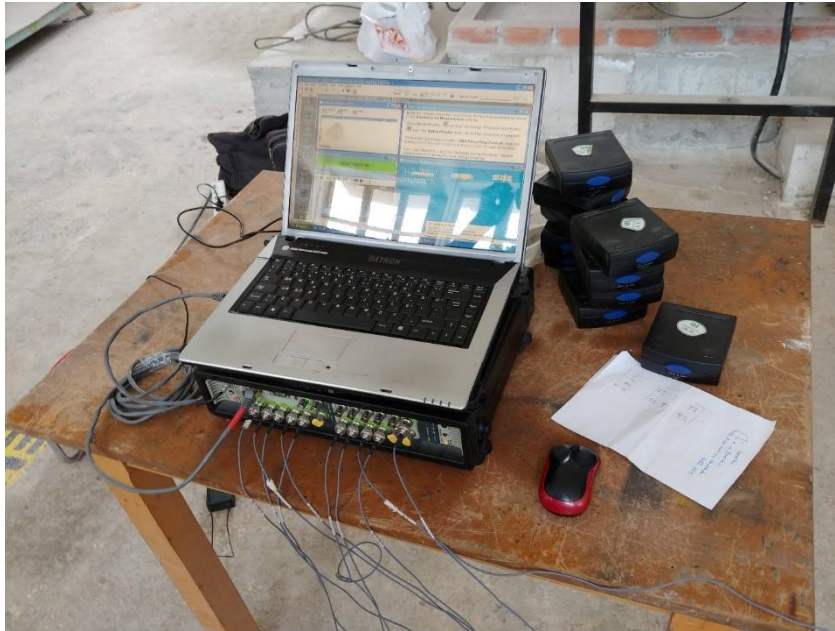
Şekil 2.26. Frekans ve mod kayıt cihazları (kontrol bilgisayarı ve sinyal analiz cihazı)
