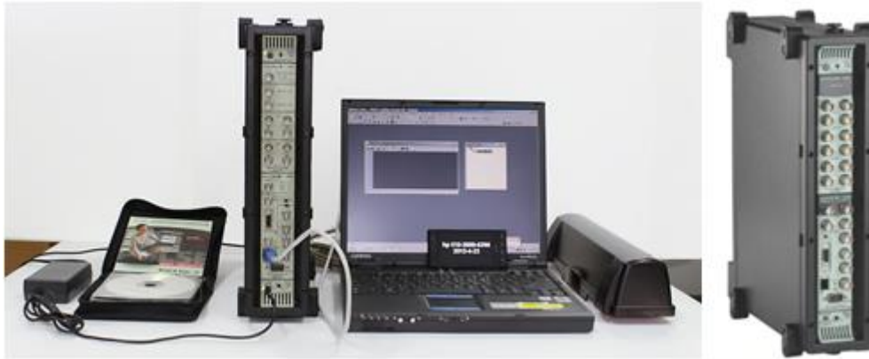
Şekil 1.8. B&K 3560 C tipi 17 kanallı veri toplama ünitesi (Günaydın, 2016)
