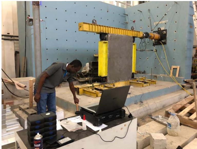
Şekil 2.33. Delikli duvar için çekiçle uyarım
