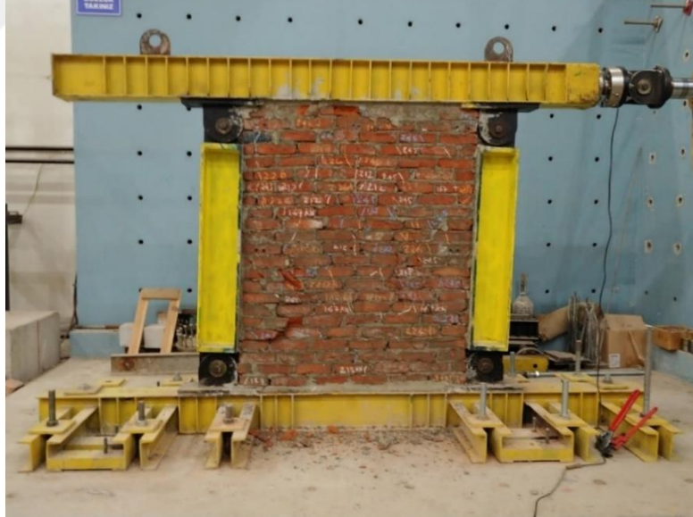
Şekil 2.37. Harman tuğla duvarı çevrimsel yükler altında
