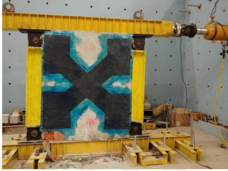
Şekil 2.36. FRP malzeme ile güçlendirilmiş döngüsel yükler altında duvar
