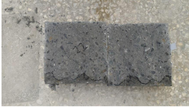
Şekil 2.38. Yarma işlemi sonrası su işleme seviyesinin belirlenmesi
