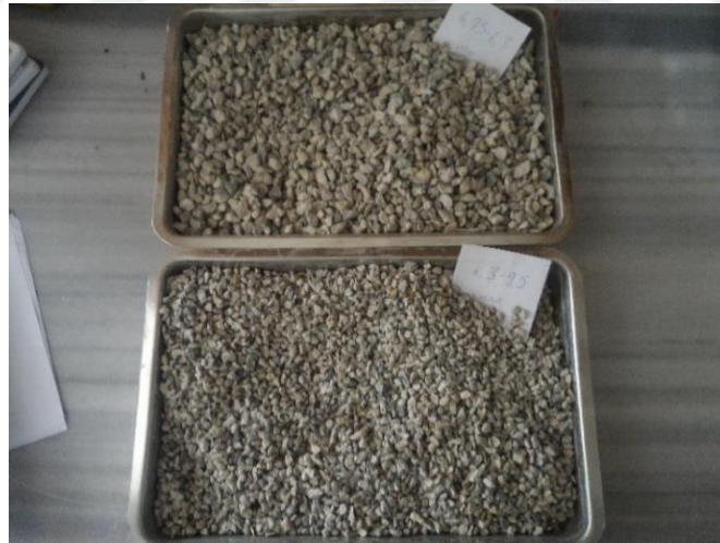
Şekil 2.12. Elenmiş, yıkanmış ve kurutulmuş agrega numuneleri
