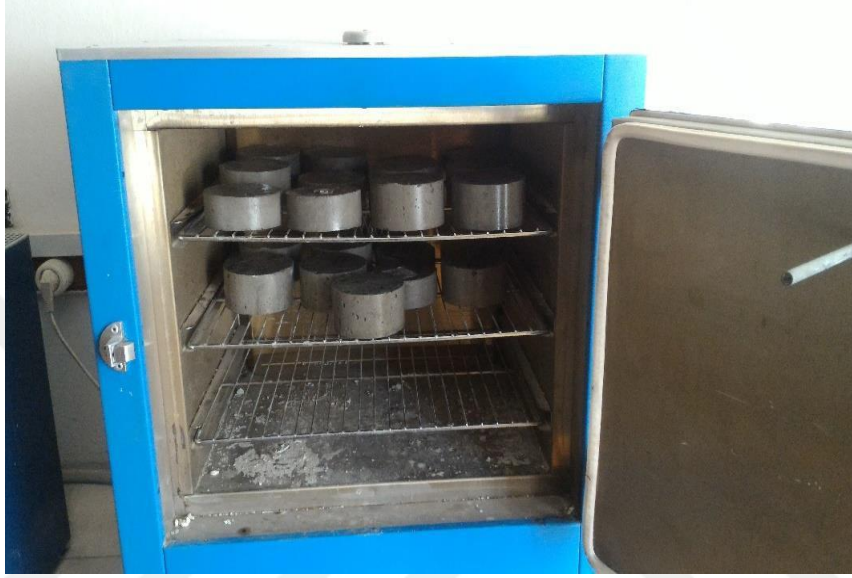
Şekil 2.40. Kılcallık deneyi numuneler kurutmak için kullanılan etüv
