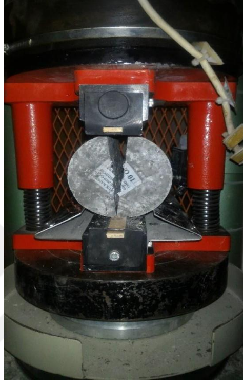
Şekil 2.25. Yarmada çekme dayanımı deneyi
