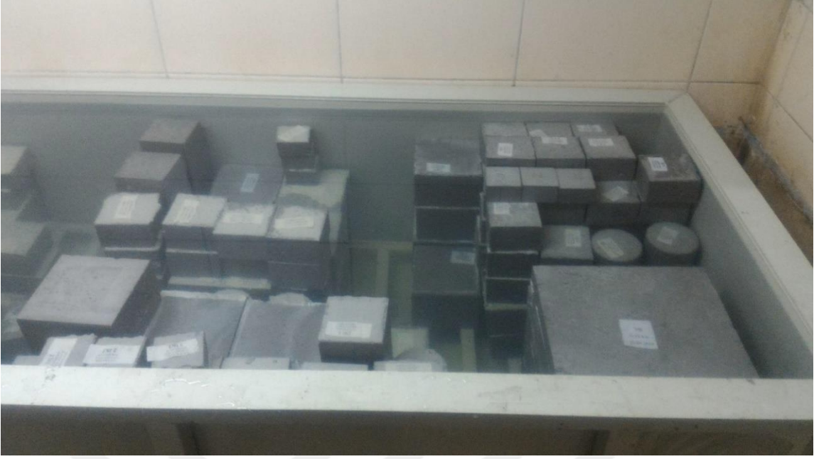
Şekil 2.20. Su dolu kür tankında tutulan numuneler
