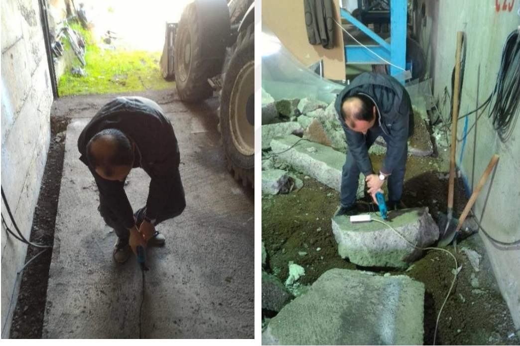
Şekil 2.4. Beton plak ve beton parçalar üzerinde Schmidt okuması
