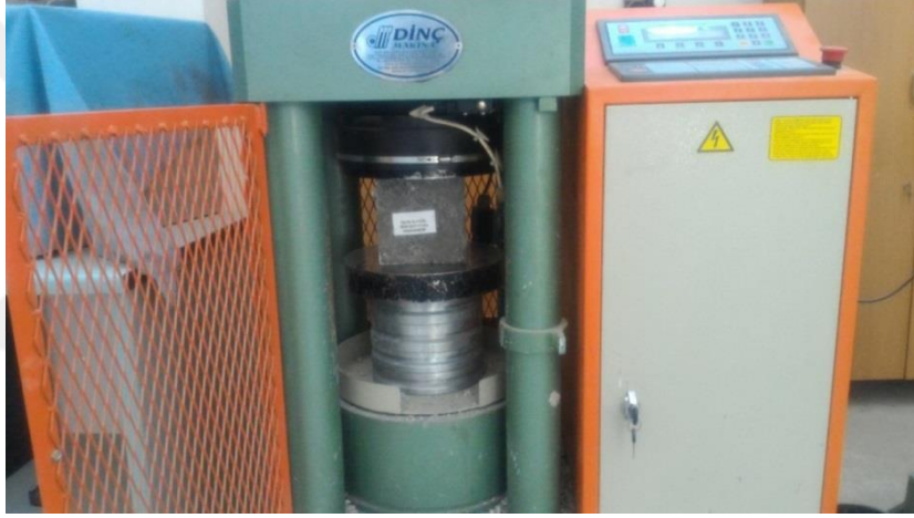
Şekil 2.24. Basınç dayanımı test cihazı
