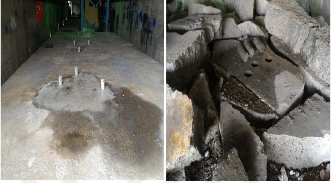
Şekil 2.5. Beton plaktan ve kırılmış parçalardan karot alma işlemi
