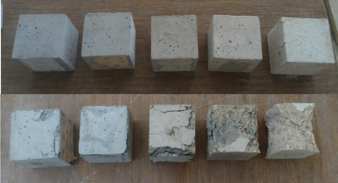
Şekil 2.46. Yüksek sıcaklığa maruz kalan numuneler (soldan sağa sıcaklık artmakta)
