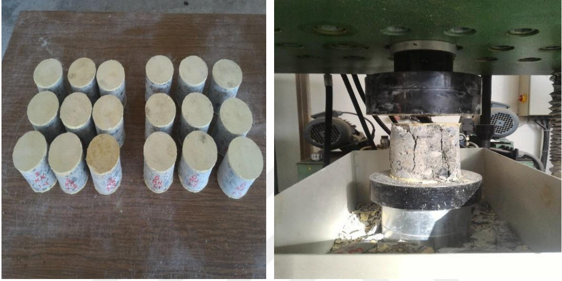
řekil 2.7. Başlıklanmıř karot numuneler ve basın dayanımı deneyinin gerekleřtirilmesi
