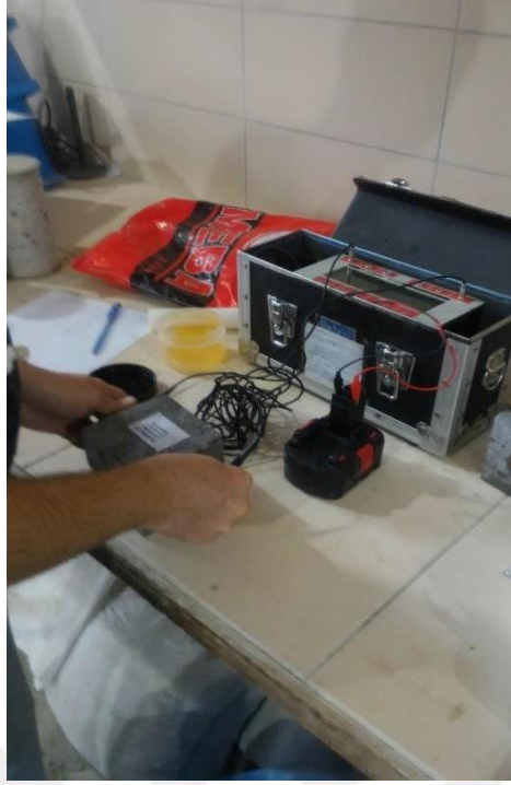
Şekil 2.32. Ultrases geçiş hızı deneyi
