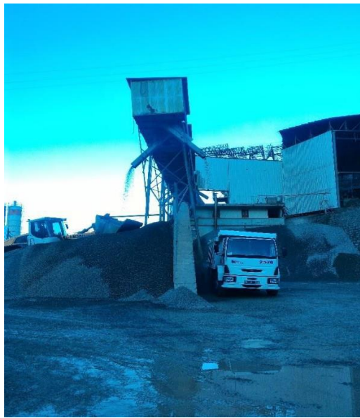
Şekil 2.3. Beton bloklarının GKA haline getirilmesi
