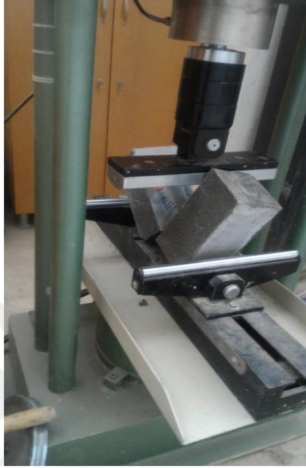
Şekil 2.26. Eğilme deneyi düzeneği
