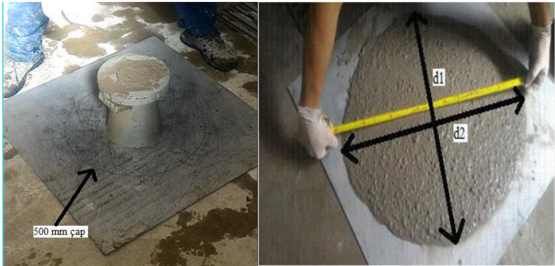
Şekil 2.21. T 500 ve çökme-yayılmanın ölçülmesi
