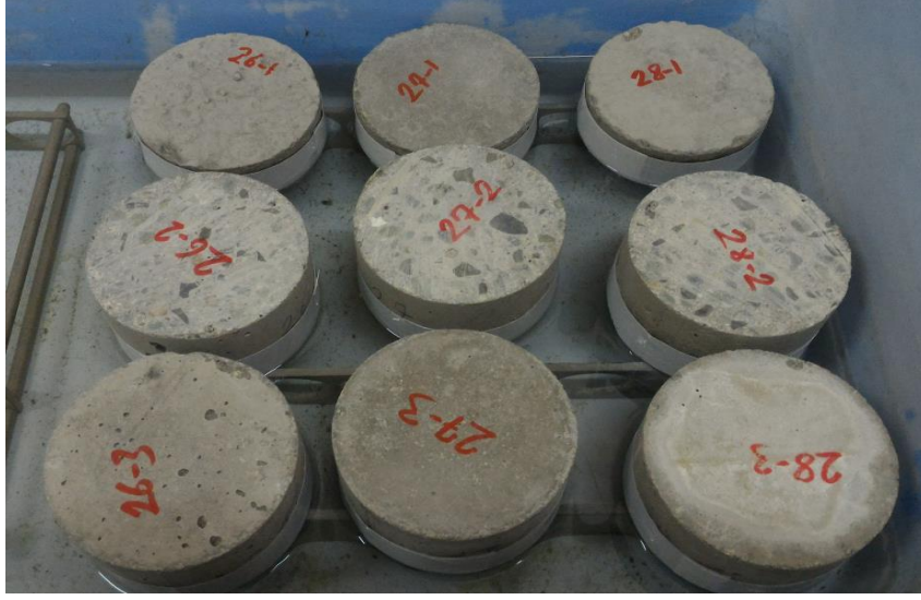
Şekil 2.41. Kılcallık deney düzeneği
