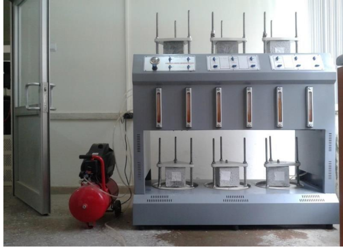
Şekil 2.39. Basınçlı su işleme derinliği tayini deneyi cihazı
