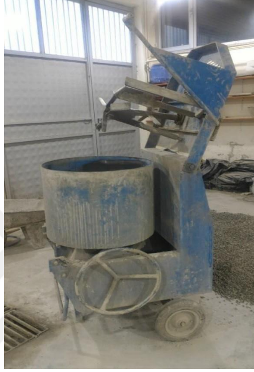
Şekil 2.17. Beton üretimlerinde kullanılan karıştırıcı
