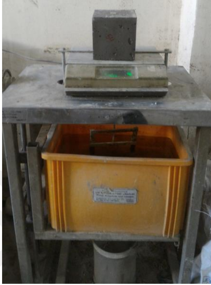
Şekil 2.43. Birim ağırlığı belirlemede kullanılan Arşimet terazisi
