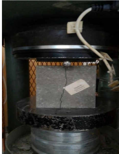
Şekil 2.37. Su işleme derinliği deneyi sonrası numunenin yarılmış hali
