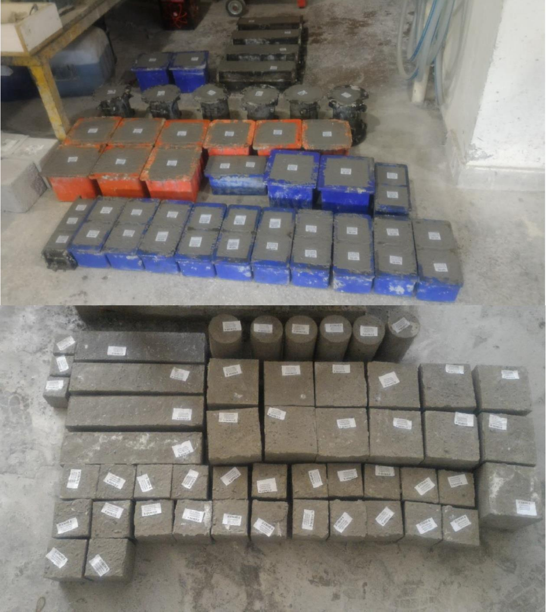
Şekil 2.19. Tek üretimde denenmek üzere hazırlanan KYB numuneler
