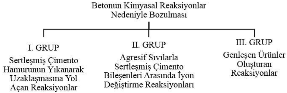
Şekil 1.12. Betonun kimyasal bozulma nedenleri [147]
