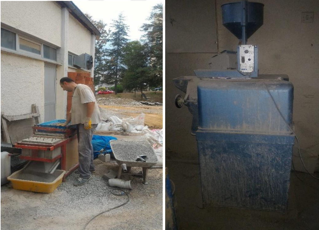
Şekil 2.8. Agregaya eleme cihazı (solda) ve öğütme cihazı (sağda)
