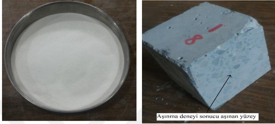
Şekil 2.28. Zımpara (korundum) tozu ve aşınan deney numunesi
