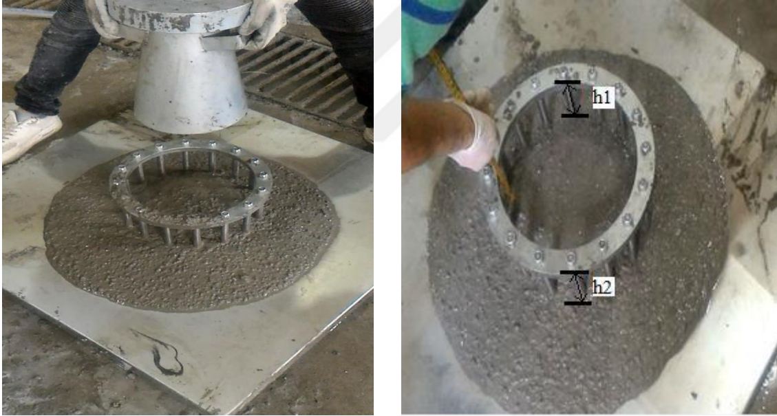
Şekil 2.22. J halkası deneyinin gerçekleştirilmesi
