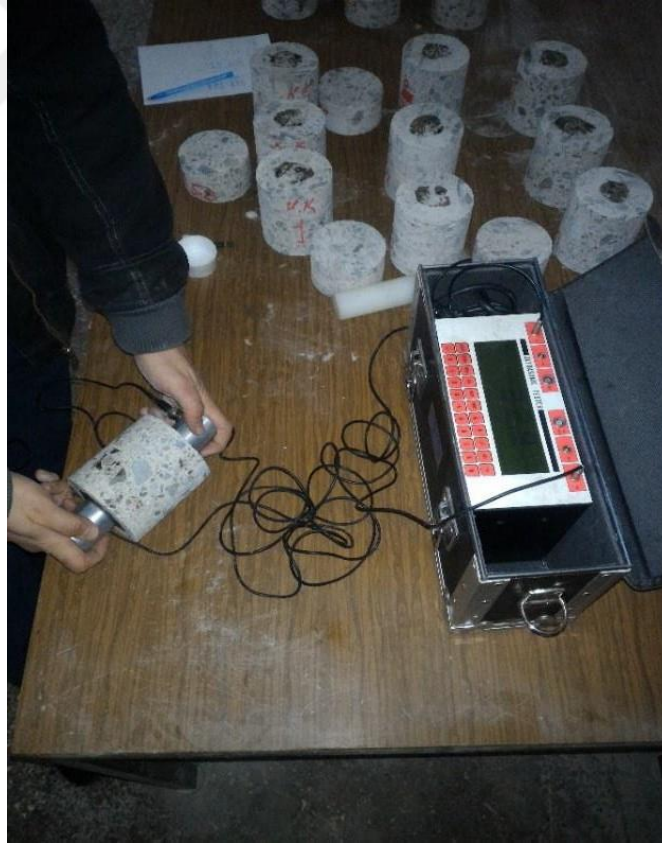
Şekil 2.6. Ultrases geçiş hızı tayini
