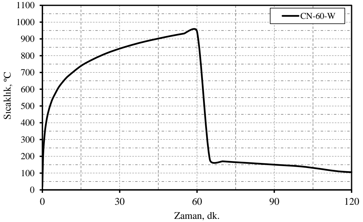
řekil 3.81. CN-60-W numunesinin yüzeyine etki eden sıcaklık-zaman eğrisi
