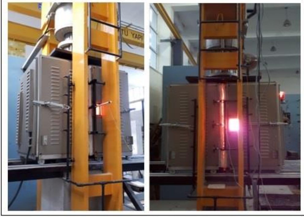
Şekil 2.11. Elektrikli fırının ısıtma işlemi sırasındaki hali
