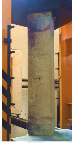
Şekil 3.9. Soğutma aşamasına ait termokuplun yerleştirilmiş görüntüsü
