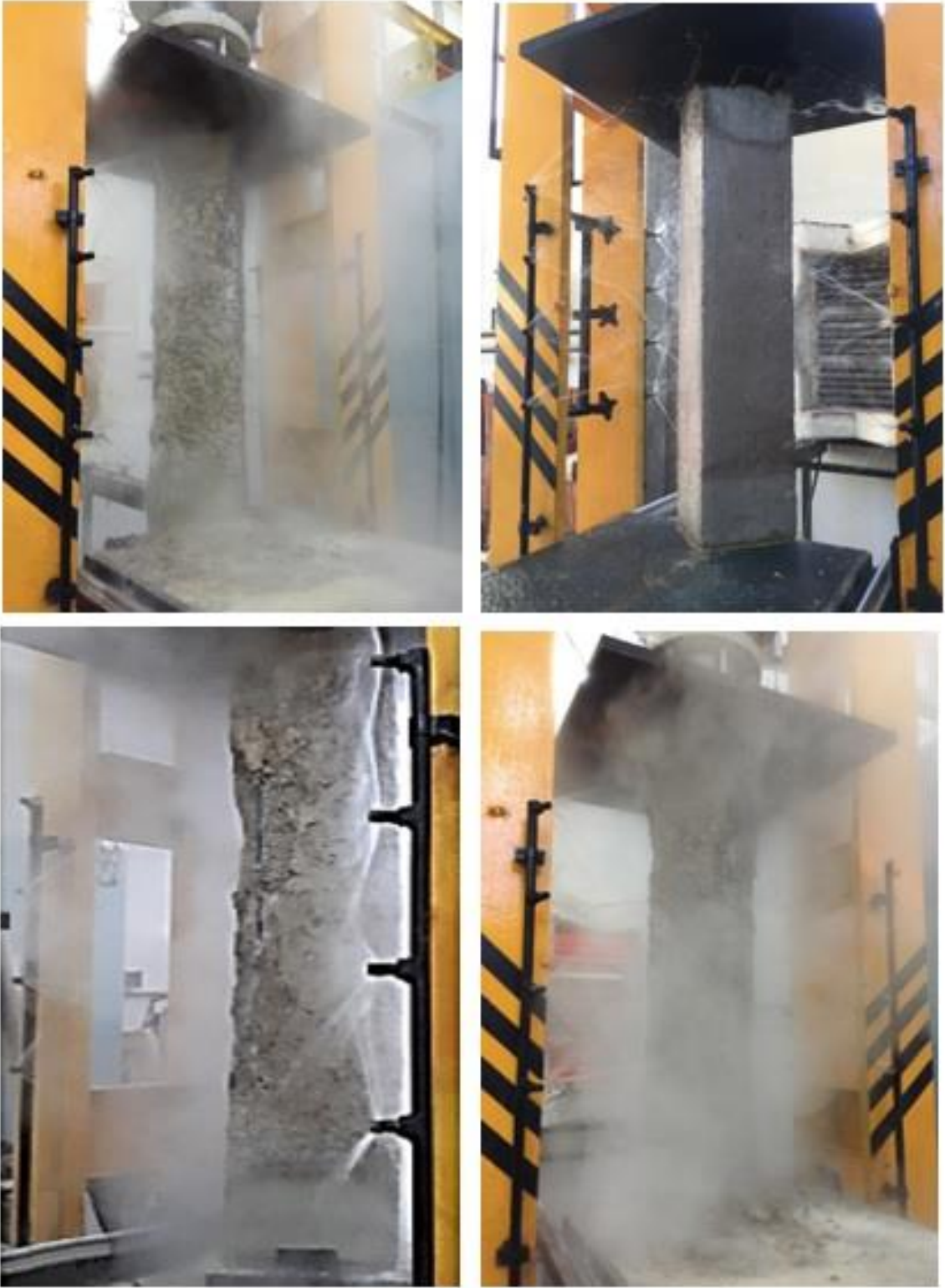
Şekil 2.19. Su ile soğutma işlemine ait bazı görüntüler
