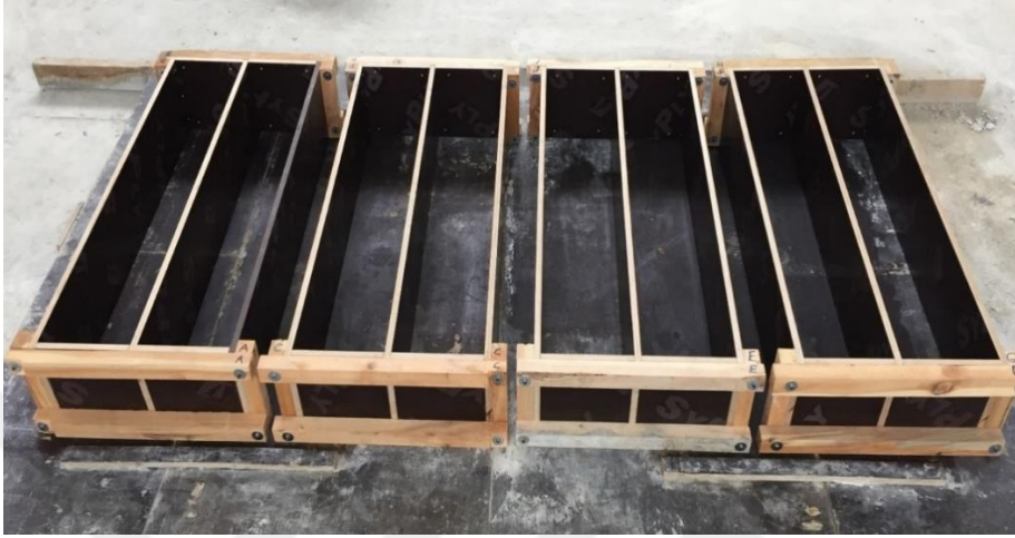
Şekil 2.4. Plywood levhalarından yapılan kolon kalıpları
