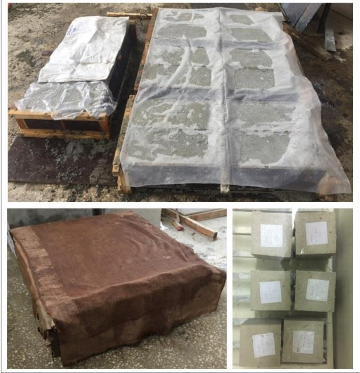
Şekil 2.7. Küp ve kolon numunelerin kürlenmesi
