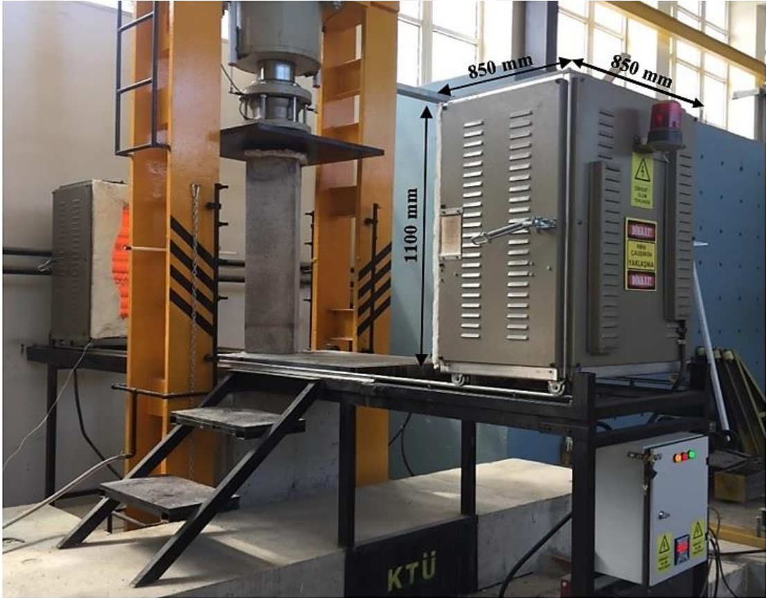
Şekil 2.10. Elektrikli fırının numuneden uzaktaki hali ve boyutları
