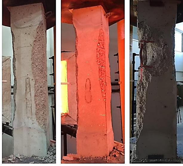
Şekil 3.47. Numunelerdeki genel kabuk atma görüntüleri
