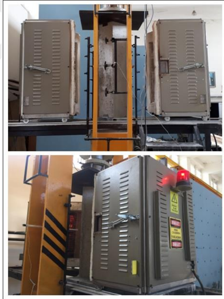
Şekil 2.17. Termokuplun yerleştirilmiş görüntüleri
