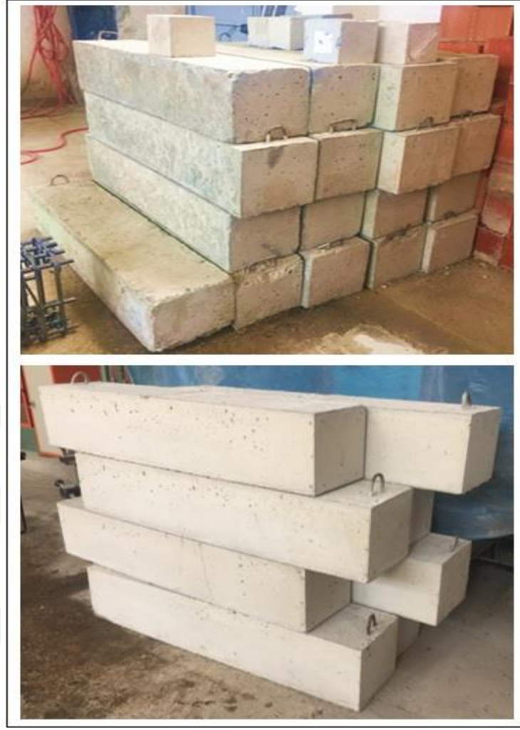
Şekil 2.8. Betonarme kolon deney numuneleri
