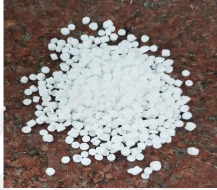
Şekil 2.3. Kraton D1101AT kodlu Styrene-Butadiene-Styrene (SBS) kopolimerleri
