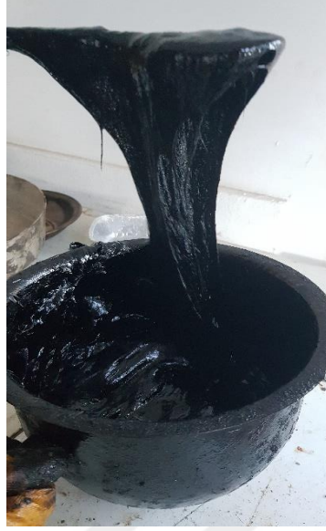
Şekil 2.8. Bitüm modifikasyonunda yüksek oranda lif kullanımının sertleşme etkisi (lifin katkı oranı %1,3 ve uzunluğu 6 mm)
