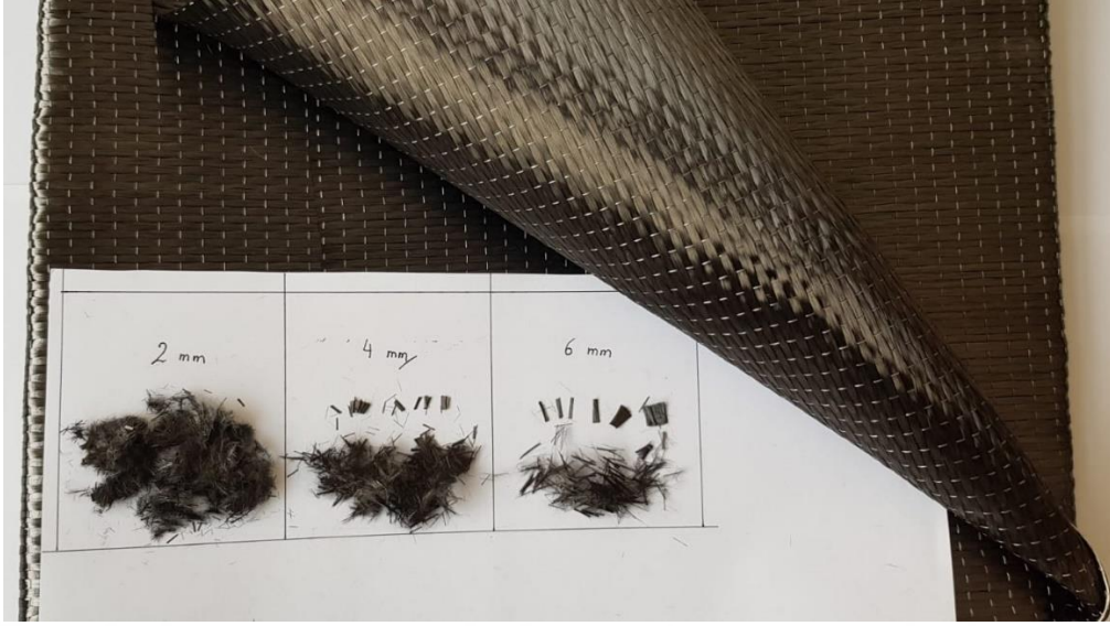
Şekil 2.5. Çalışmada kullanılan karbon lifinin kesilmiş ve ayrılmış hali
