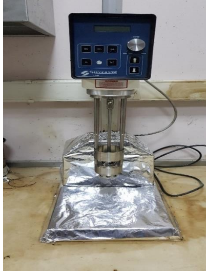
Şekil 2.6. Yüksek hızlı polimer modifiye bitüm mikseri
