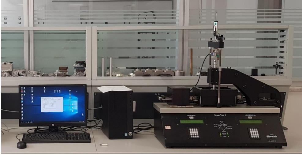
Şekil 2.13. Çalışmada kullanılan Shear Trac II-DSS Geocomp markalı çevrimsel basit kesme cihazı
