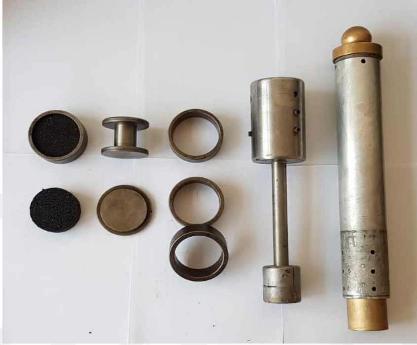
Şekil 2.9. Çalışmada kullanılan kalıp ve sıkıştırma elemanı
