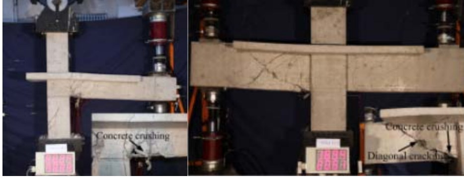
Şekil 1.36. Kompozit kolon-betonarme kiriş için önerilen iç diyaframlı birleşim elemanı (Ma vd., 2019)
