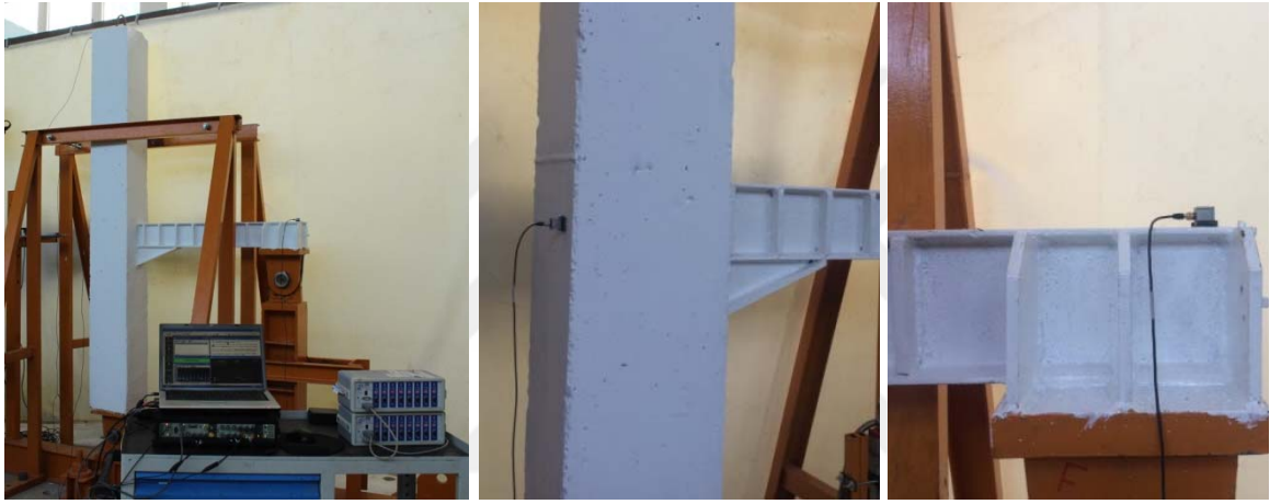
Şekil 3.128. Hasarsız KKB-F elemanının çevresel titreşim testine ait bazı görünüm
