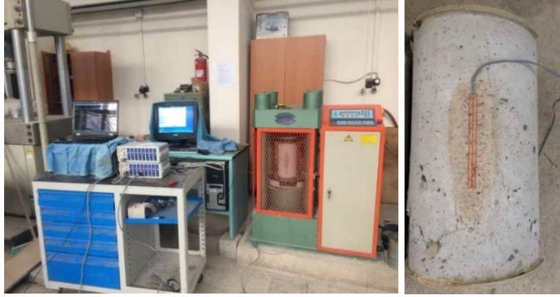
Şekil 2.51. Tek eksenli basınç deneyi ve numuneye yerleştirilen birim şekil deęiştirme ölçer
