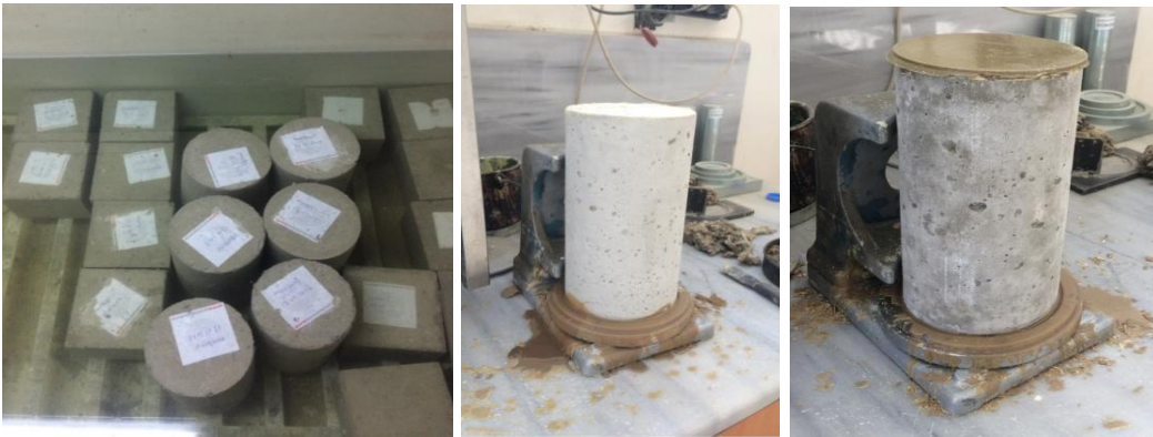
Şekil 2.50. Alınan beton numunelerin hazırlama aşamaları
