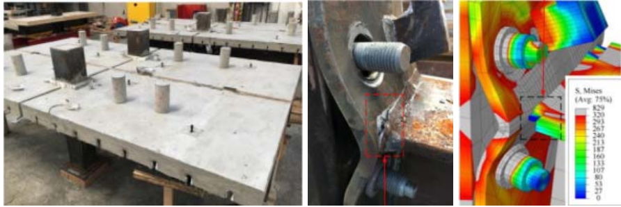
Şekil 1.34. Kompozit kolon-kompozit kiriş birleşimi için önerilen iç diyaframlı birleşim elemanı (Wang vd., 2018)
