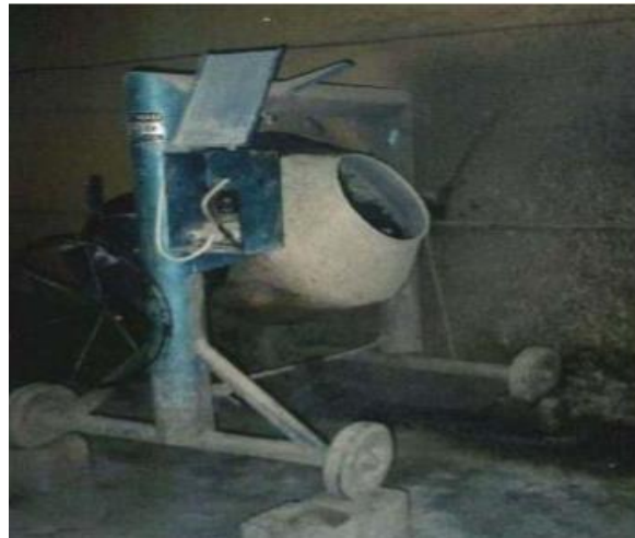
Şekil 2.45. Betonların hazırlanmasında kullanılan betoniye
