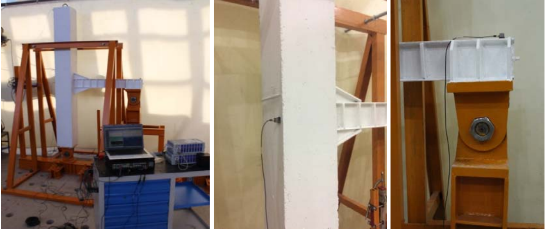
Şekil 3.117. Hasarsız KKB-E elemanın çevresel titreşim testine ait bazı görünüm
