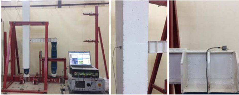
Şekil 3.84. Hasarsız KKB-B elemanının çevresel titreşim testine ait bazı görünüşler
