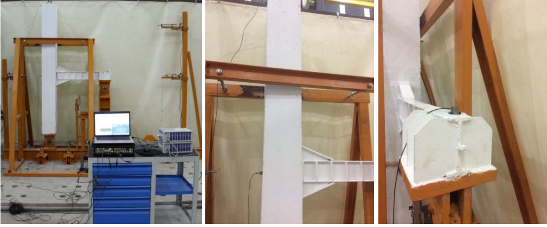
Şekil 3.139. Hasarsız KKB-G elemanın çevresel titreşim testine ait bazı görünüm
