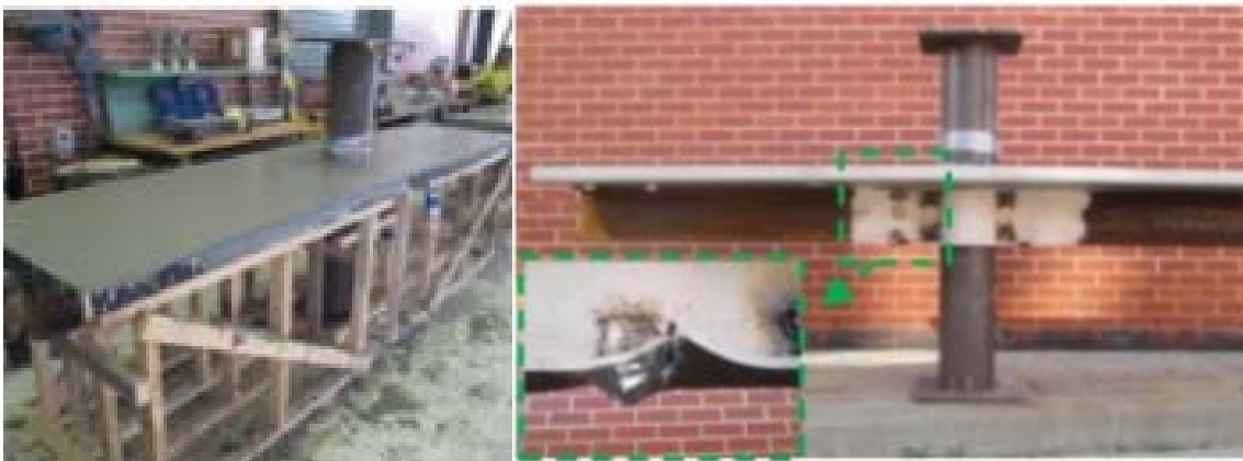
Şekil 1.32. Kompozit kolon-kompozite kiriş için önerilen iç diyaframlı birleşim elemanı (Li vd., 2017)
