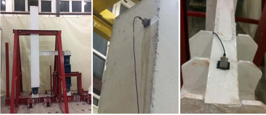
Şekil 3.95. Hasarsız KKB-C elemanın çevresel titreşim testine ait bazı görünüm
