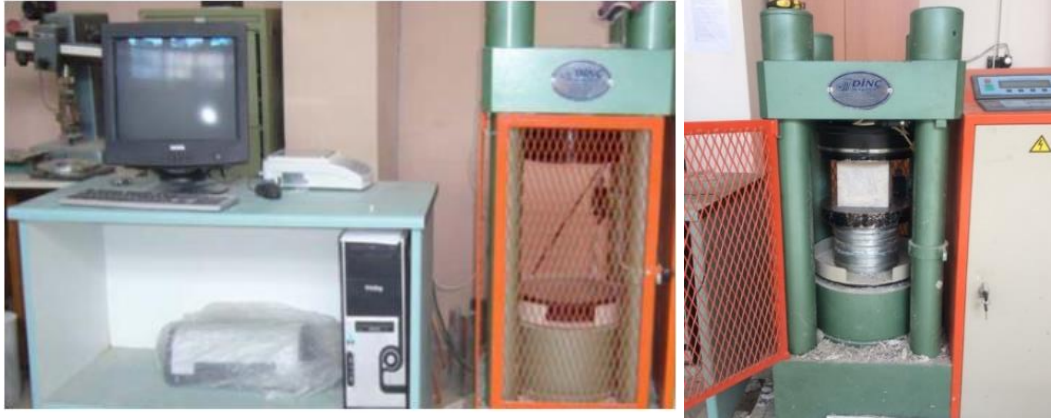
Şekil 2.44. 2500 kN kapasiteli otomatik yükleme makinesi ile basınç deneyi
