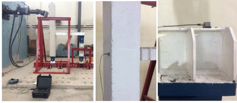
Şekil 3.73. Hasarsız KKB-A elemanın çevresel titreşim testine ait bazı görünüşler
