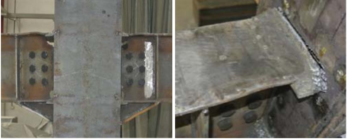
Şekil 1.22. Beton dolgulu kompozit kolon-guseli çelik kiriş birleşim bölgesinin kırılma şekli (Lu vd., 2017)
