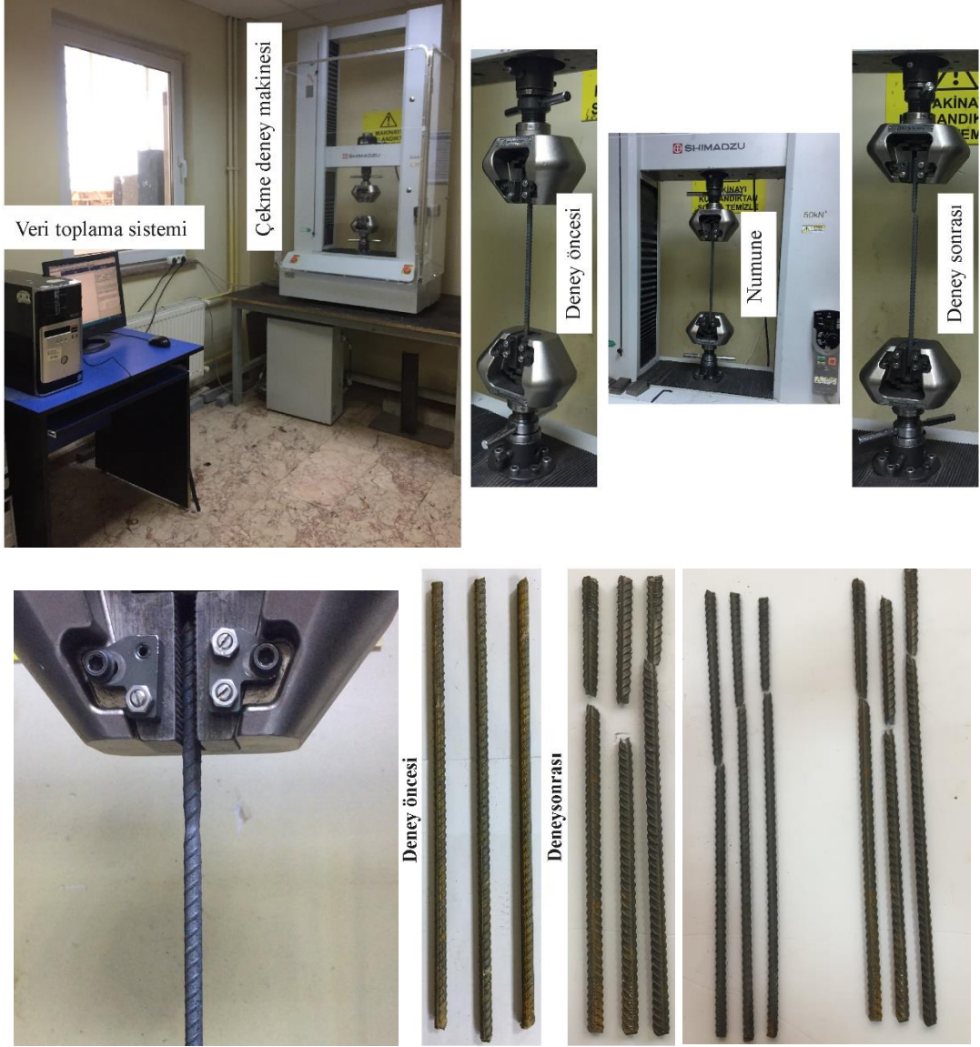
Şekil 2.41. Donatıların merkezi çekme deneylerine ait bazı görüntüler
