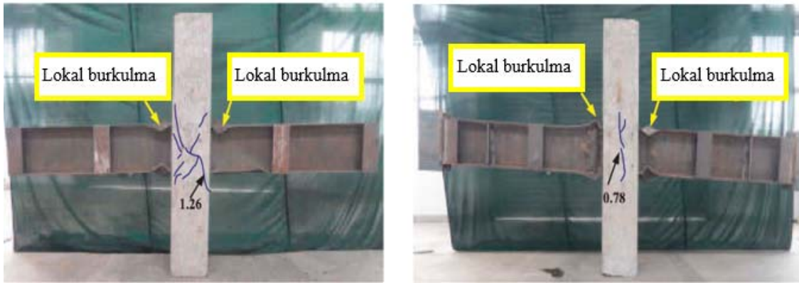
Şekil 1.21. Kompozit kolon kiriş birleşim bölgesinin detayı (Liao vd., 2014)
