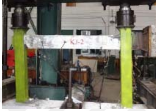
Şekil 1.33. Kompozit kolon –betonarme kirişli çerçeve deney elemanı (Liv vd., 2018)
