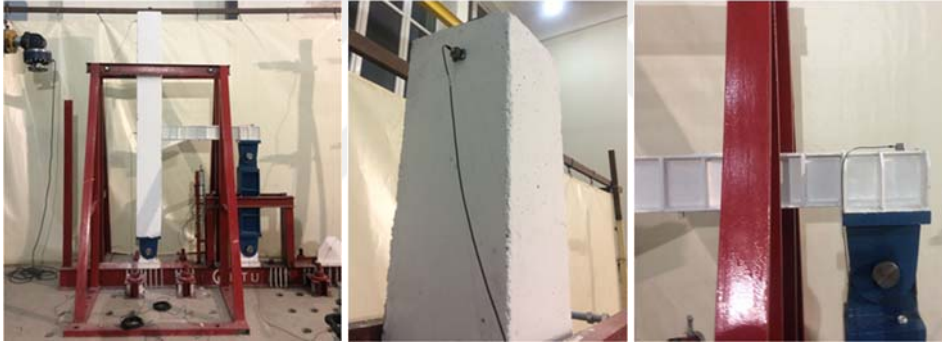
Şekil 3.106. Hasarsız KKB-D elemanının çevresel titreşim testine ait bazı görünüm
