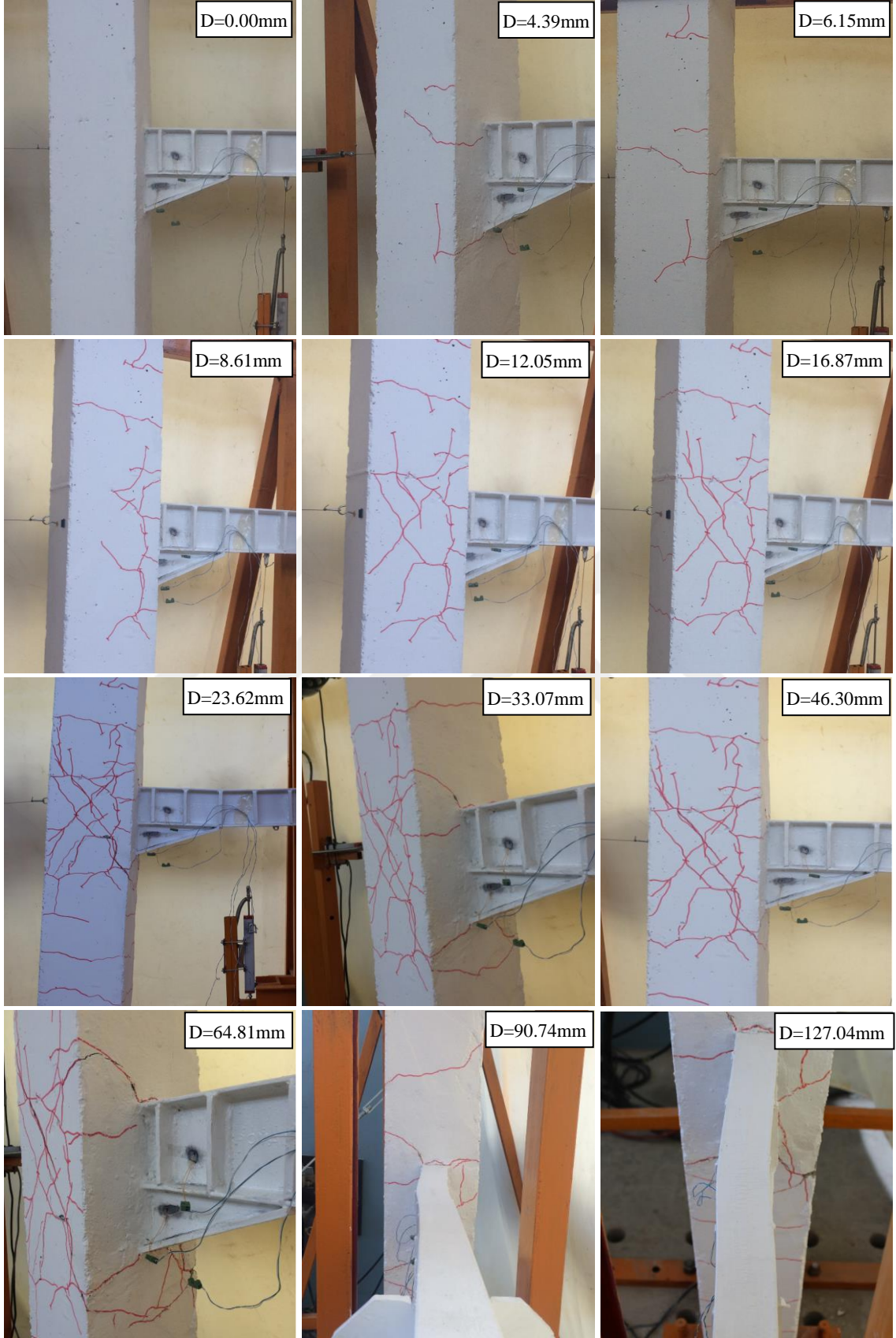
Şekil 3.23. Deney sırasında KKB-F deney elemanında oluşan çatlakların ilerleme aşamaları
