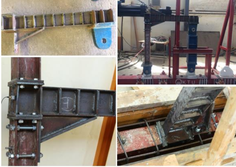
Şekil 2.26. KKB-F elemanına ait imalat görünümleri
