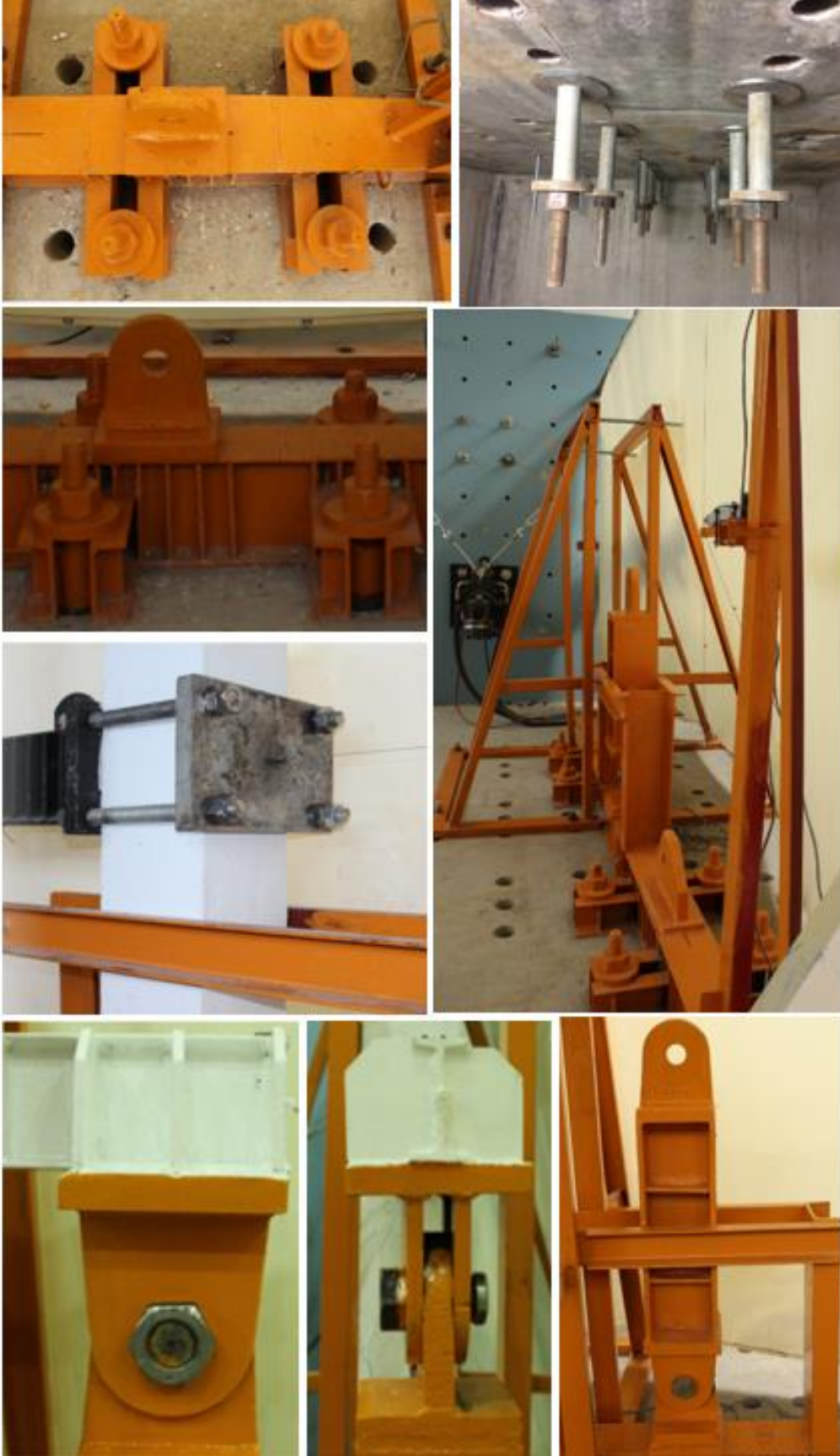
Şekil 2.57. Deney düzeneğinin mesnetlenme detayları
