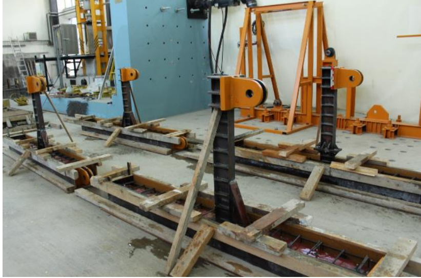
Şekil 2.47. Betona dökümüne hazır hale getirilen KKB-E, KKB-F, KKB-G ve KKB-H deney elemanları
