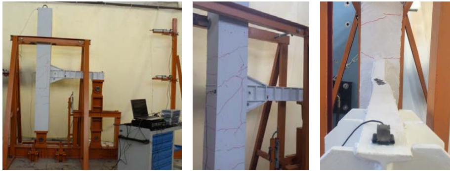
Şekil 3.121. Hasarlı KKB-E elemanın çevresel titreşim testinden bazı görünümler
