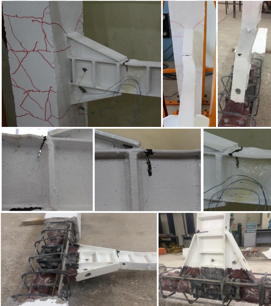
Şekil 3.29. Deney sonunda KKB-G deney elemanında oluşan hasar durumları
