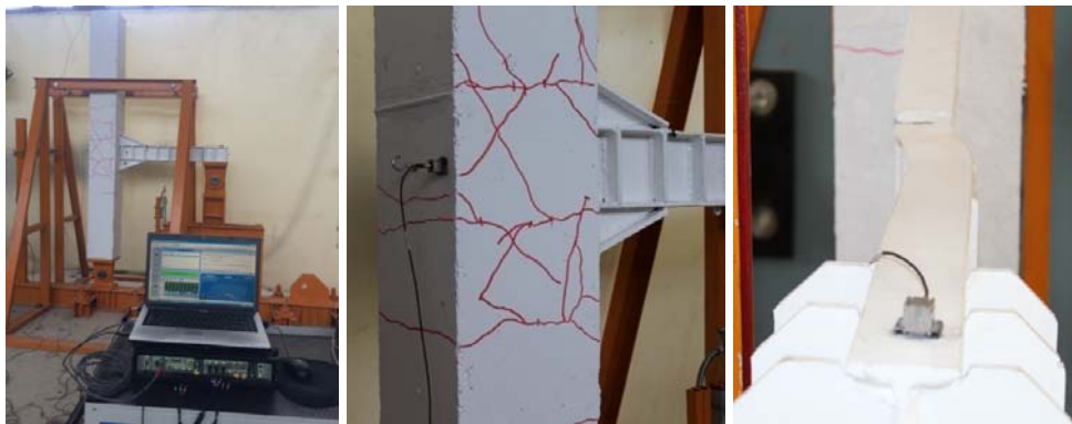
Şekil 3.143. Hasarlı KKB-G elemanın çevresel titreşim testinden bazı görünümler
