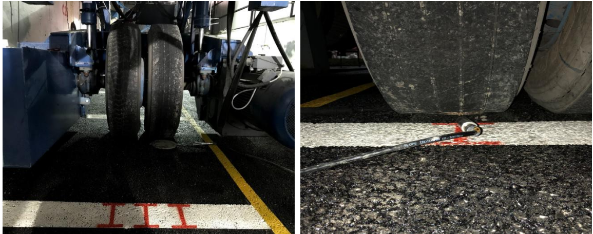
Şekil 2.43. Asfalt kaplama yüzeyine uygulanan basınç değerinin ölçülmesi
