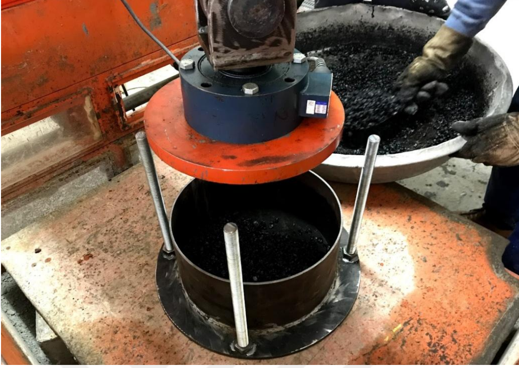
Şekil 2.4. Asfalt karışımın hazırlanıp kalıba konulması
