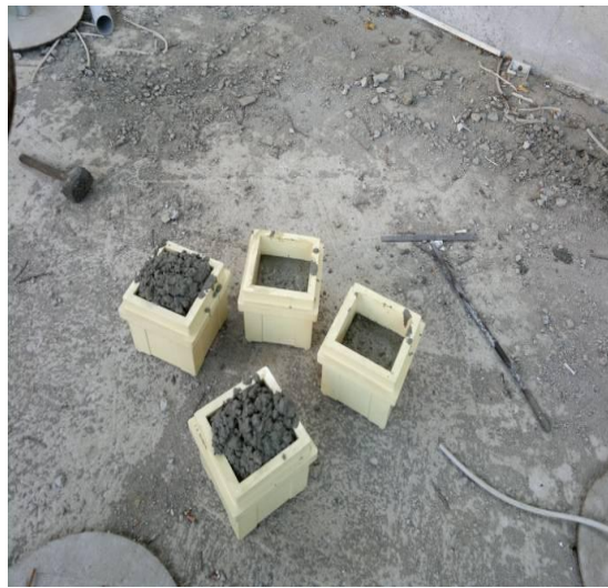
Şekil 3.11. Betondan alınan küp numuneler
