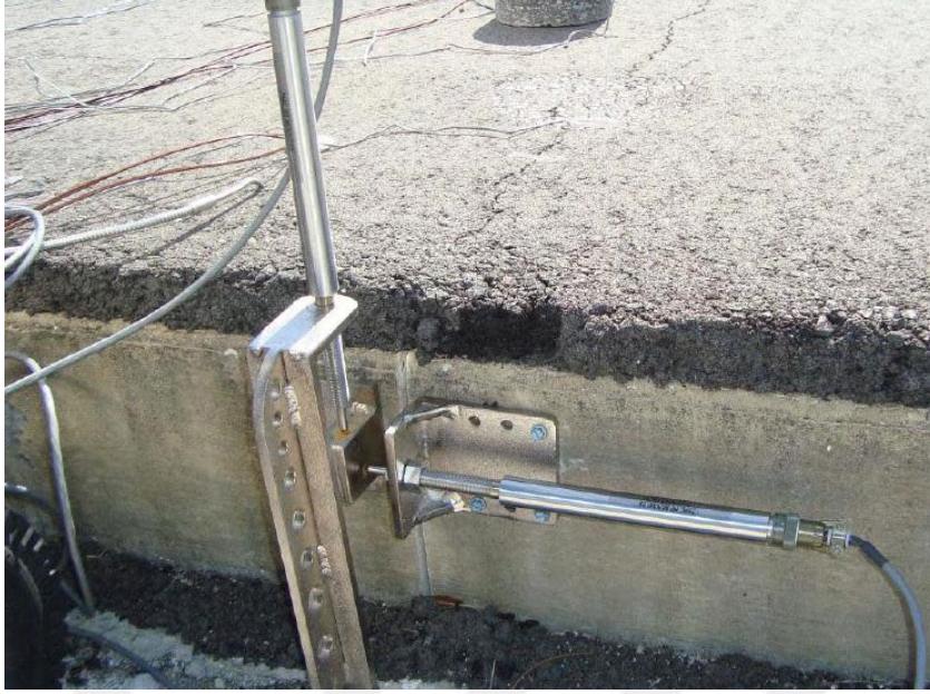
Şekil 1.30. Yol kaplamalarında yatay ve düşey hareketleri ölçmede kullanılan LVDT'ler (FDOT Office, 2011).
