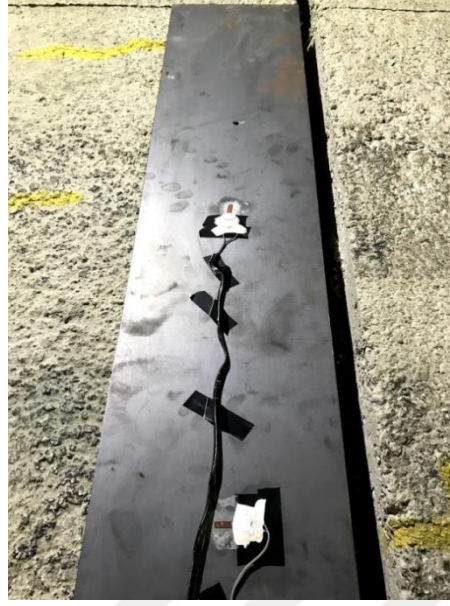
Şekil 2.26. SG pullarının çelik levhaya yapıştırılması
