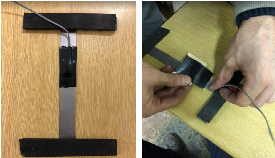
Şekil 2.2. Çelik levha türündeki SG-1 tasarımı
