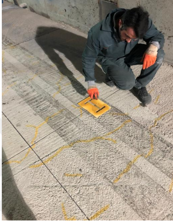
Şekil 2.29. BŞD ölçer yerlerinin işaretlenmesi
