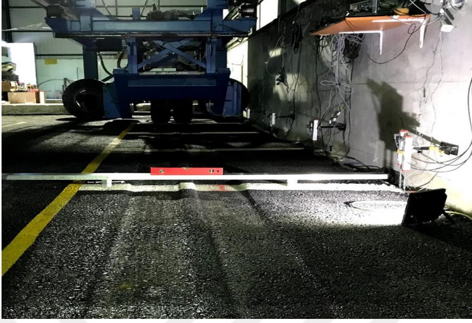
Şekil 2.45. Teraziye alınan çelik masterlarla tekerlek izi oluşumunun ölçülmesi
