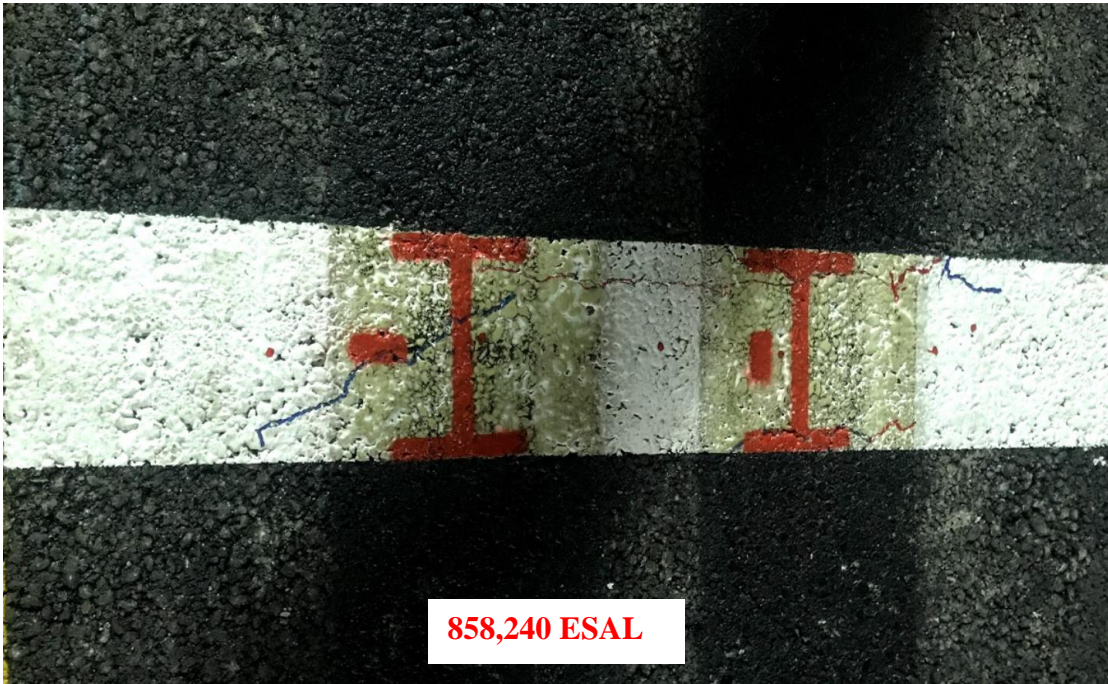
Şekil 3.55. Doğu şeridi (SP) 3. derzde yansımaya çatlağı son hali
