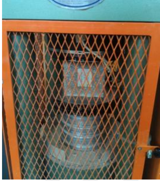
Şekil 3.12. Küp numunelerin kırılması
