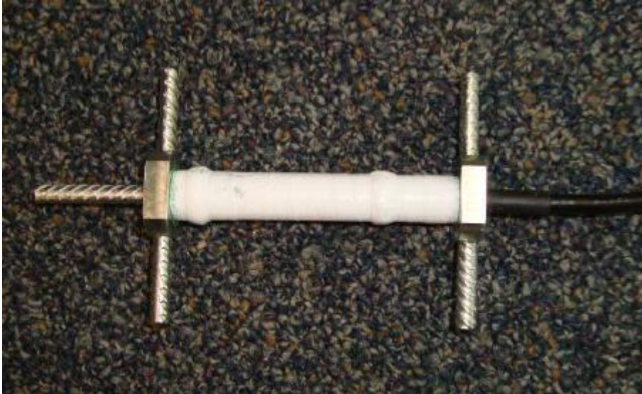
Şekil 1.26. Tokyo Sokki KM-100HAS H-BŞD ölçer (FDOT Office, 2011).
