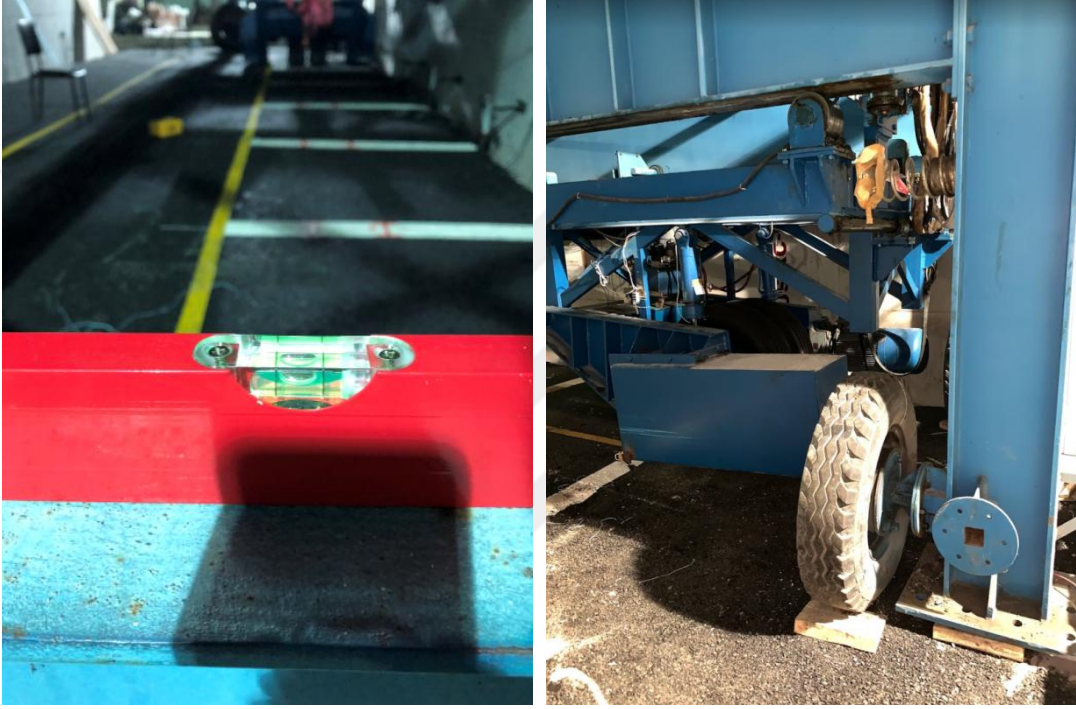
Şekil 2.42. HYT aracının teraziye alınması ve dış lastiklerin havasının indirilerek çelik ayakların üzerine oturtulması
