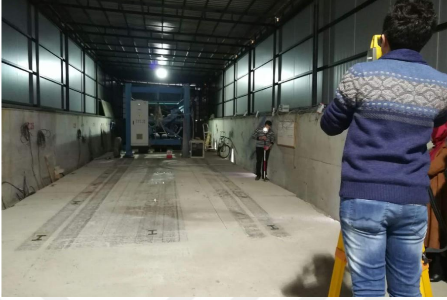
Şekil 2.18. BŞD ölçerlerin total station ile yerlerinin belirlenmesi
