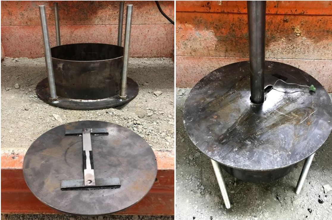
Şekil 2.3. Çelik silindir asfalt kalıbı ve BŞD ölçer aparatı
