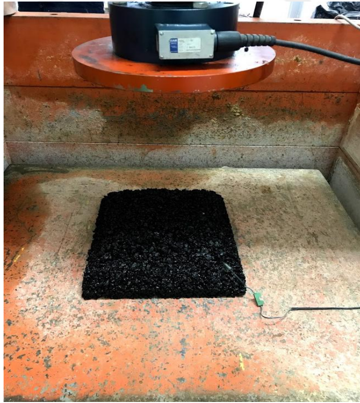
Şekil 3.1. Asfalt kaplama numunelerinin plaka yükleme deneyinde sıkıştırılması
