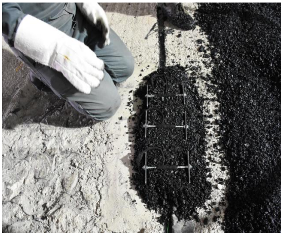
Şekil 2.35. BŞD ölçerlerin ve basınç ölçerlerin tabanının asfalt kaplama ile desteklenilmesi
