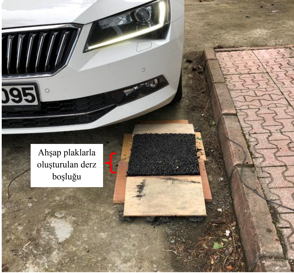
Şekil 3.5. Ahşap plaklar üzerindeki asfalt numunenin otomobil ile yüklenmesi
