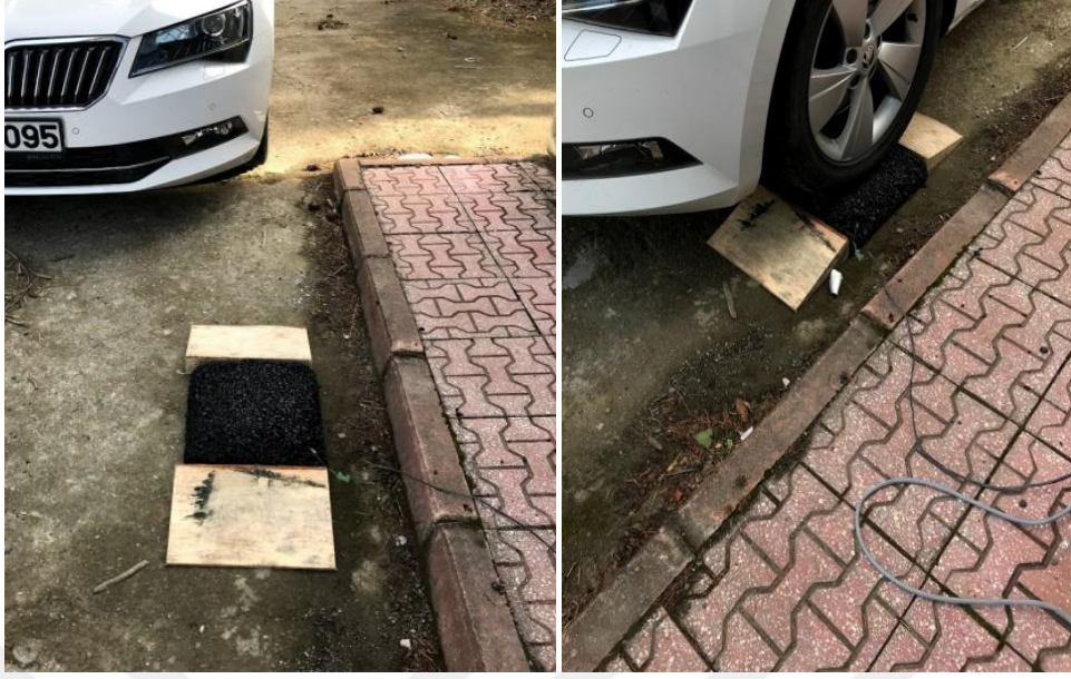
Şekil 2.8. Hazırlanan asfalt numunesine otomobil yükünün uygulanması
