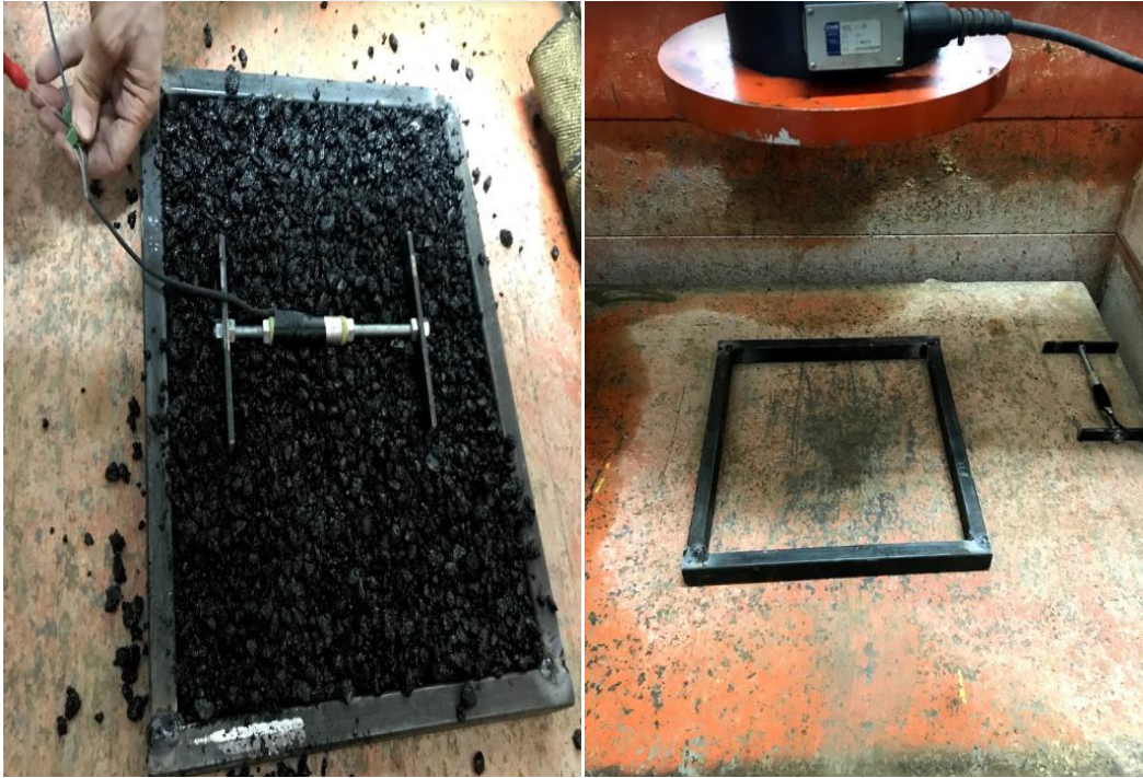
Şekil 2.7. Yeni asfalt kalıbının tasarımı
