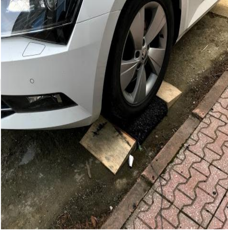
Şekil 3.3. Beton kaplama üzerindeki asfalt numunenin otomobil ile yüklenmesi
