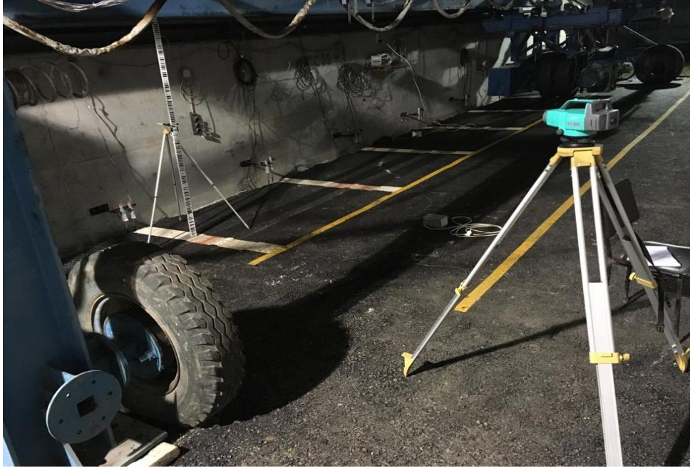
Şekil 2.46. Sokkia marka SDL serisi dijital nivo aletinin kullanılması
