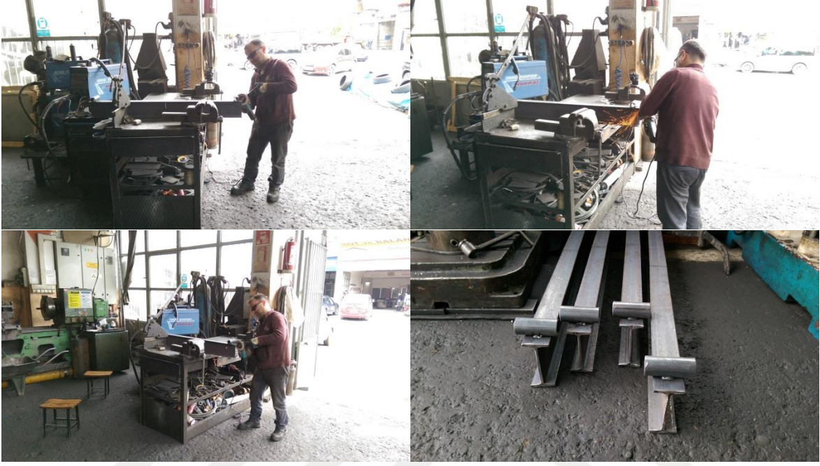
Şekil 2.54. Yüzey pürüzlülüğün yüzey zımparalama işlemi ile giderilme aşaması
