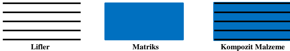
Şekil 2.77. Lifli polimer kompozit malzemenin genel yapısı
