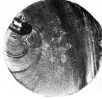
Şekil 1.11. Bir AISI 8640 milinin yorulma kırılma yüzeyi (ASM Handbook, Fractography, 1987).
