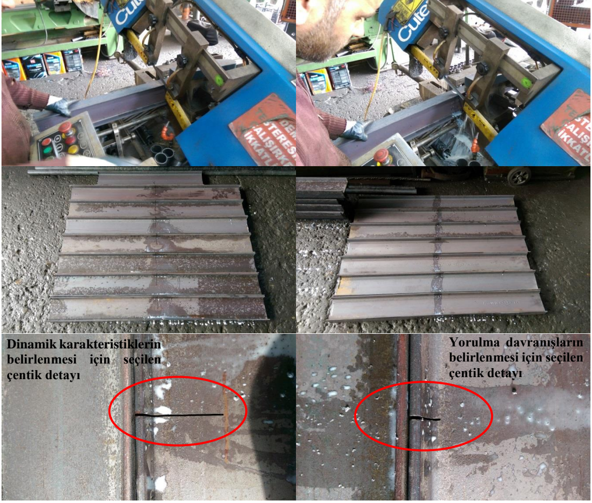
Şekil 2.52. Kirişler üzerinde çentiklerin oluşturulma aşaması
