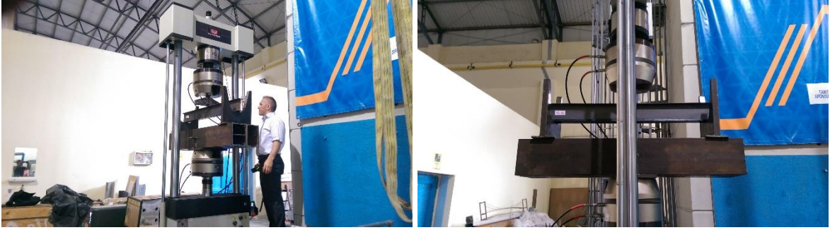
Şekil 2.86. YD_N2 için yapılan yorulma testi
