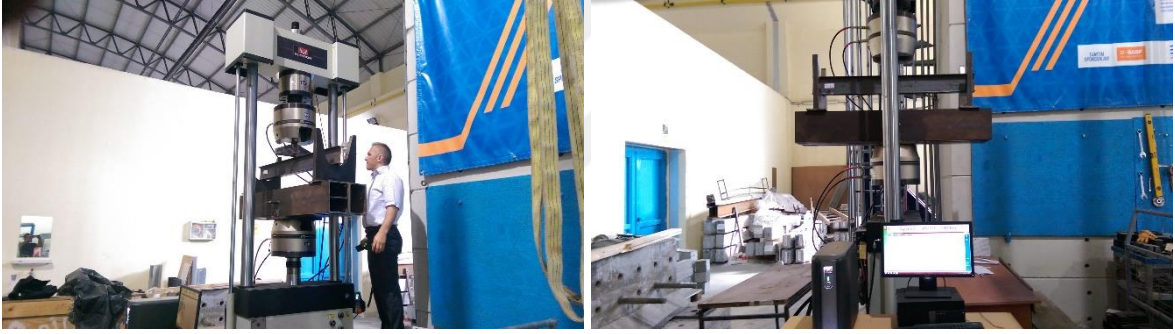
Şekil 2.104. YD_N4 için yapılan yorulma testi
