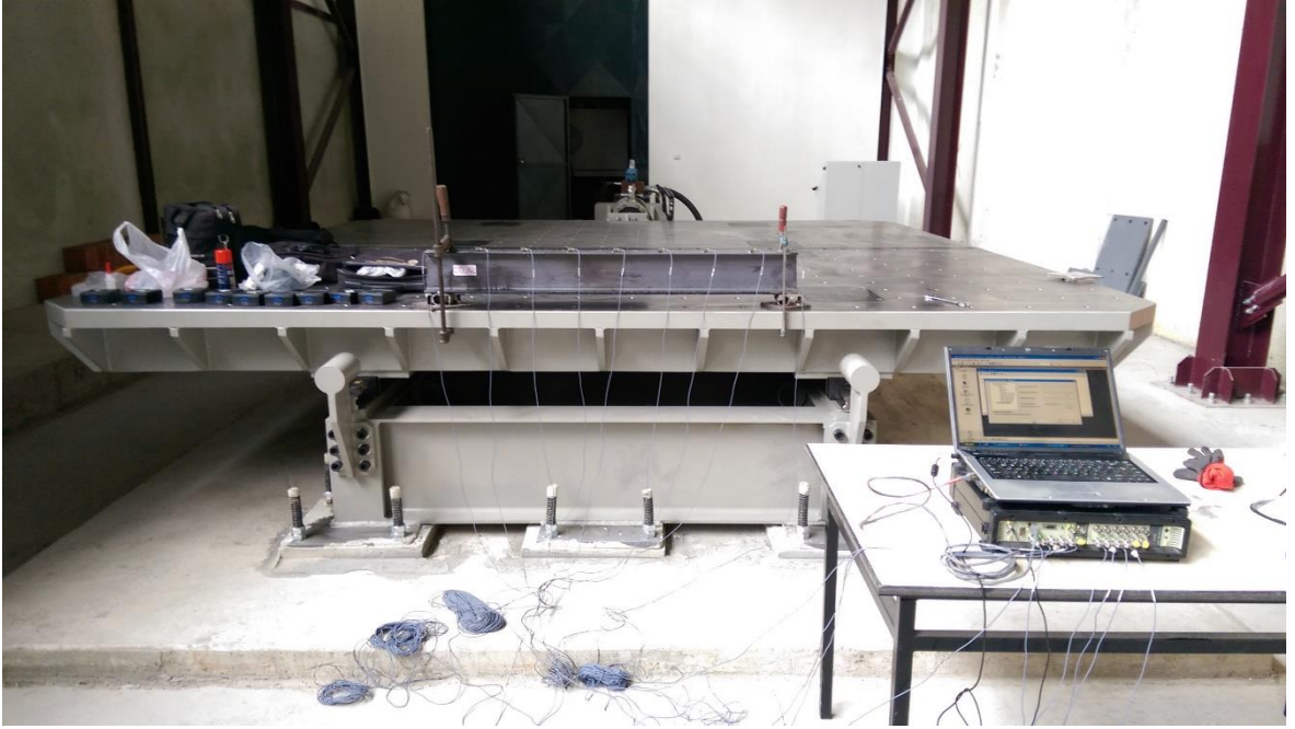
Şekil 2.90. DD_N4 için yapılan çevrimsel titreşim testi
