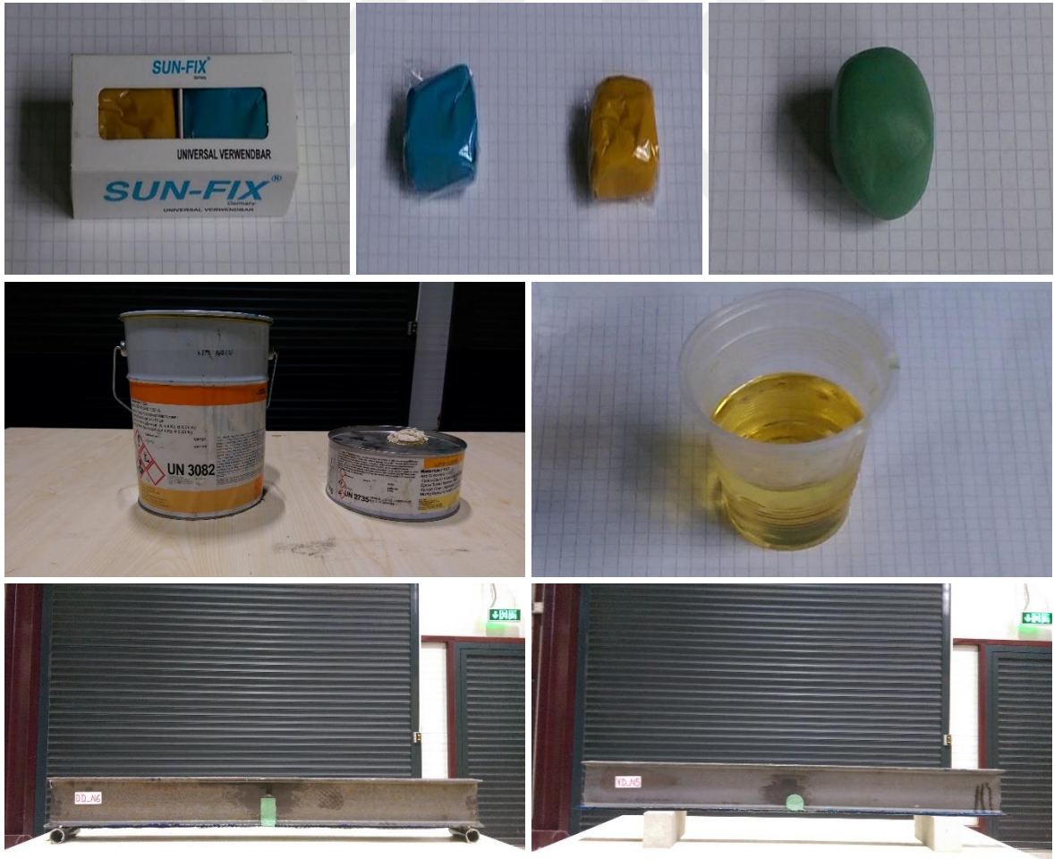
Şekil 2.107. Epoksi esaslı dolgu malzemesi ile onarım ve KFTP kumaş ile güçlendirme uygulaması
