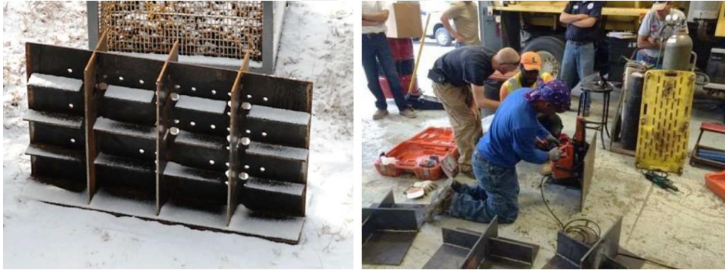
Şekil 1.61. Bir onarım ve/veya güçlendirme projesinin uygulanmasından önceki performans testi (Connor ve Lloyd, 2017).
