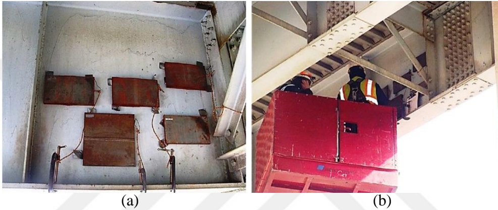
Şekil 1.62. (a) Bir köprüye yerleştirilmiş kaynaklı çelik test numuneleri, (b) köprü kaynaklarında tahribatsız muayene testlerine başlamadan önce bir teknisyenin performans testi (Connor ve Lloyd, 2017).
