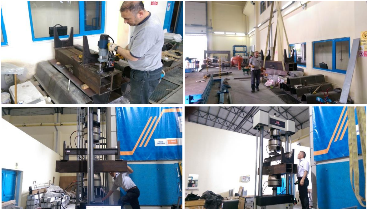
Şekil 2.73. Numunelerin mesnetleneceği alt tabanlığın hazırlanması ve yerine yerleştirilmesi
