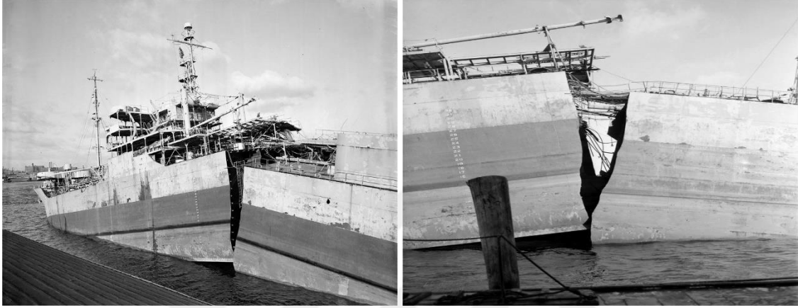
Şekil 1.39. Gövdesinden kırılarak hasara uğramış bir özgürlük gemisi (URL-3, 2018).
