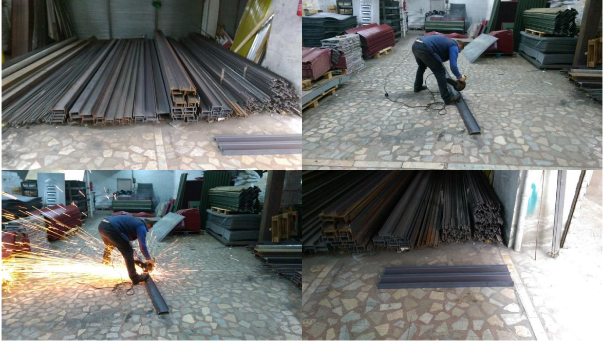
Şekil 2.51. Profillerin kesilmesi ile deneysel numunelerin hazırlanma aşaması
