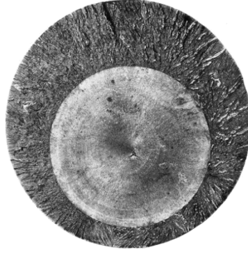
Şekil 1.13. 200 mm çapındaki bir piston kolunun yorulma kırılma yüzeyi (ASM Handbook, Fractography, 1987).
