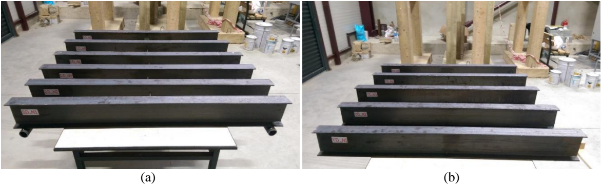
Şekil 2.56. Çalışma kapsamında dikkate alınan farklı tip deney numuneleri, (a) dinamik karakteristikleri belirlenmesi için kullanılan numuneler (b) yorulma davranışlarının belirlenmesi için kullanılan numuneler
