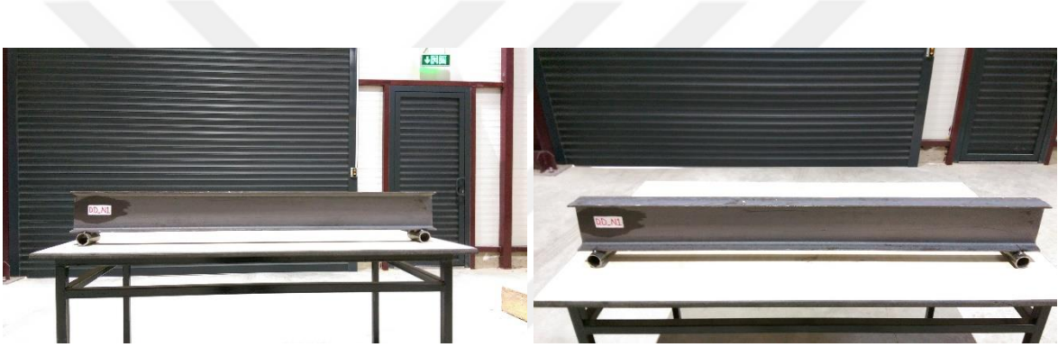
Şekil 2.57. Çentiksiz (hasarsız) kiriş: kontrol numunesi
