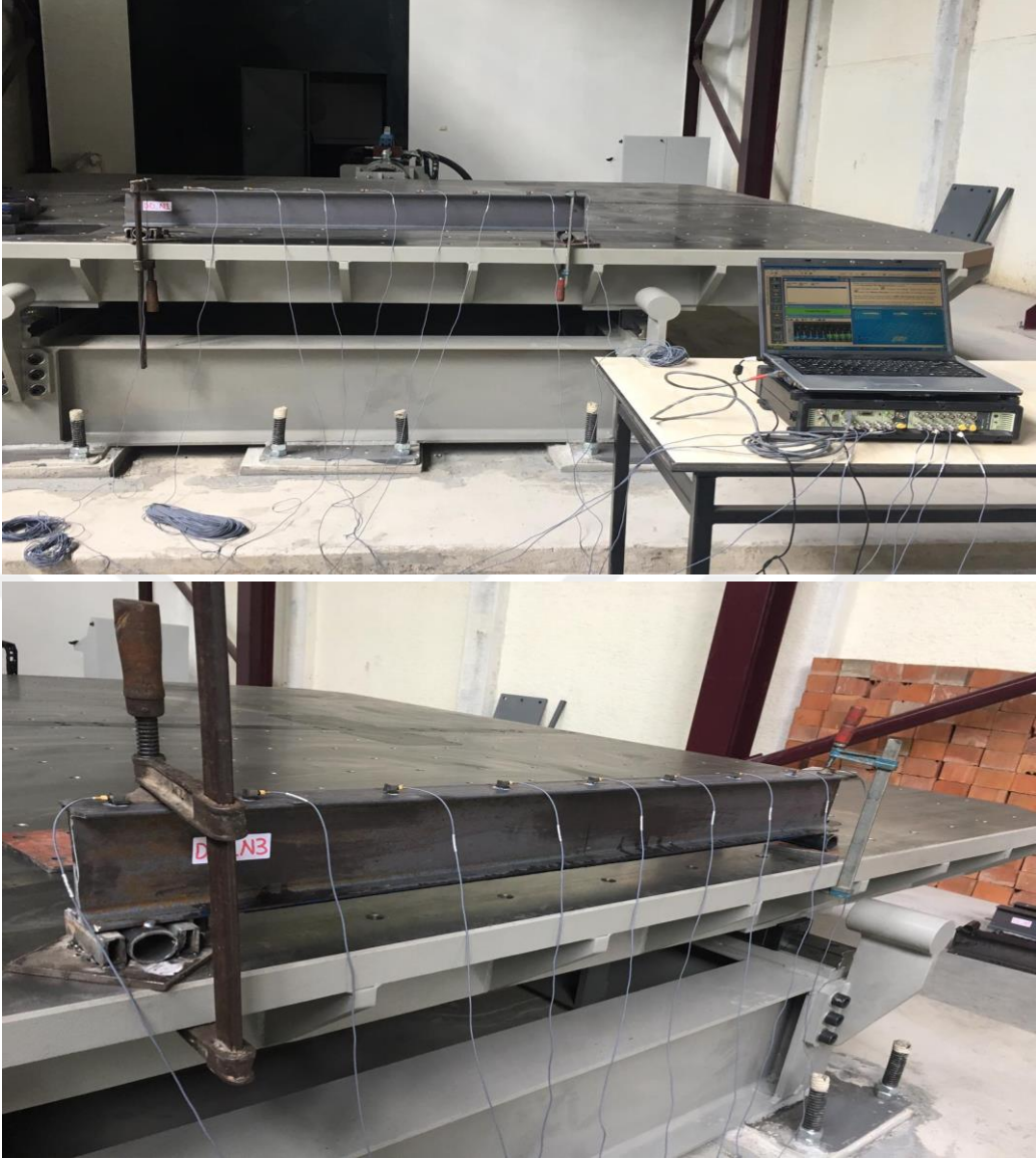
Şekil 2.81. DD_N3 için yapılan çevrimsel titreşim testi
