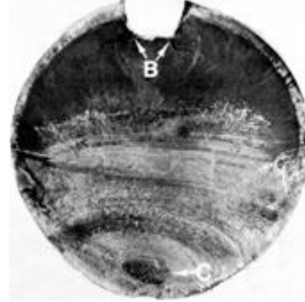
Şekil 1.10. Bir AISI 4320 kardan milinin yorulma kırılma yüzeyi (ASM Handbook, Failure Analysis and Prevention, 2002).
