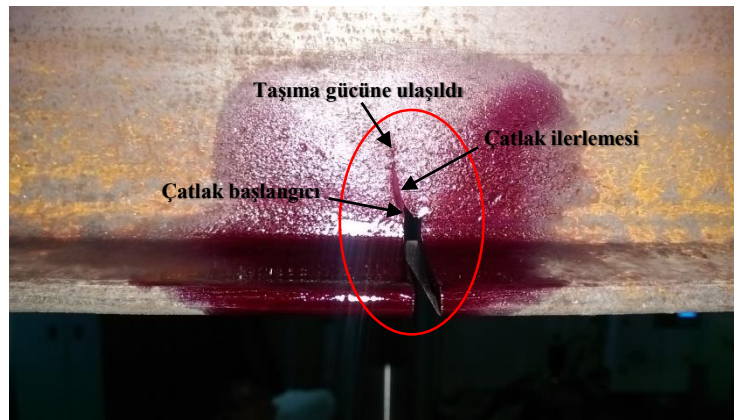
Şekil 2.75. Test sonucunda YD_N1'de oluşan yorulma çatlak durumu
