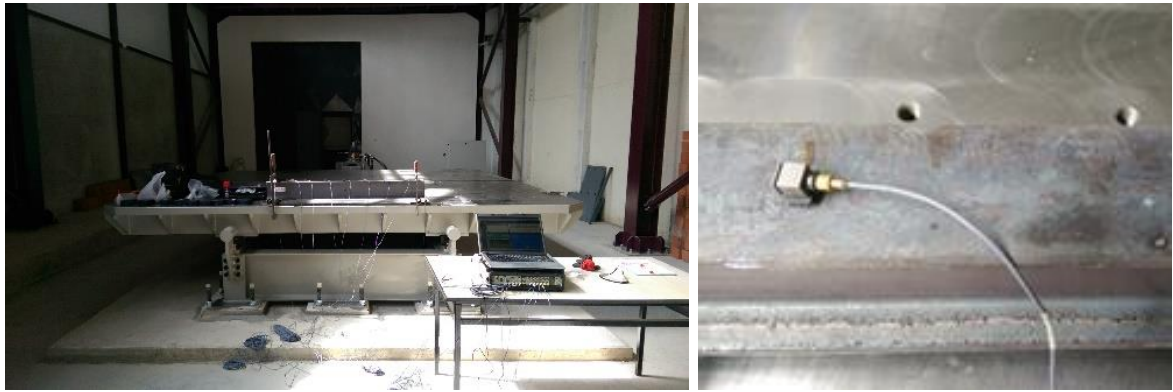
Şekil 2.66. DD_N2 için yapılan çevrimsel titreşim testi
