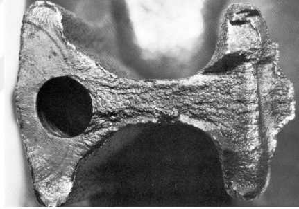
Şekil 1.12. AISI 8640 çeliğinden dövülerek üretilmiş bir bağlantı çubuğunun yorulma kırılma yüzeyi (ASM Handbook, Fractography, 1987).
