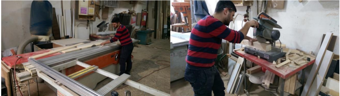
Şekil 2.55. Basit mesnetlenme sınır şartlarını sağlayan alt tabanlıkların yapım aşaması
