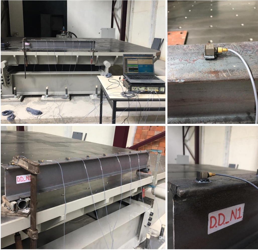
Şekil 2.61. Kontrol numunesi için yapılan çevrimsel titreşim testi
