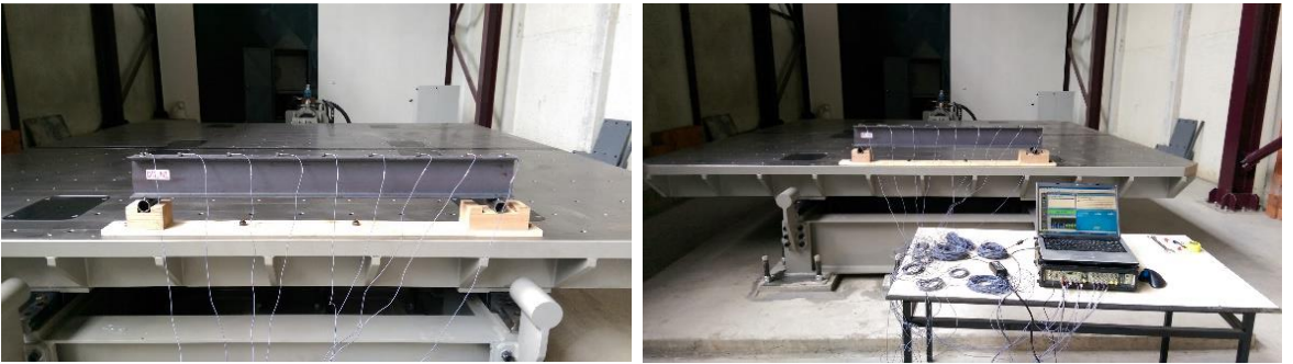
Şekil 2.59. Rijit zemine monte edilmiş ahşap tabanlılık üzerinde yer alan numune üzerinden ölçüm alımı
