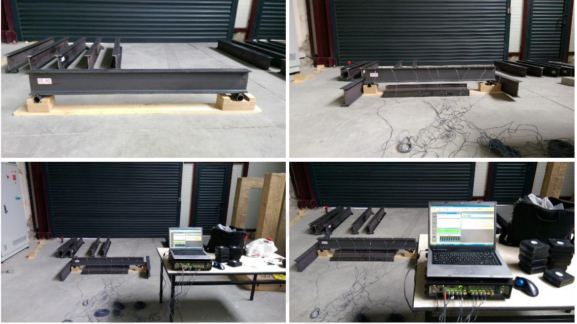
Şekil 2.58. Ahşap tabanlığa yerleştirilmiş numune üzerinden ölçüm alımı
