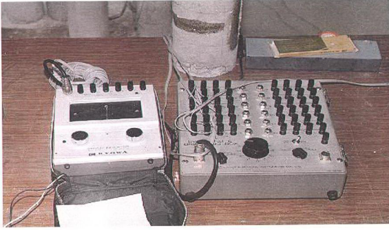
Şekil 2.3. Birim şekildeğiştirme ölçeri ve 12 kanallı Wheatstone köprüsü
