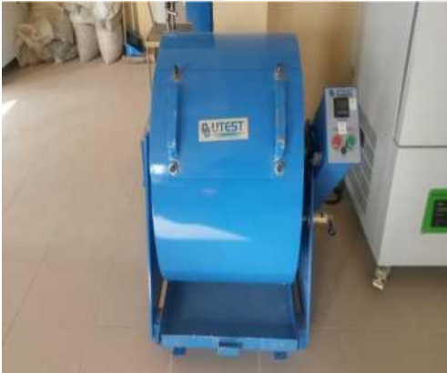
Şekil 38. Los Angeles aşınma cihazı ve deneye tabi tutulmuş numune
