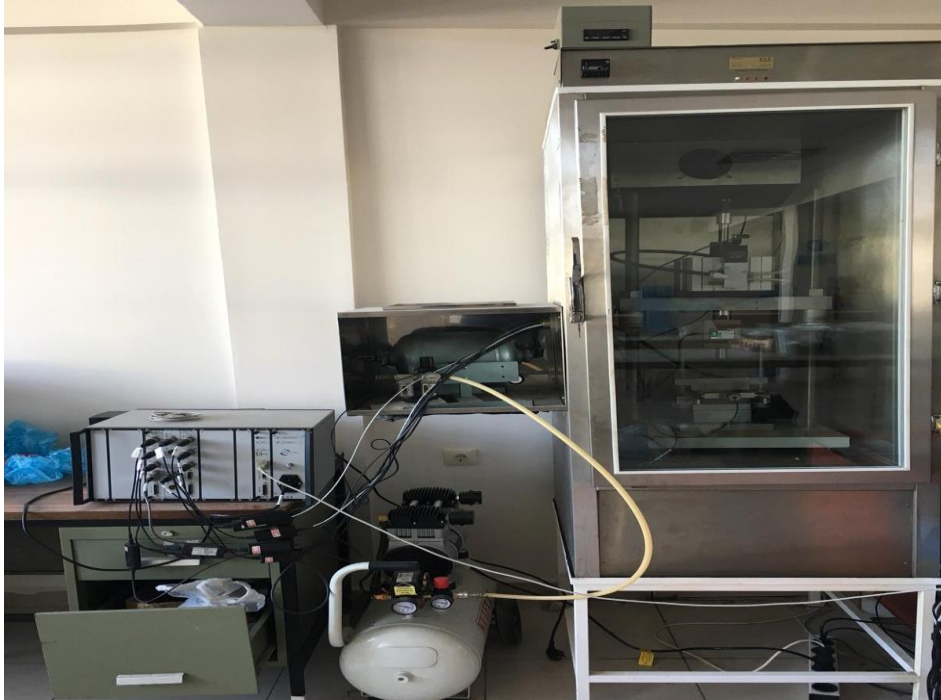
Şekil 50. Rijitlik modülü deney düzeneği (KTÜ Ulaştırma Laboratuvarı)
