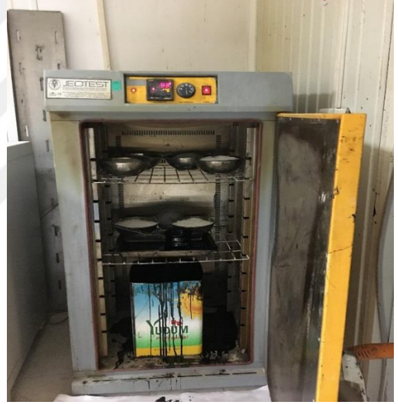
Şekil 52. Karışım numunelerinin hazırlanması Şekil 53. Karışımların etüve konulması
