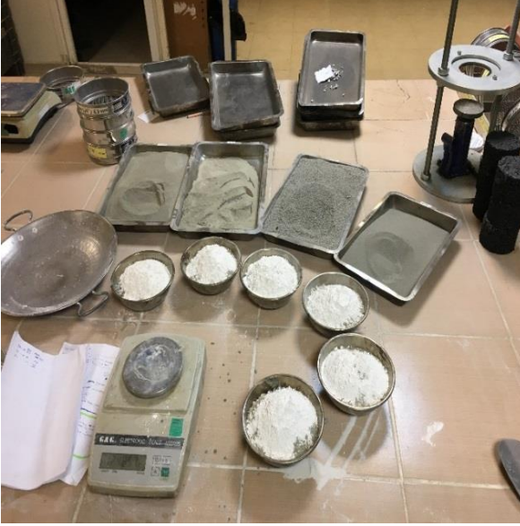
Şekil 52. Karışım numunelerinin hazırlanması Şekil 53. Karışımların etüve konulması
