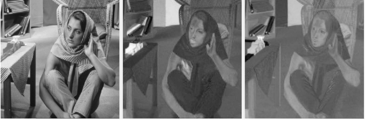
Şekil 1.8. Lab uzayında Barbara imgesi; Parlaklık kanalı (a), a kanalı (b), b kanalı (c)
