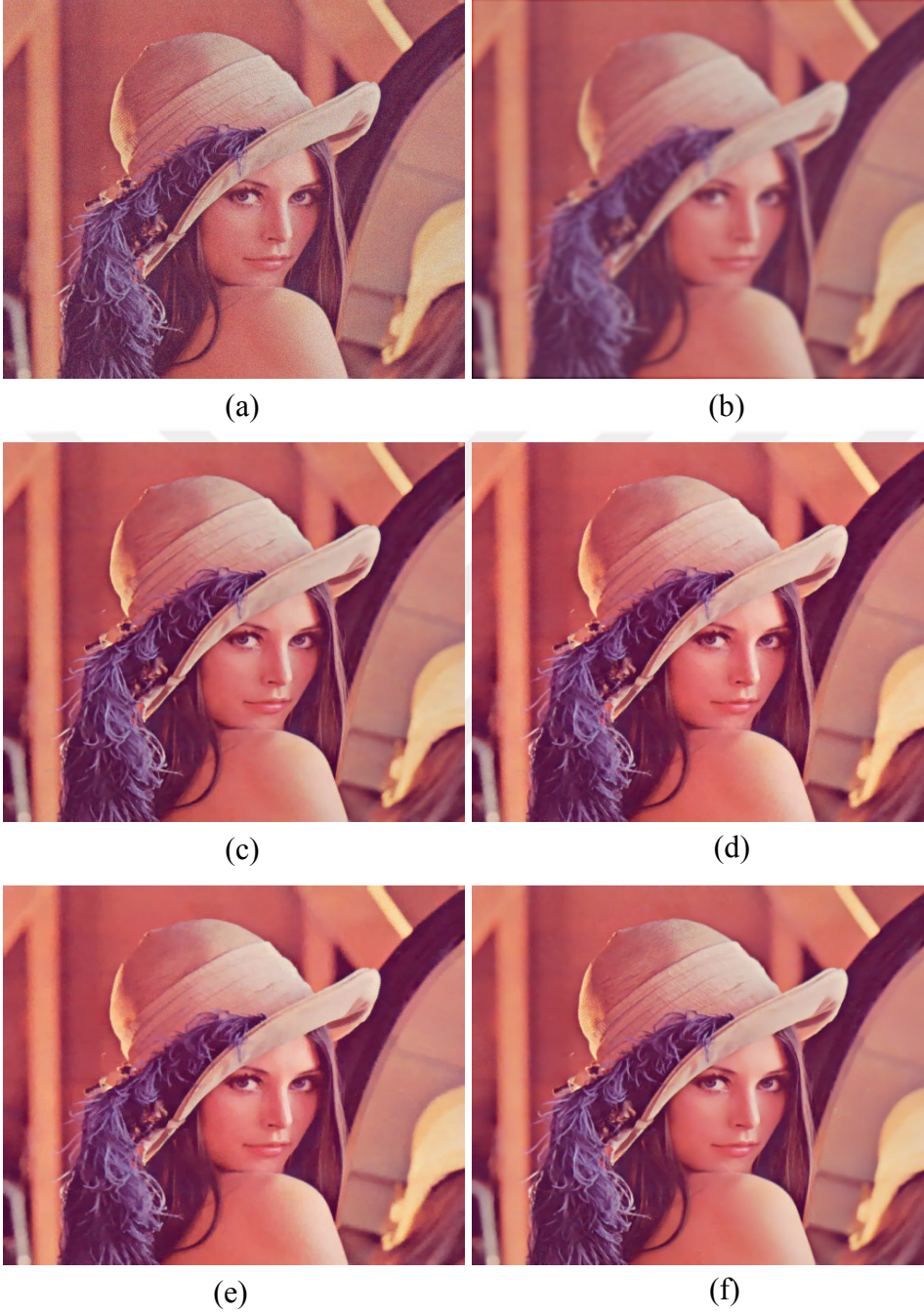
Şekil 2.27. \sigma = 10 Gauss gürültüsü eklenmiş renkli Lena imgesi için gürültü giderme; \sigma = 10 olan Gauss gürültülü imge (a), Perona-Malik [59] (TİGO = 23.65, YBI = 0.70) (b), iz tabanlı yöntem (TİGO = 31.02, YBI = 0.85) [68] (c), Duran [46] (TİGO = 33.24, YBI = 0.88) (d), CTV [47] (TİGO = 33.84, YBI = 0.88) (e), önerilen yöntem (TİGO = 34.70, YBI = 0.92) (f)
