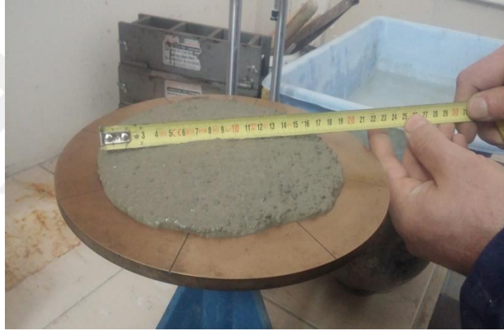
Şekil 36. Harç karışımlarının yayılma çapının ölçülmesi
