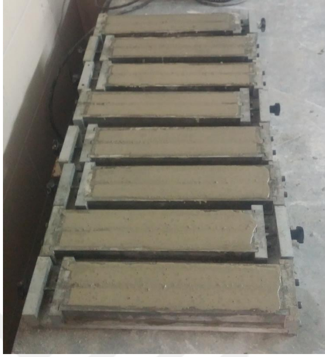
Şekil 37. Hazırlanan harç çubuğu örnekleri
