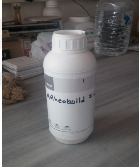
Şekil 33. Üretimlerde kullanılan süperakışkanlaştırıcı katkı maddesi
