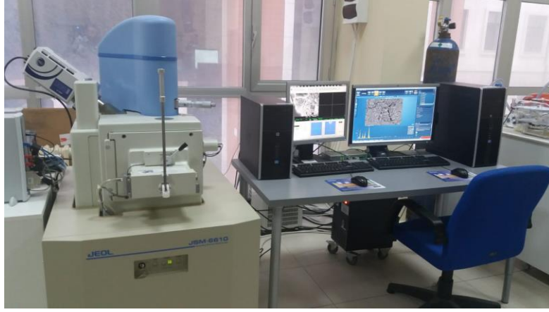
Şekil 51. Analizlerde kullanılan SEM cihazı
