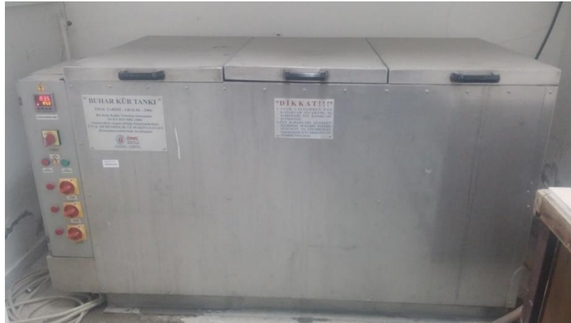
Şekil 39. Buhar kürü için kullanılan kür tankı
