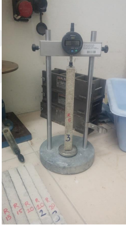
Şekil 41. Boy ölçümleri için kullanılan ölçüm cihazı
