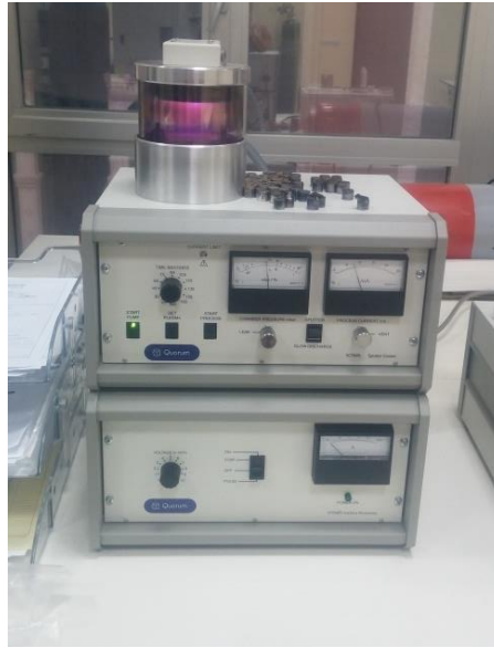
Şekil 50. Örneklerin vakumlanması ve altın kaplanması
