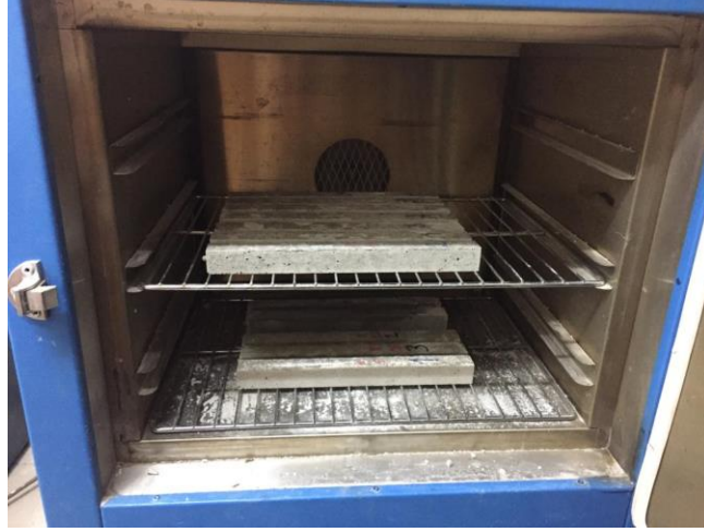
Şekil 42. Numunelerin etüvde kurutulması
