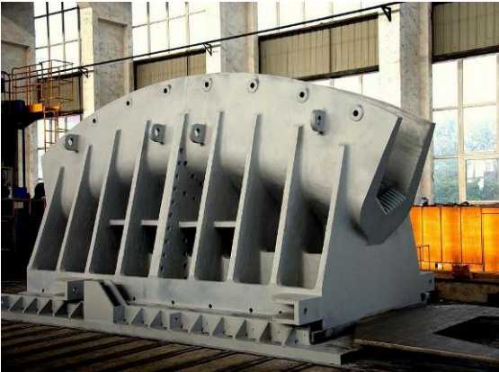
Şekil 1.17. Kule tepelerine inşa edilen eyerler (URL 10-11, 2019).
