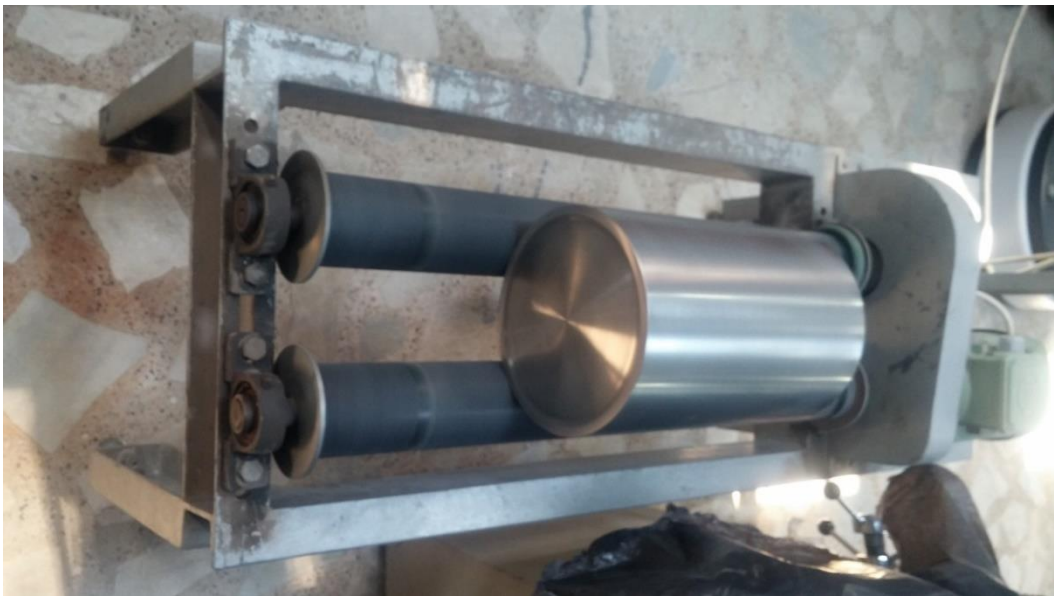
Şekil 2. 5. Kromitin çubuklu silindirde öğütülmesi
