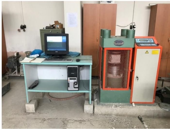
Şekil 2.16. Basınç dayanım deneyi düzeneği
