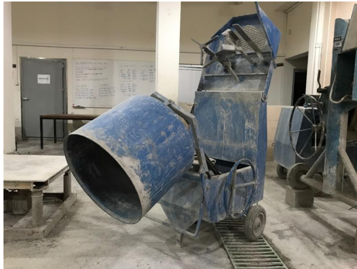
Şekil 2.7. Beton üretiminde kullanılan 60 litre kapasiteli betonyer
