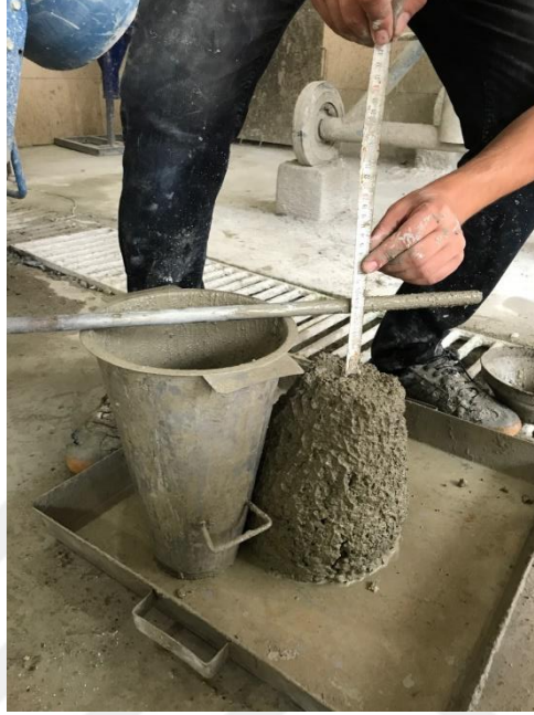
Şekil 2.8. Beton karışımının çökme deneyinden geçirilmesi
