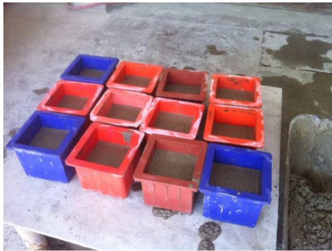
Şekil 2.9. Küp kalıplara titreşim masasında beton yerleştirilmesi
