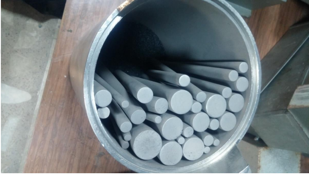
Şekil 2. 4. Çubuklu silindire konulan kromit minerali
