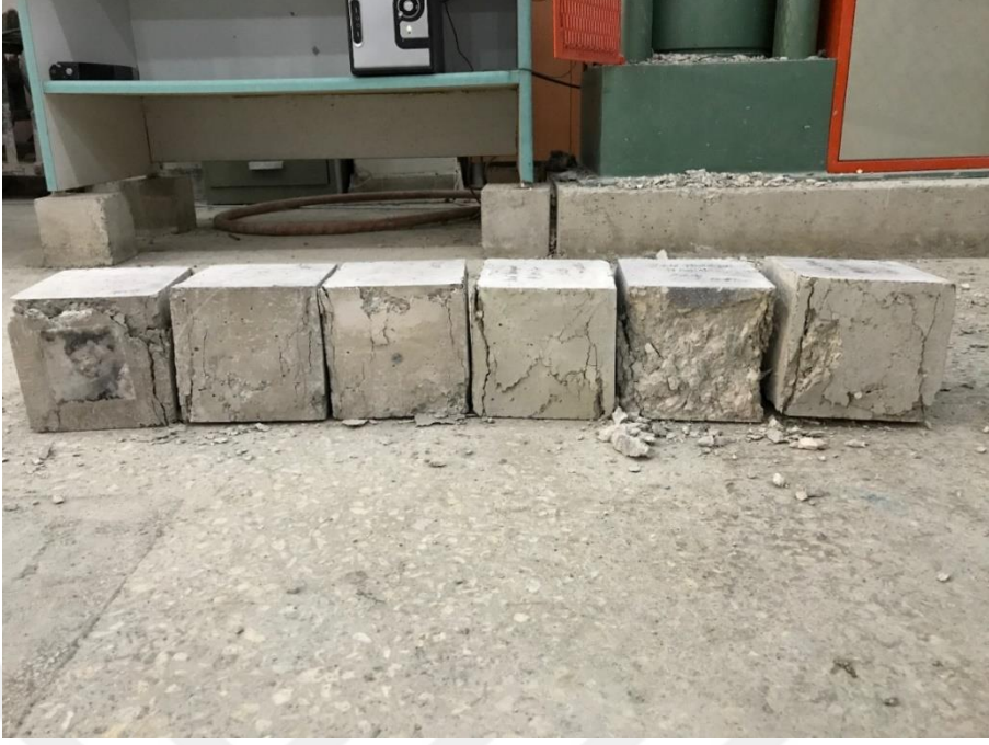
Şekil 2.17. Basınç dayanım deneyinde kırılmış numunelerden örnekler
