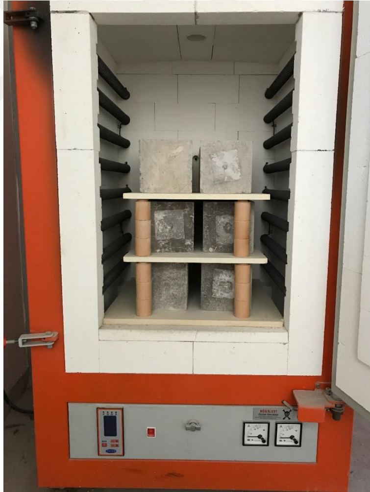
Şekil 2.12. Betonların yüksek sıcaklık etkisine maruz bırakıldıkları fırın düzeneği
