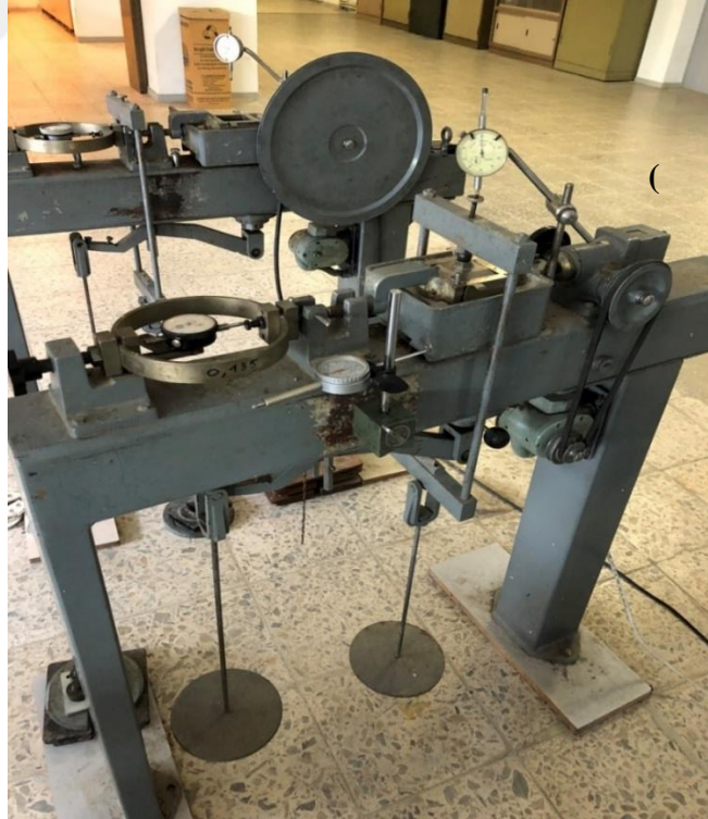
Şekil 12. Kesme kutusu deney düzeneği (sistematik)
