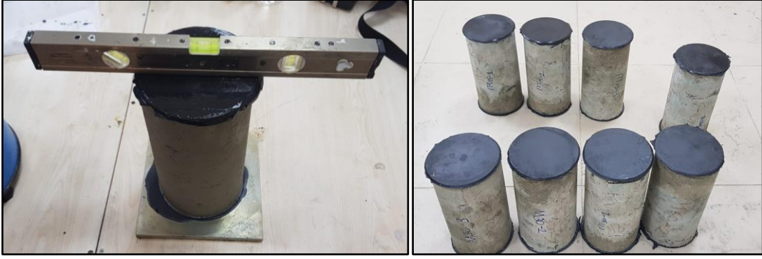
Şekil 2. 17. Silindir numunelere kükürt başlıklar yapımı
