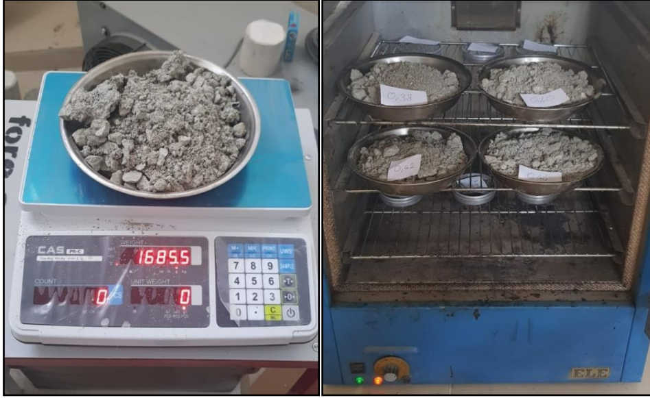
Şekil 2. 6. Örnek numunelerin tartılması ve etüvde kurutulması
