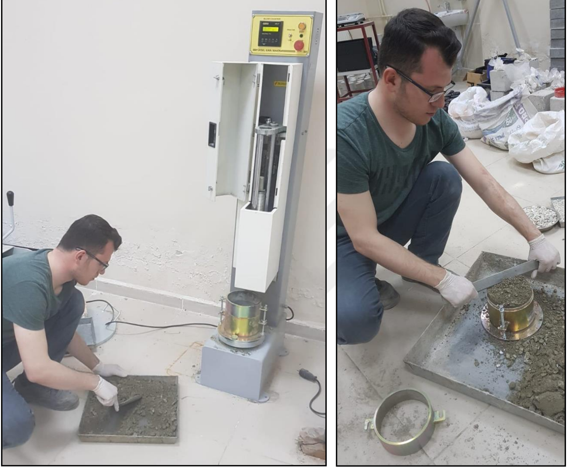
Şekil 2. 5. Modifiye proktor deney aleti ve testi
