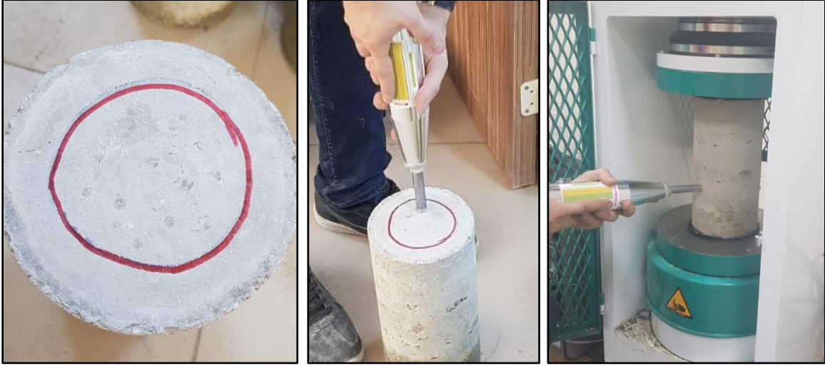
Şekil 2. 23. Silindir numunelerde schmidt geri sıçrama (schmidt sertliği) sertliğinin tayini
