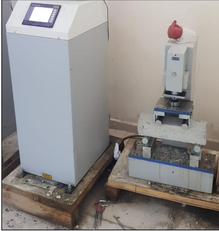
Şekil 2. 19. Eğilme deneyi cihazı
