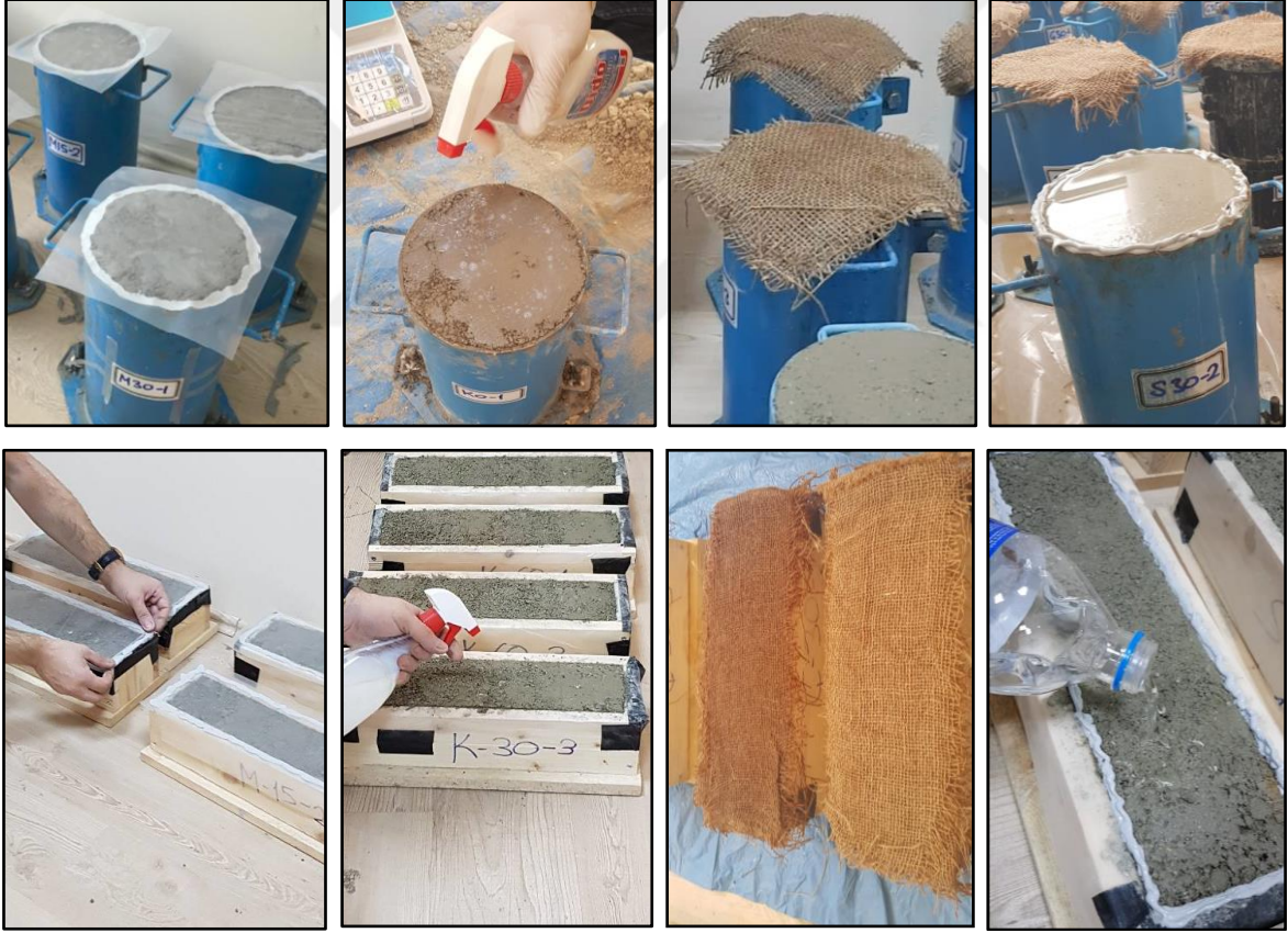
Şekil 2. 16. Numunelere kür uygulanması
