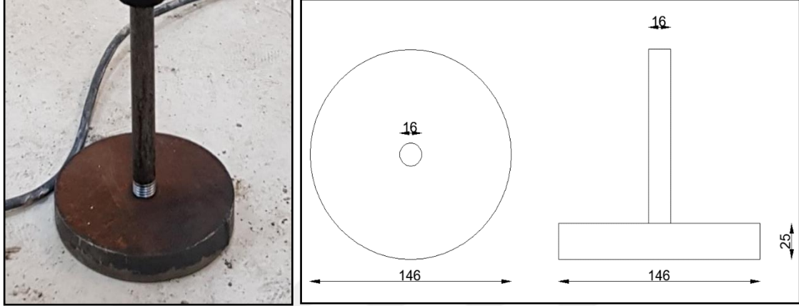
Şekil 2. 12. Silindir numunelerin sıkıştırma işleminde kullanılan sıkıştırma plakası
