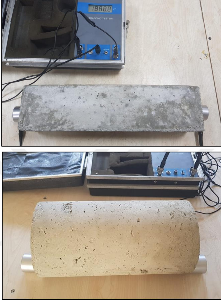
Şekil 2. 21. Ultrases geçiş hızı deneyi ve deney aleti
