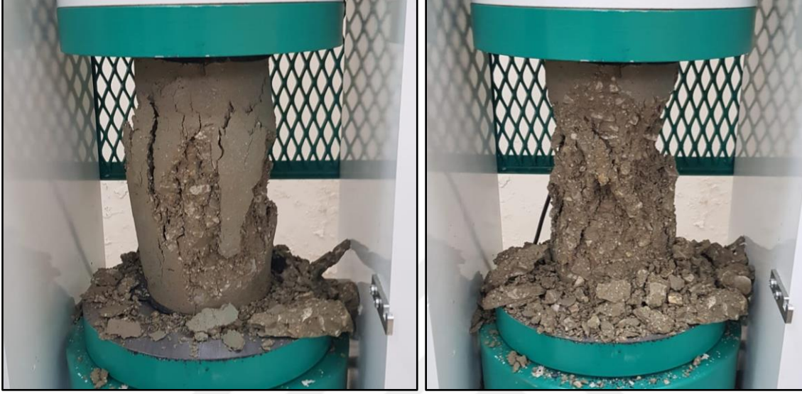
Şekil 3. 4. 2 saatlik numunelerin kırılma şekli
