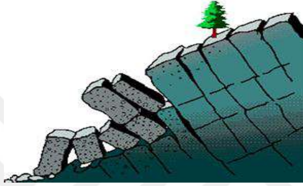
Şekil 1.8. Devrilme tipi hareket
