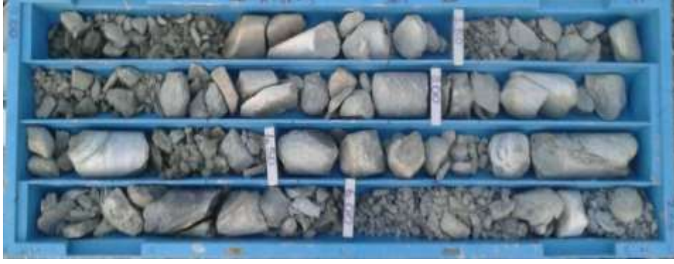
Şekil 2.4. HYSK-5/ 0.0-7.0 m arası kumtaşı blok-çakıllardan görünüm
