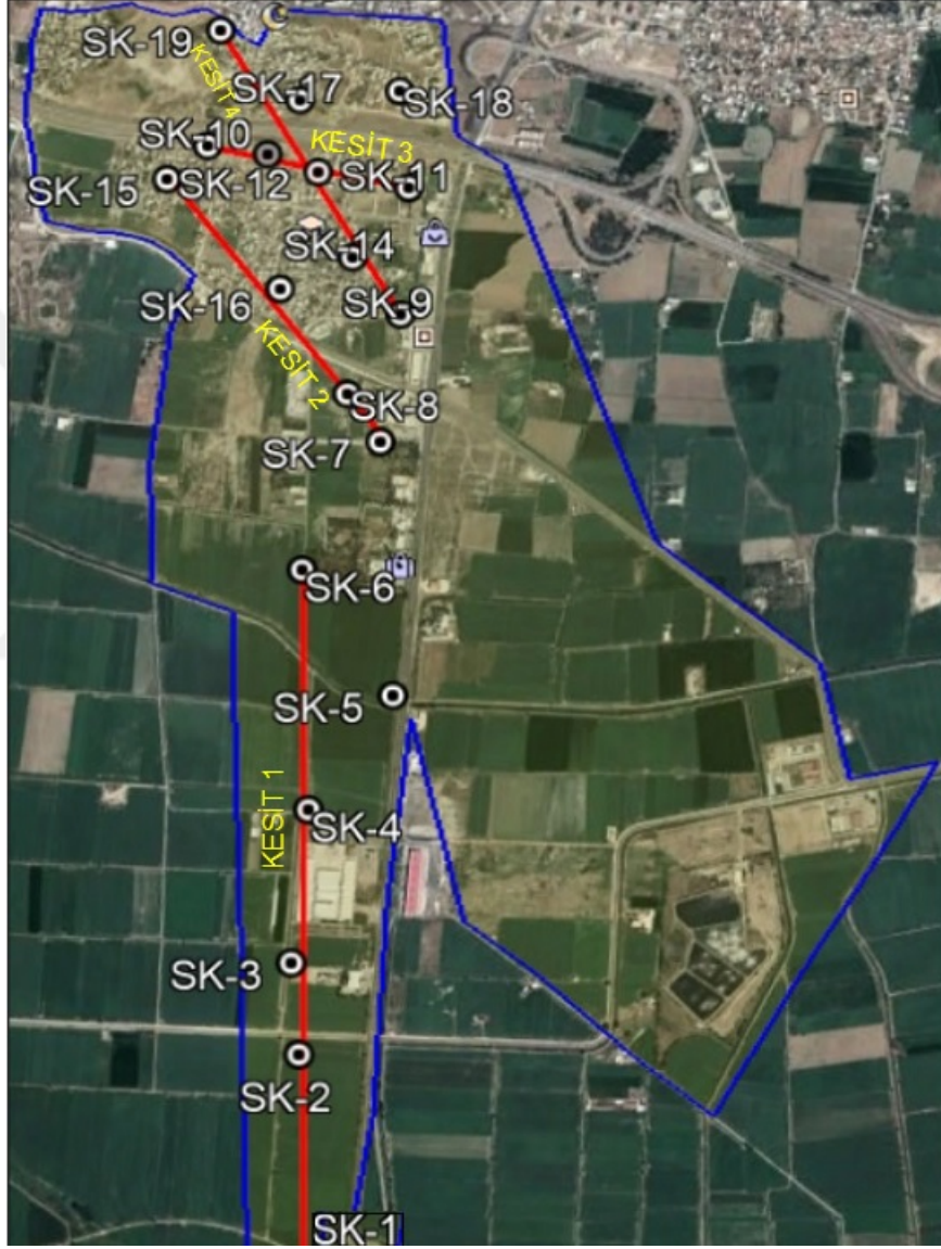
Şekil 57. SPT değerleri için sondaj noktalarından alınan kesitler
