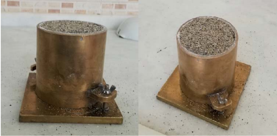
Şekil 2.5. Minimum boşluk oranının belirlenmesi
