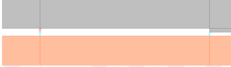
Şekil 2.54. Baraj-zemin ara yüzündeki çatlak ve boşluk elemanlar
