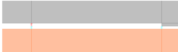
Şekil 2.42. Çatlaklı sonlu eleman modellerinde baraj-zemin ara yüzündeki karşılıklı düğüm noktalarına boşluk elemanı tanımlanması
