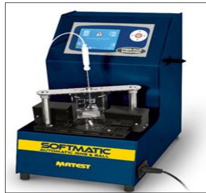
Şekil 18. Yumuşama noktası deney düzeneği (URL-11, 2019)
