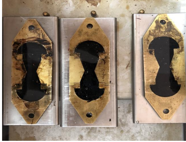
Şekil 35. Su Banyosunda Bekletilen Düktilite Numuneleri
