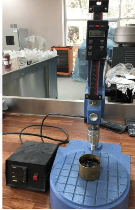
Şekil 33. Penetrasyon deneyinin yapılması
