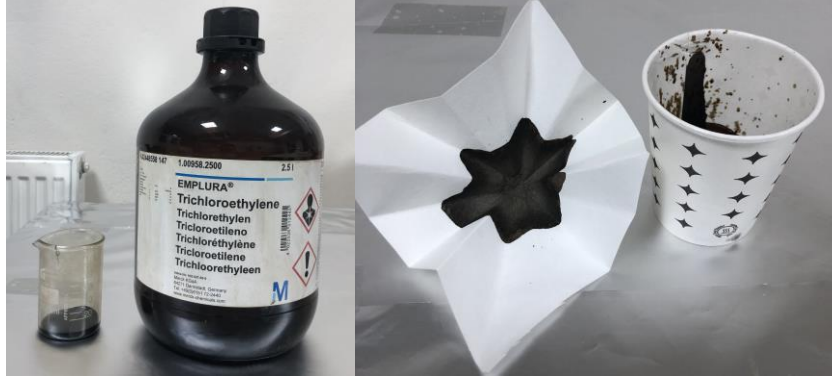
Şekil 39. Modifiye bitümün trikloretilende çözünmesi
