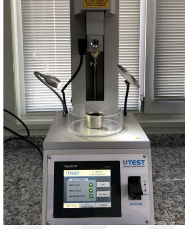
Şekil 17. Penetrasyon deney düzeneği (URL-10, 2019)
