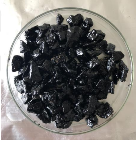
Şekil 38. Nicholson Soyulma Deneyi numunesi
