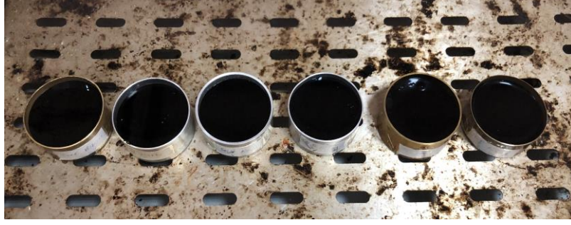
Şekil 32. Bitümün su banyosunda 25°C sıcaklıkta bekletilmesi
