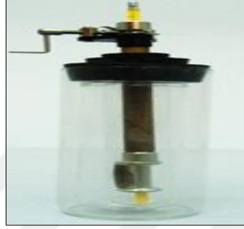
Şekil 20. Frass kırılma noktası deney düzeneği (URL-12, 2019)
