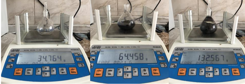
Şekil 40. Piktometre yöntemi ile tartım
