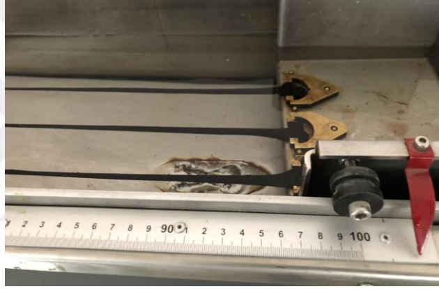
Şekil 36. Düktilite Değerlerinin Ölçülmesi
