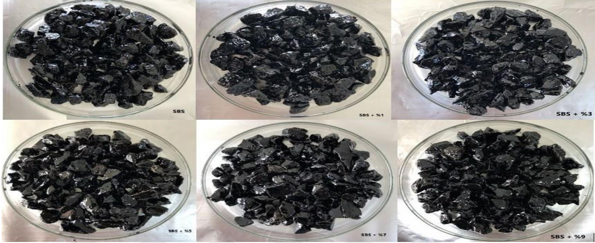
Şekil 52. Soyulma deneyi numuneleri görüntüleri
