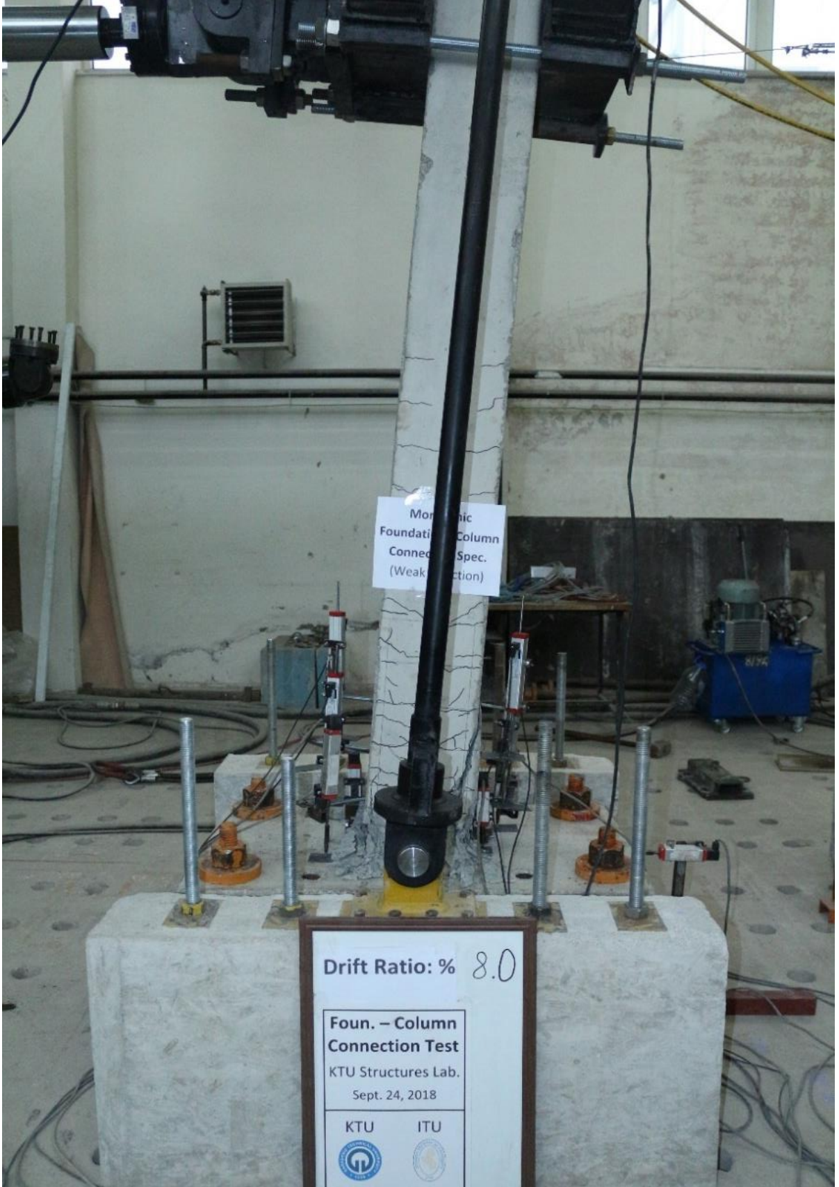
Şekil 108. Monolitik zayıf eksen temel – kolon birleşim numunesinin deneyin son adımındaki görünüşü (%8 görece ötelenme oranı)
