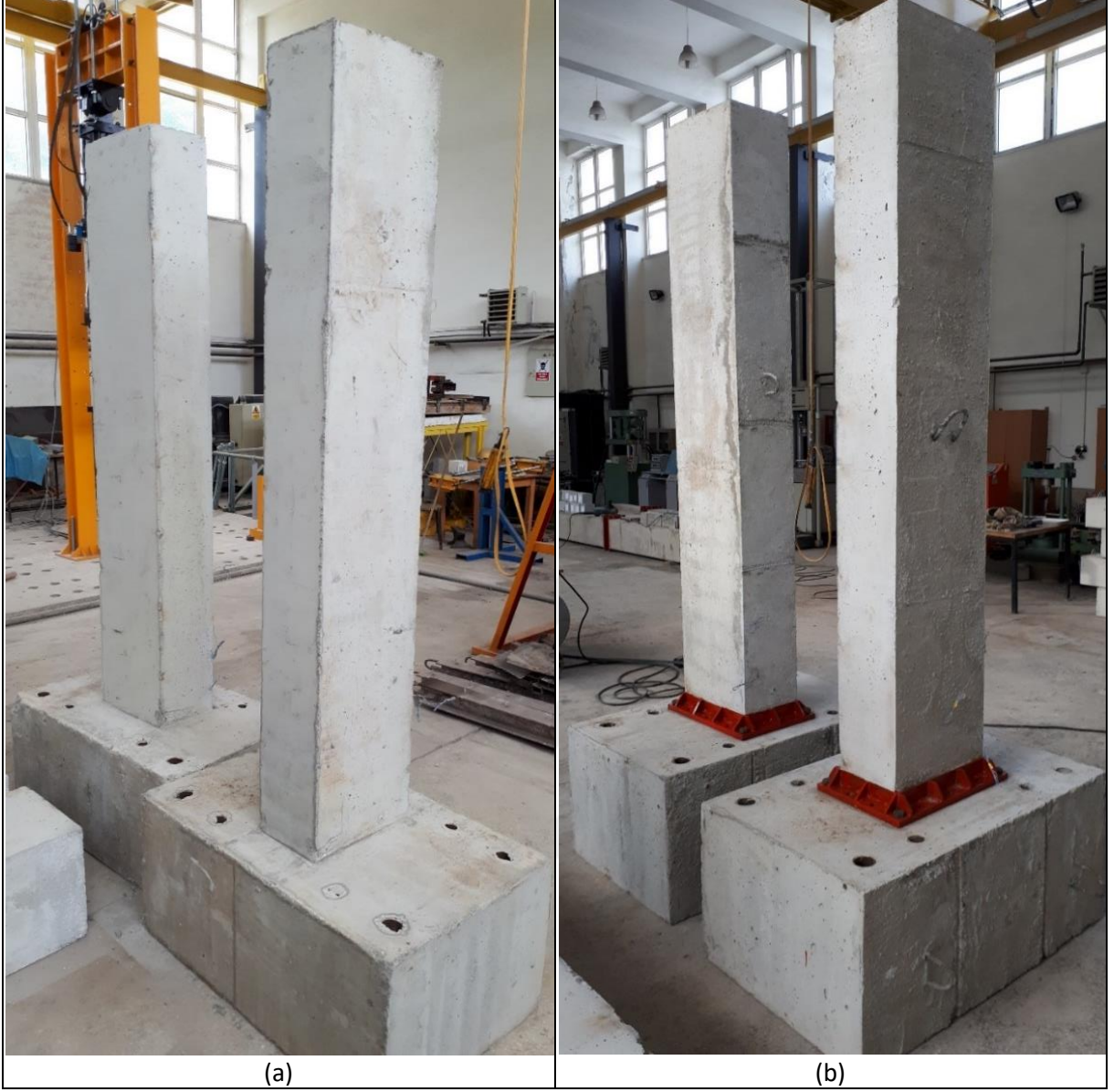
Şekil 53. Deney numuneleri görünüşleri; (a) monolitik numuneler, (b) prekast numuneler
