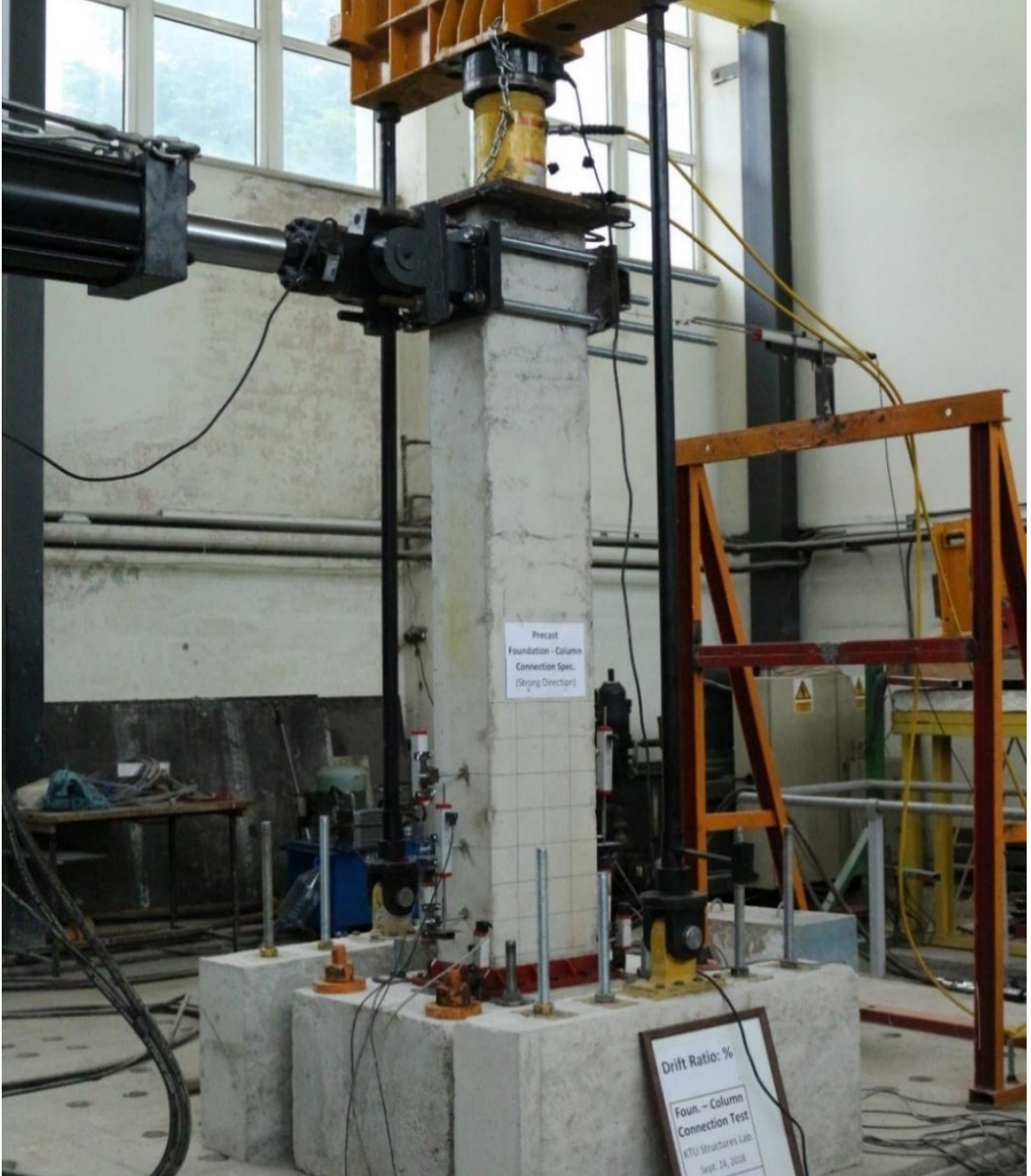
Şekil 102. Prekast kuvvetli eksen temel – kolon birleşim numunesi deney öncesi görünüşü
