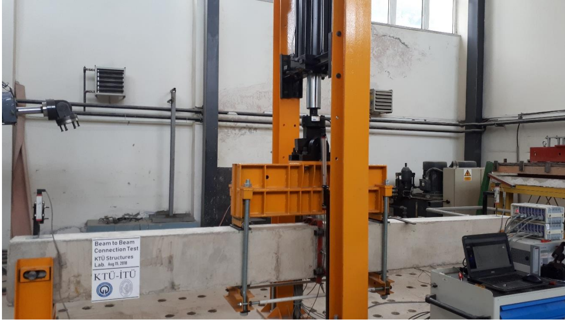
Şekil 158. Açıklığı 4.0 m olan prekast kiriş – kiriş birleşim numunesi deney öncesi görünüşü
