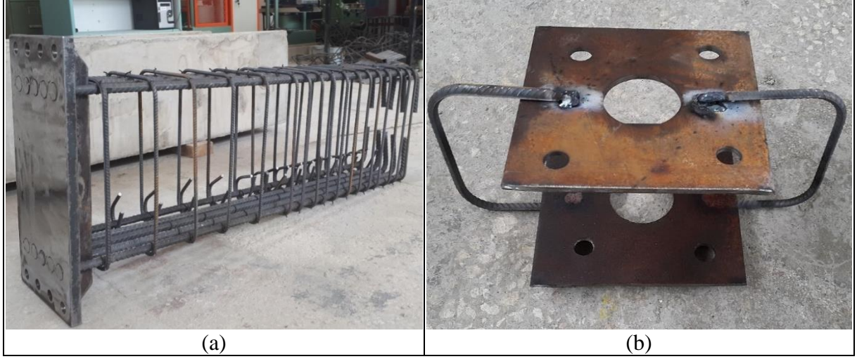
Şekil 70. Kiriş-kiriş birleşimi deney numunesi (a) donatı iskeleti (b) ek mesnet levhaları
