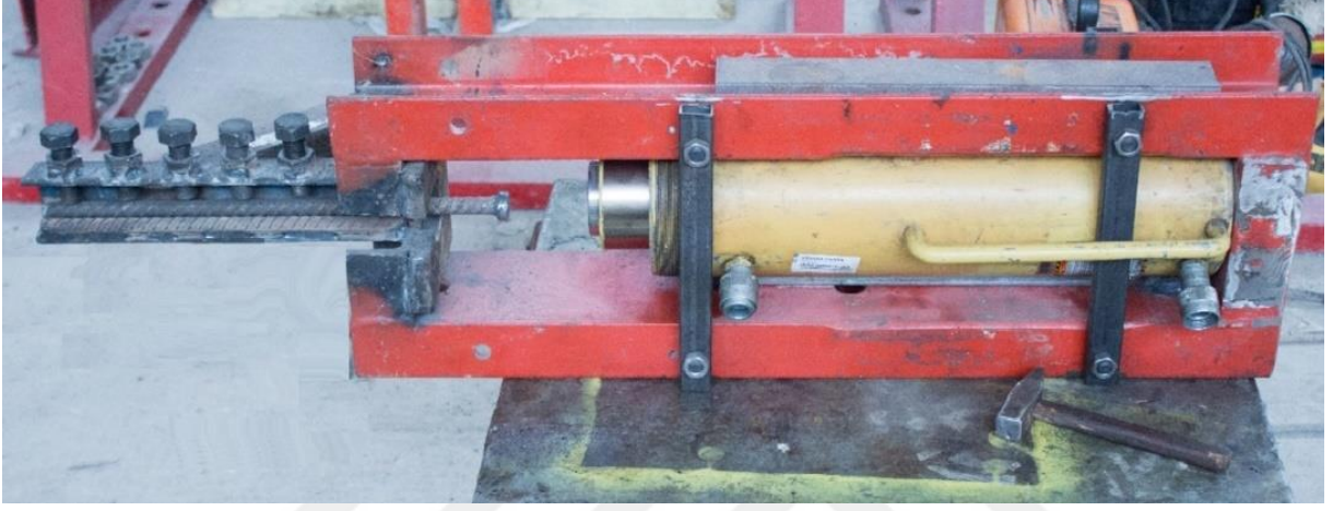
Şekil 35. Perçin başlı donatı üretimi için tasarlanıp imal edilen hidrolik yükleme aparatı
