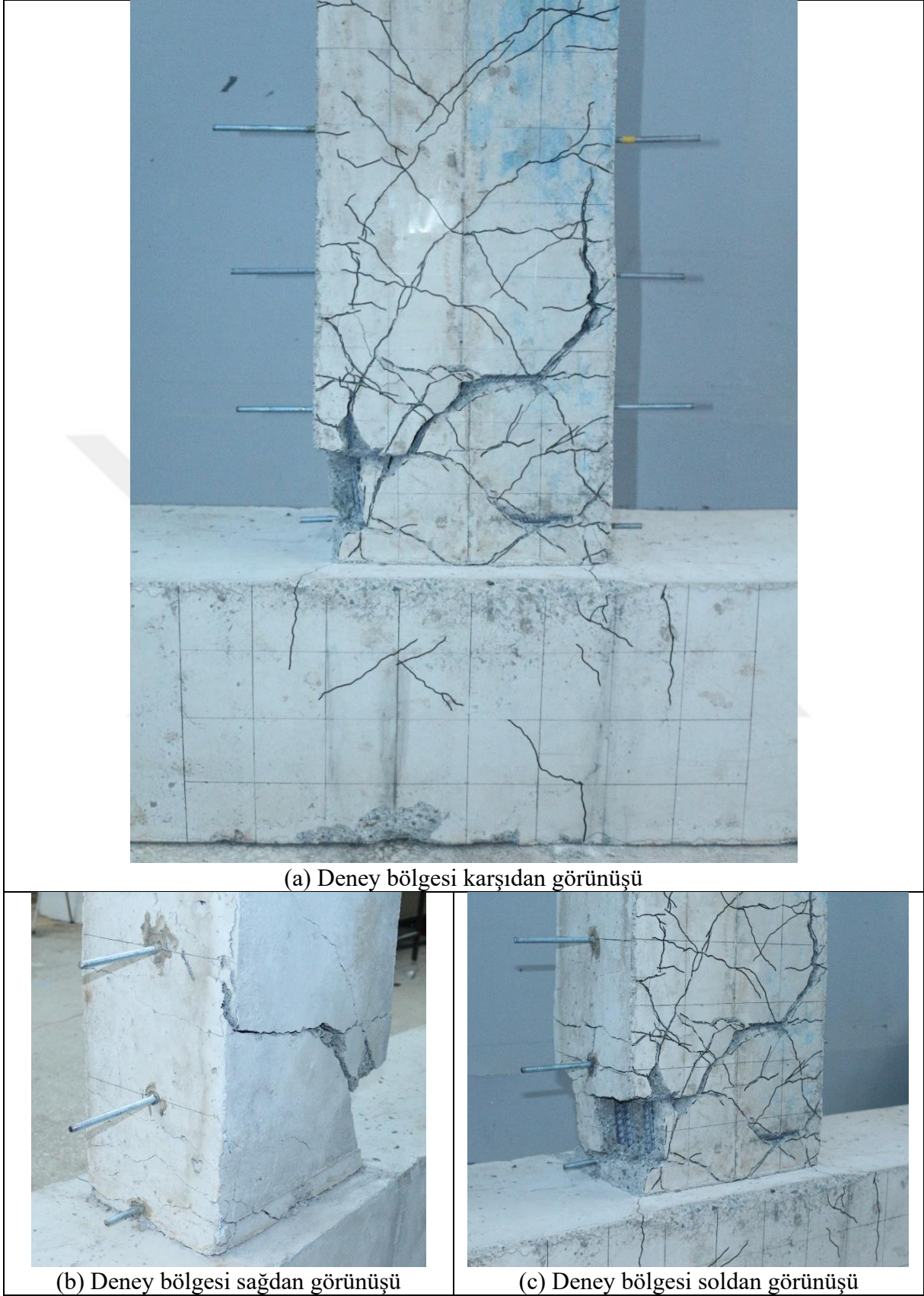
Şekil 128. Kiriş boyu 1.0 m olan monolitik kolon – kiriş birleşim numunesi deney sonrası yakın görünüşleri
