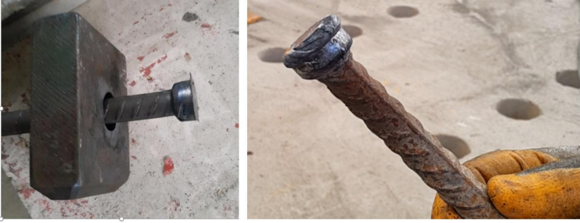
Şekil 38. Ucu perçin başı şekline getirilen nervürlü donatı
