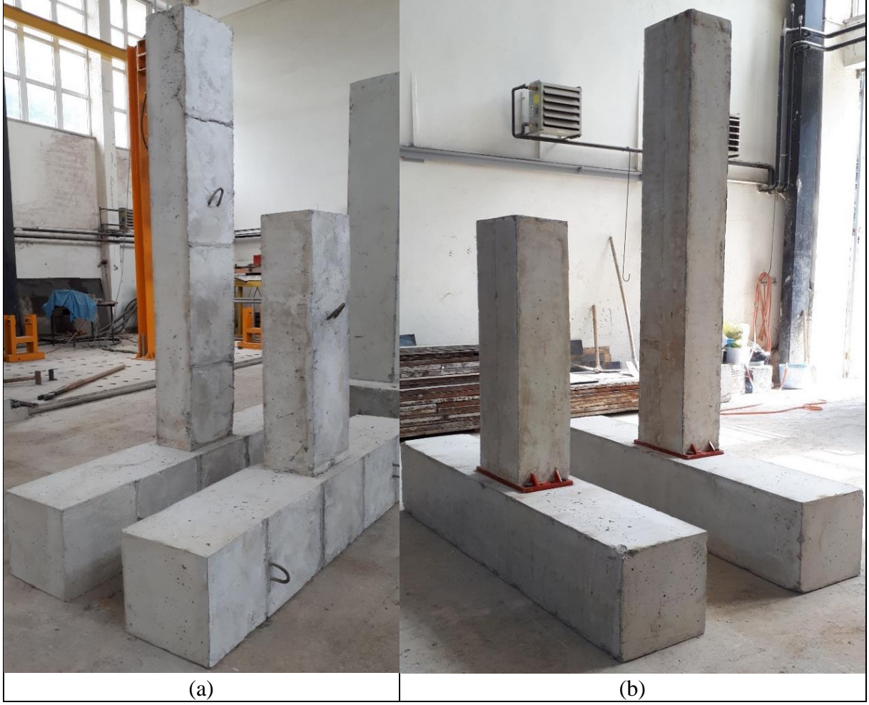
Şekil 65. Deney numuneleri görünüşleri; (a) monolitik numuneler, (b) prekast numuneler
