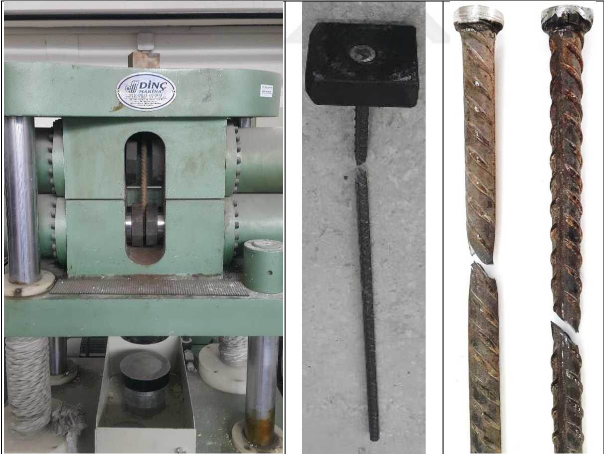
Şekil 39. Perçin başlı donatıya çekme deneyi uygulanışı ve donatının kopma şekli
