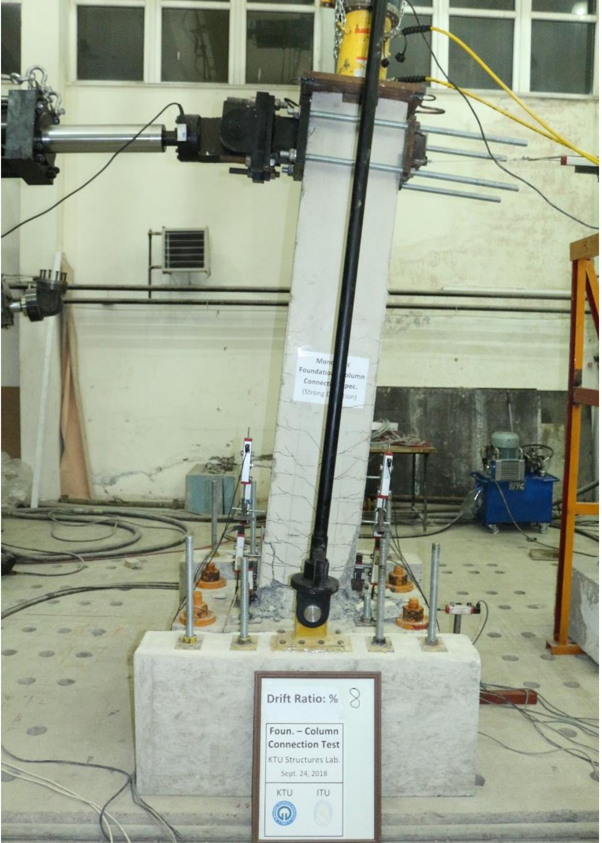
Şekil 100. Monolitik kuvvetli eksen temel – kolon birleşim numunesinin deneyin son adımındaki görünüşü (%8 görelî ötelenme oranı)
