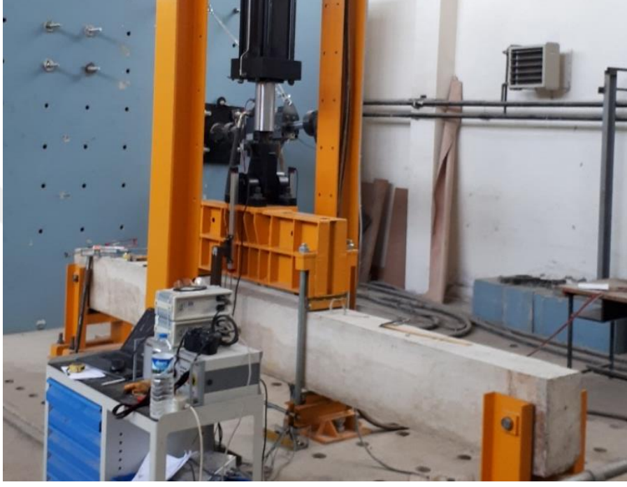
Şekil 156. Açıklığı 4.0 m olan monolitik kiriş – kiriş birleşim numunesi deney öncesi görünüşü
