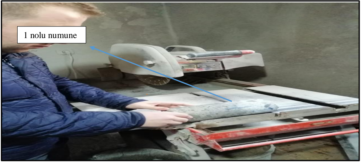
Şekil 4.42. Karot başlık düzeltme işlemi yapılması
