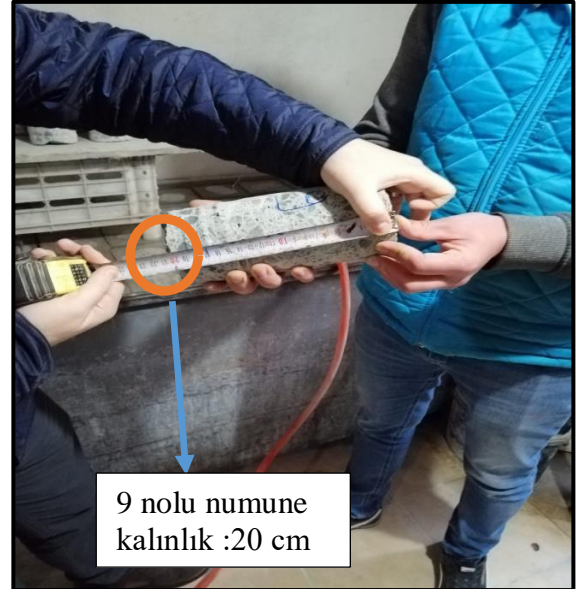
Şekil 2.41. Beton karot numunelerinin kalınlıklarının ölçülmesi
