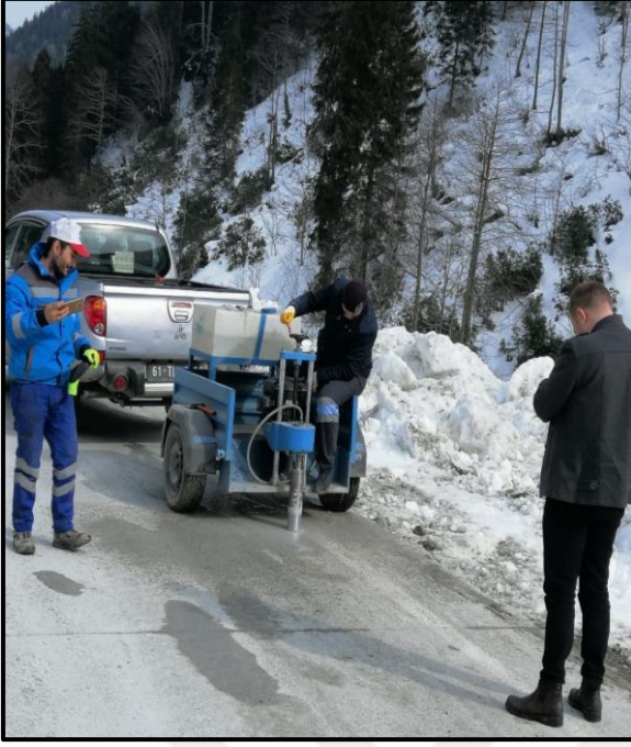
Şekil 2.24. 4+200 mt. den alınan beton karot numunesi( Kalınçam-Erikbeli beton yolu)
