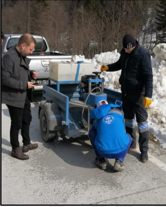
Şekil 2.22. 1+700 mt. den alınan beton karot numunesi ( Kalınçam-Erikbeli beton yolu)
