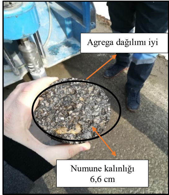
Şekil 2.7. Karot 1+950 – 830 mt. rakımda alınan asfalt karot numunesi görünümler
