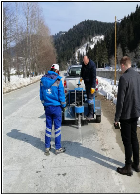
Şekil 2.15. 9+100 km alınan karot örneği (Çayırıcı Köprü-Kılınçam arası beton yol)
