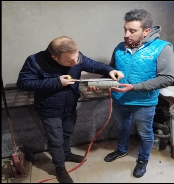
Şekil 2.41. Beton karot numunelerinin kalınlıklarının ölçülmesi
