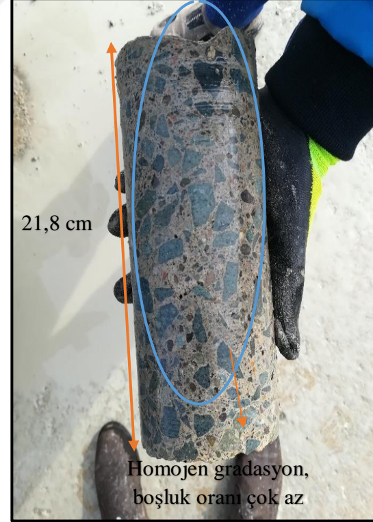
Şekil 2.17. 4+500 km alınan karot örneği (Çayırıçi Köprü-Kalınçam arası beton yol)
