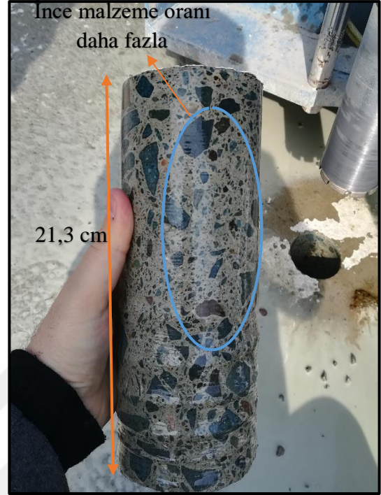
Şekil 2.16. 6+000 km alınan karot örneği (Çayırıçi Köprü-Kalınçam arası beton yol)
