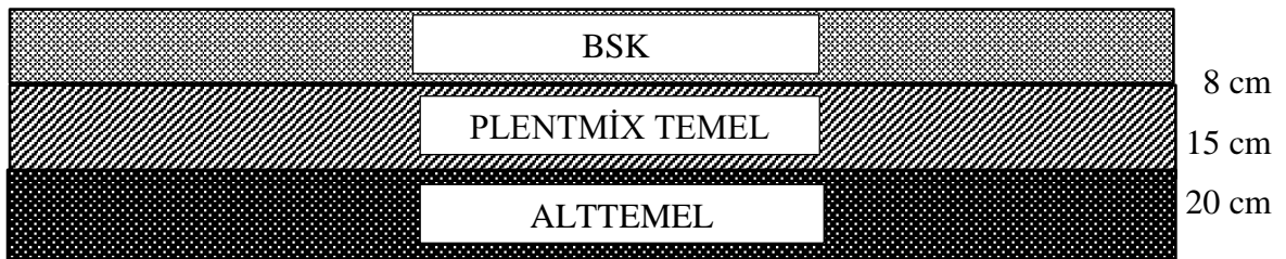
Şekil 3.5. Trabzonda genel olarak uygulanan asfalt kaplamalı yolların tabaka kalınlıkları
