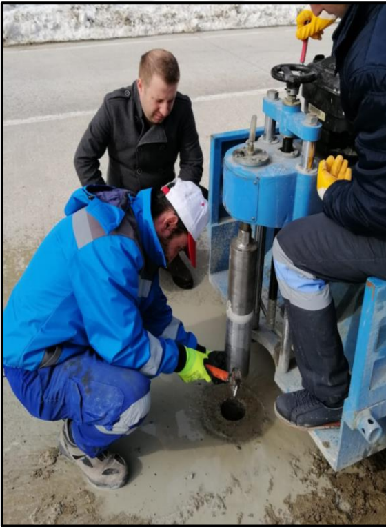
Şekil 2.17. 4+500 km alınan karot örneği (Çayırıçi Köprü-Kalınçam arası beton yol)
