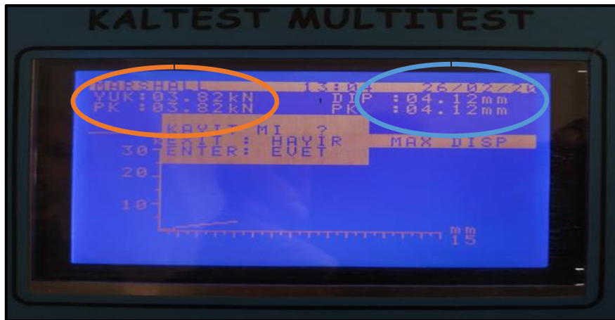
Şekil 2.51. 3 nolu asfalt numunesi maksimum yük ve akma ölçümü
