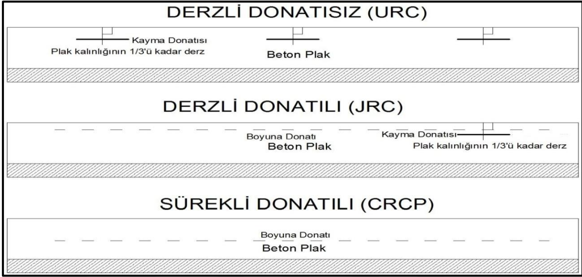
Şekil 1.3. Beton yol kaplama tiplerinin boy kesitleri [10].
