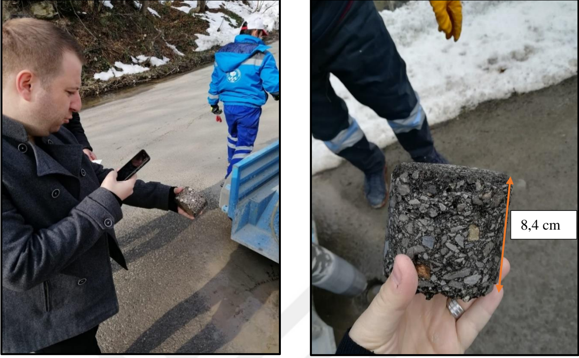
Şekil 2.8. Karot 3+150 – 848 mt. rakımda alınan asfalt karot numunesi görünümüler
