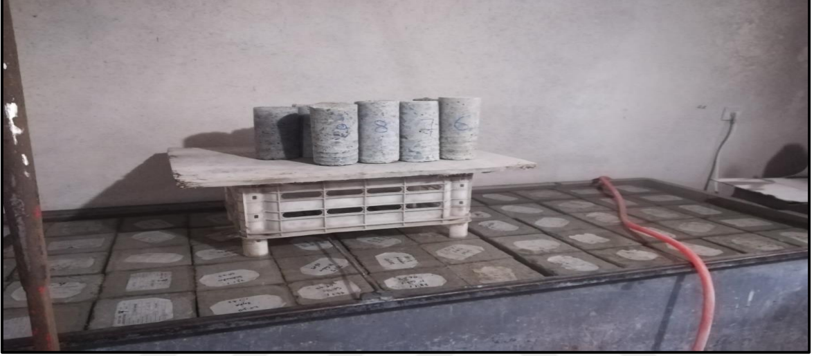
Şekil 2.40. Alınan tüm beton karot numuneleri Erikbeli yaylası-Tonya istikametine doğru artacak şekilde numaralandırılmıştır
