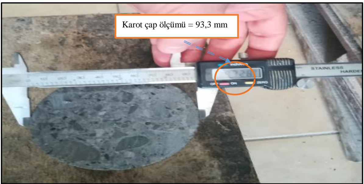
Şekil 2.43. Kompasla karot çap ölçümü
