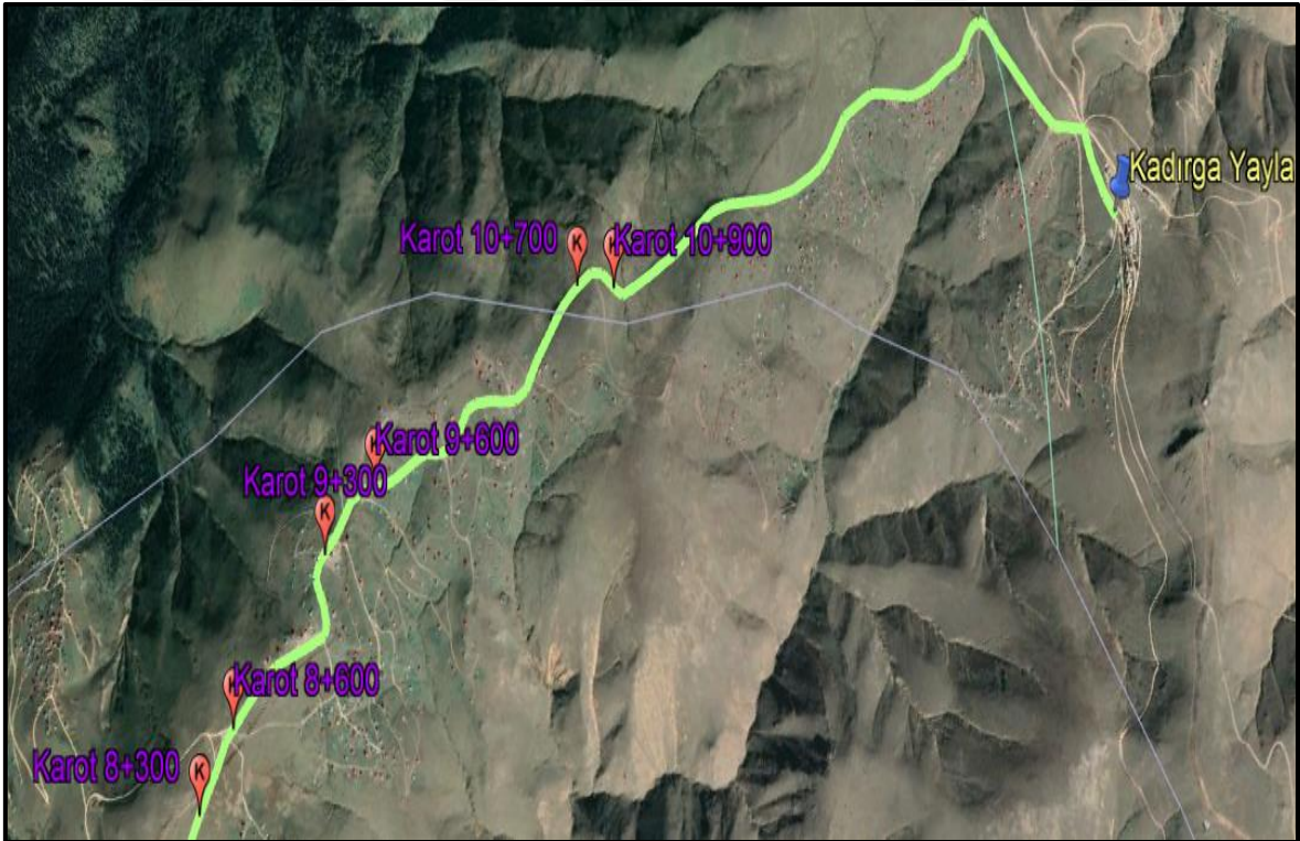
Şekil 2.31. Erikbeli - Kadırğa yayla arası beton yol hattı boyunca karot alınan noktalar
