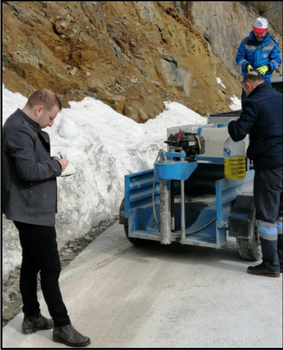
Şekil 2.25. 5+900 mt. den alınan beton karot numunesi ( Kalınçam-Erikbeli beton yolu)
