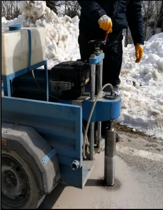
Şekil 2.21. 0+300 mt. den alınan beton karot numunesi ( Kalınçam-Erikbeli beton yolu)
