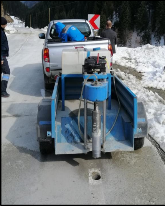
Şekil 2.23. 2+900 mt. den alınan beton karot numunesi ( Kalınçam-Erikbeli beton yolu)
