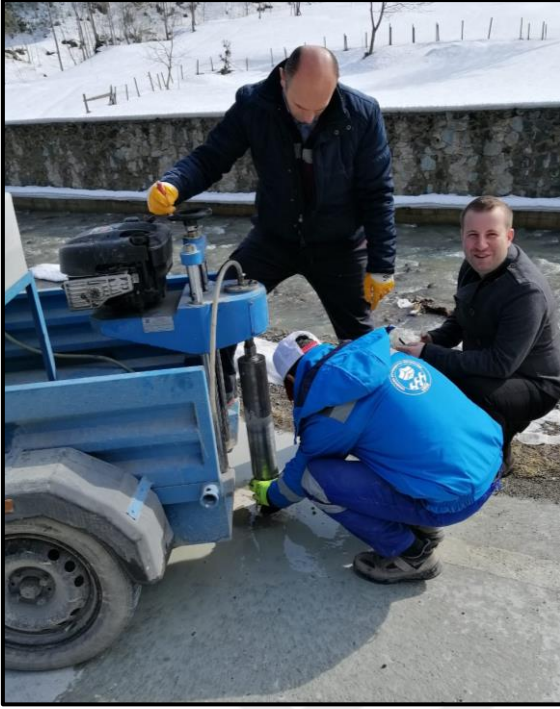
Şekil 2.16. 6+000 km alınan karot örneği (Çayırıçi Köprü-Kalınçam arası beton yol)
