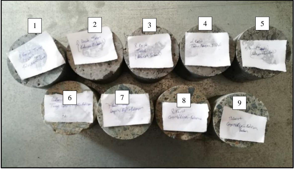
Şekil 2.45. Başlıklama işlemi yapılan tüm beton numuneleri hazırlandı ve numaralandırıldı
