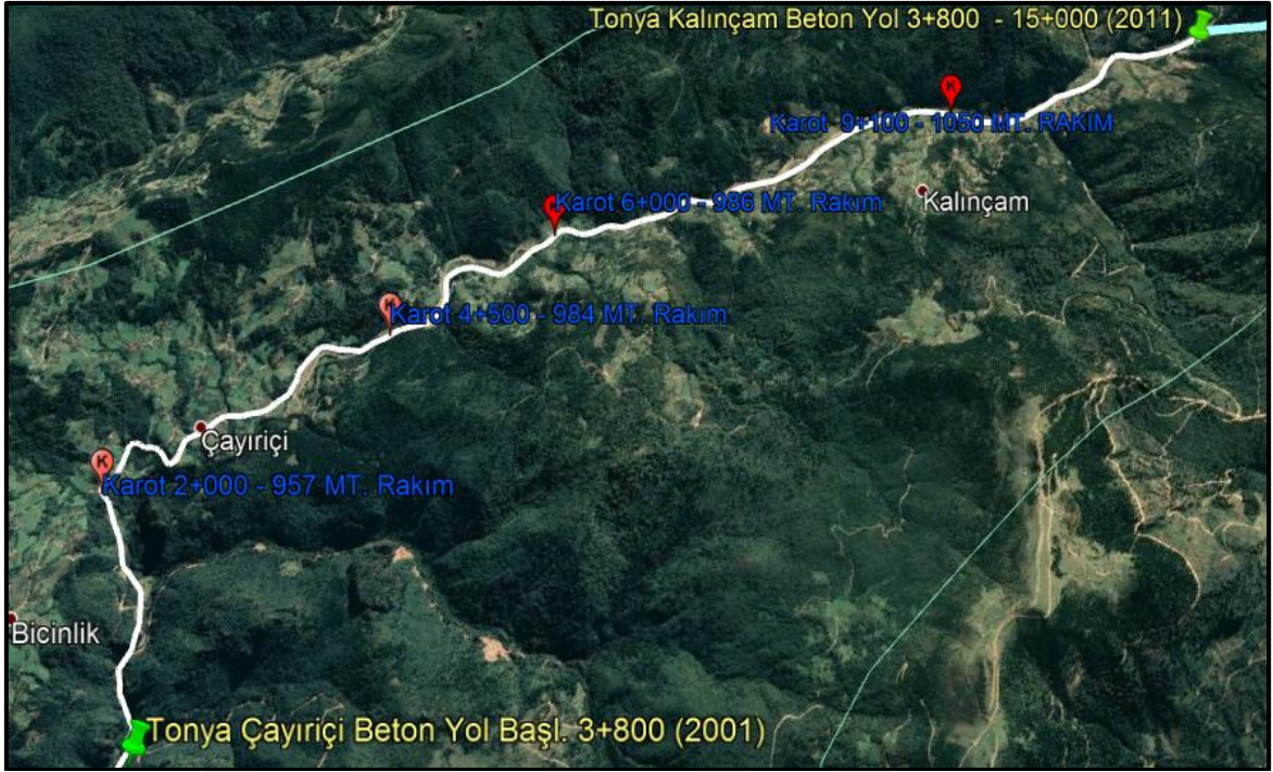
Şekil 2.14 Çayırıcı Köprü-Kılınçam (11,2 km) arası beton yoldan karot alınan noktalar
