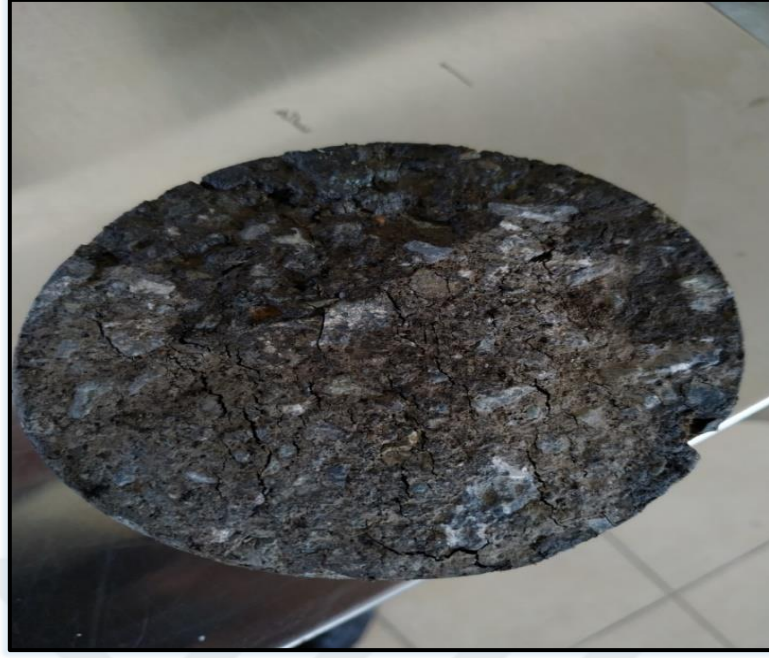
Şekil 3.3. Marshall test cihazından sonra 3 nolu numunede deformasyonlar oluştu
