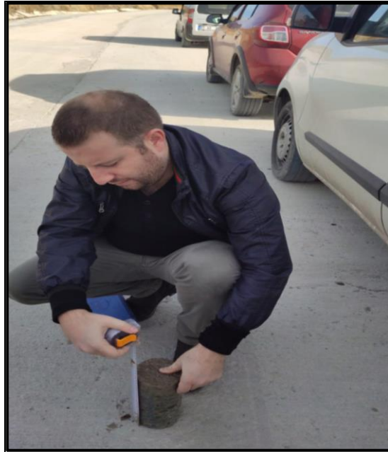
Şekil 2.33. Erikbeli Kadırğa 8+600 karot numuneleri ve ölçümleri
