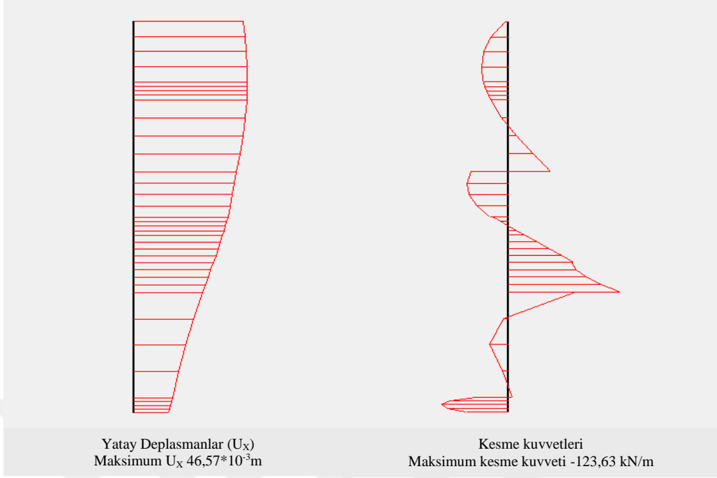
Şekil 2.11. Tek sıra ankrajlı iksanın kesitinde fore kazıkta meydana gelen yatay deplasman ve kesme kuvveti grafiği
