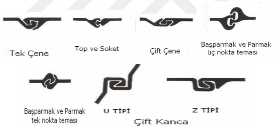
Şekil 1. 14. En çok tercih edilen çelik palplanş perde birleşim detayları
