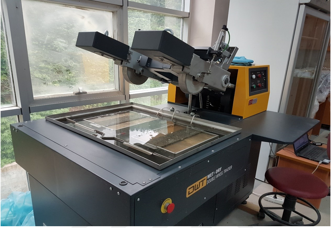
Şekil 17. Hamburg tekerlek izi deney cihazı
