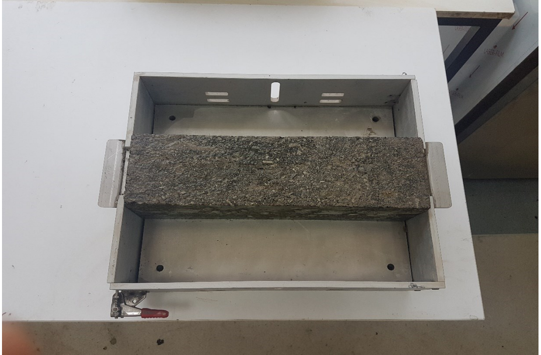
Şekil 16. HWT cihazına yerleştirilen 10x36 cm boyutunda örnek
