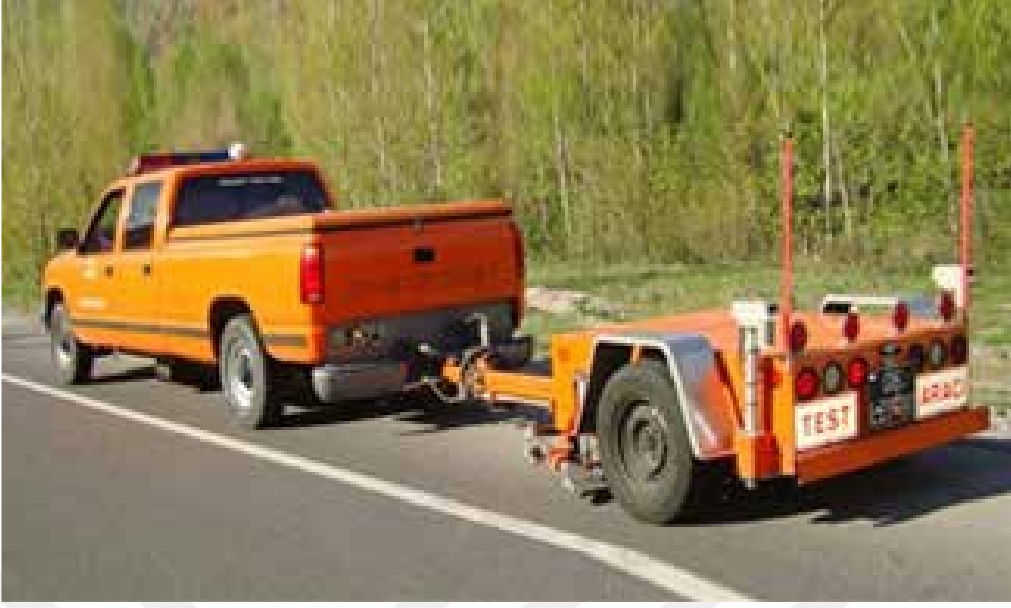
Şekil 11. KGM sürtünme ölçüm cihazı (KGM faaliyet raporu, 2019).
