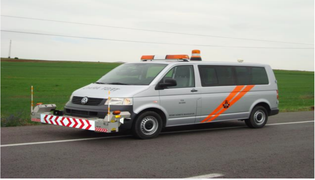
Şekil 9. KGM profilometre ölçüm cihazı (KGM faaliyet raporu, 2019)
