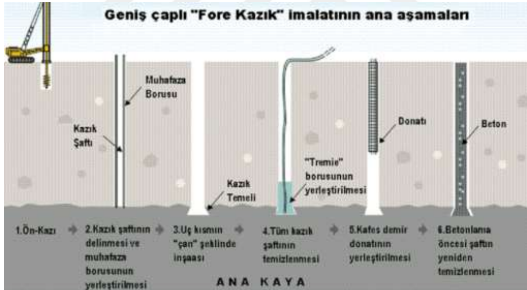
Şekil 1.36. Yerde dökme betonarme kazık imalatı
