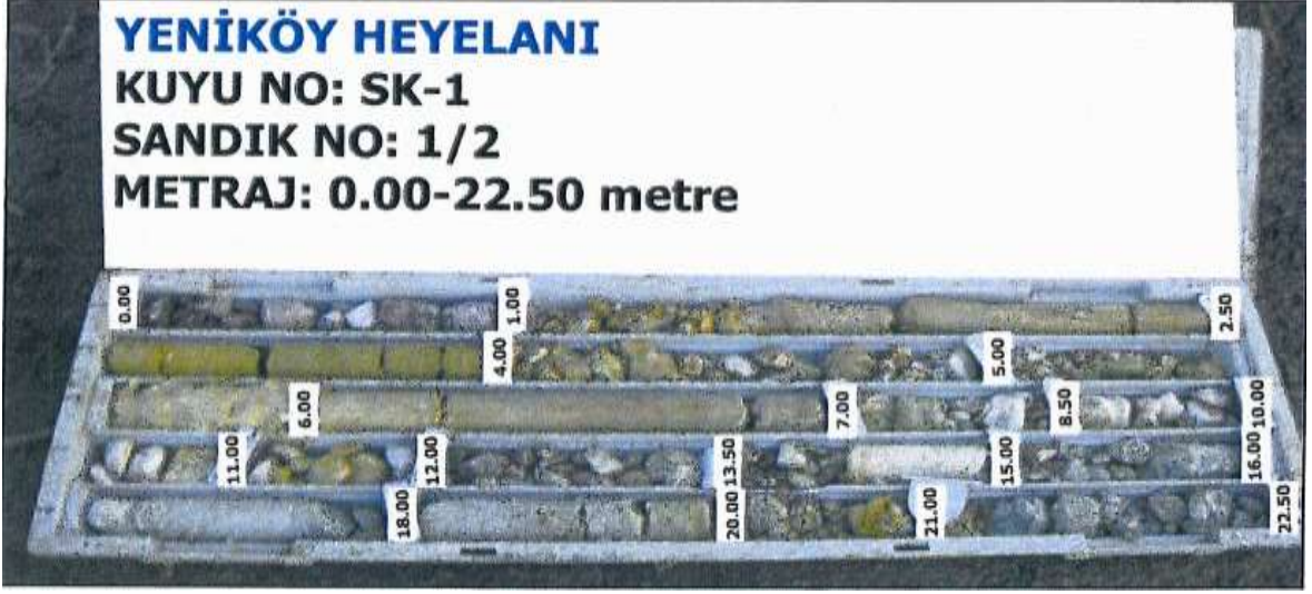
Şekil 2.2. SK-1 / 0.00-22.50 m'leri arası görünüm
