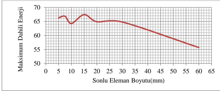
Şekil 3.20. Maksimum dahili enerjinin farklı sonlu eleman boyutlarına göre değişimi.
