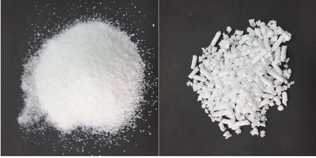
Şekil 28. SBS katkı maddeleri (a) Kraton D1192 ESM, (b) Europrene SOL T 6302
