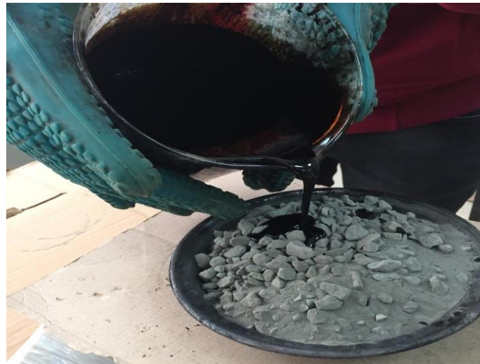
Şekil 37. Gradasyona göre hazırlanan agregaya bitümün ilave edilmesi
