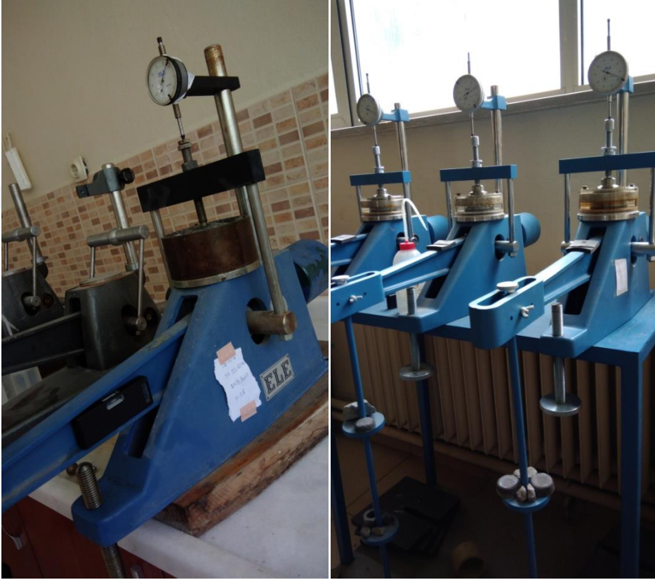
Şekil 44. Ödometre aleti ile şişme potansiyelinin belirlenmesi
