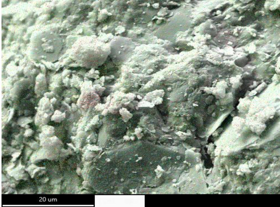
Ek Şekil 4. 14. ZKD10 zemin karışımının SEM görüntüsü ile EDS elementel haritalaması
