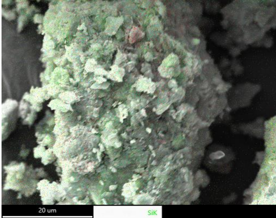
Ek Şekil 4. 10. ZK zemin karışımının SEM görüntüsü ile EDS elementsel haritalaması
