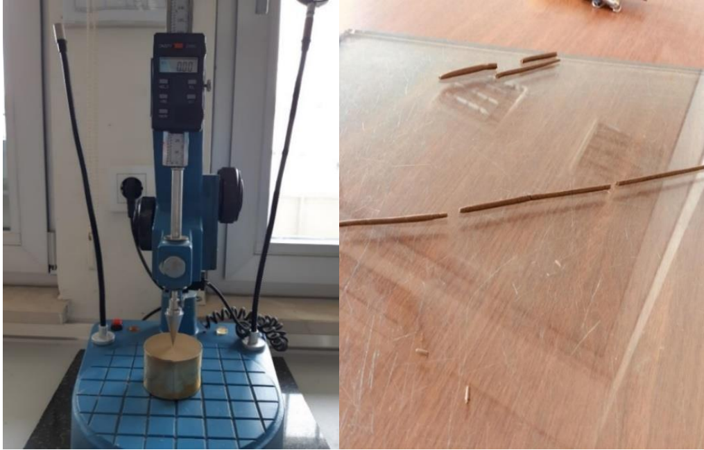
Şekil 2.8. Koni düşürme ve plastik limit deneyi
