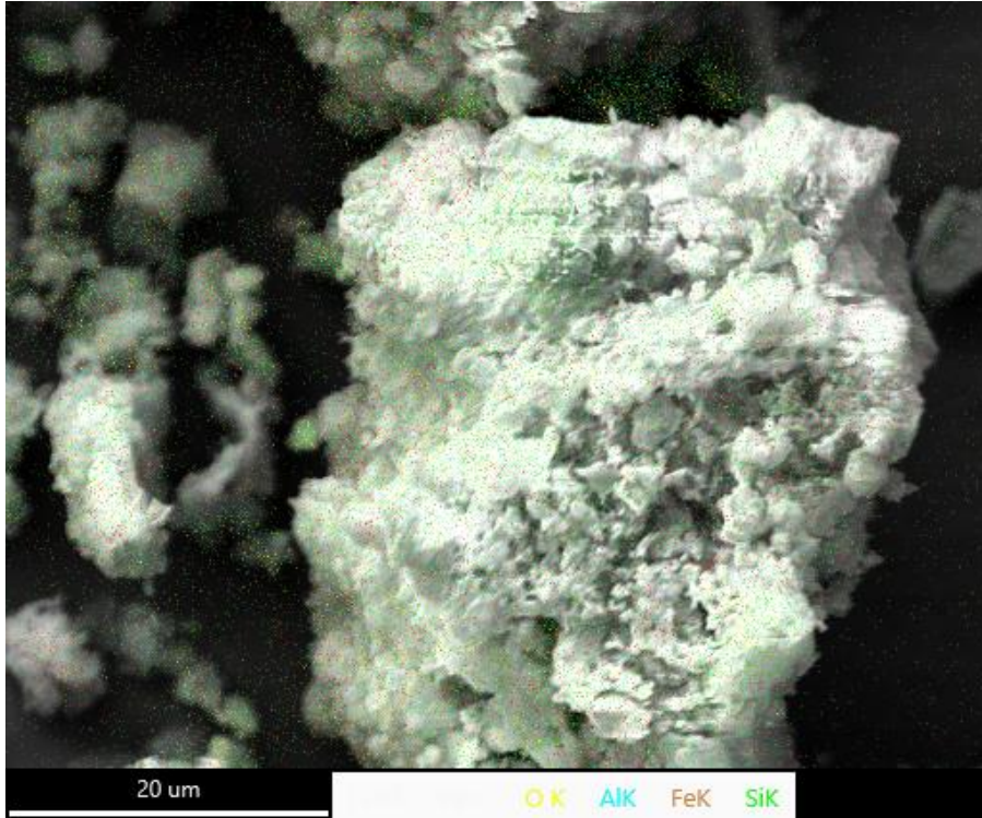
Ek Şekil 4. 12.ZKD5 zemin karışımının SEM görüntüsü ile EDS elementsel haritalaması
