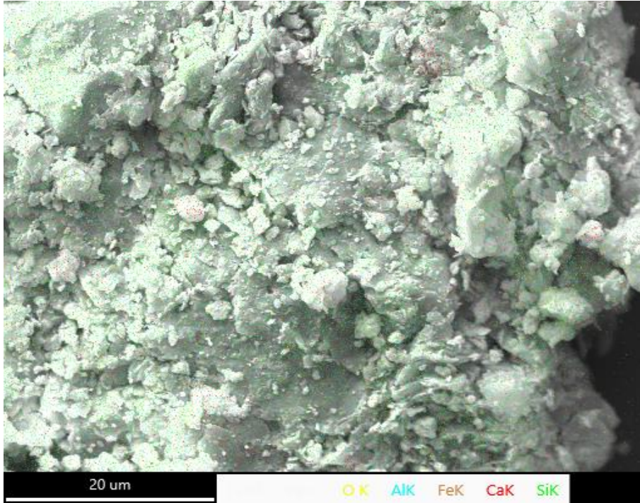
Ek Şekil 4. 4. ZD5 zemin karışımının SEM görüntüsü ile EDS elementsel haritalaması
