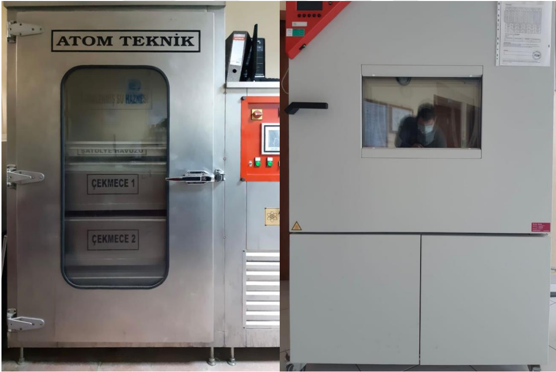
Şekil 2.26. İklimlendirme ve nem dolapları
