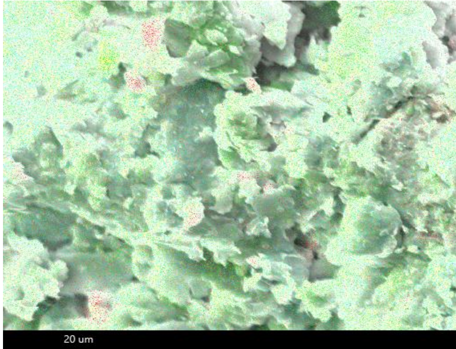
Ek Şekil 4. 2. Doğal zeminin SEM görüntüsü ile EDS elementsel haritalaması
